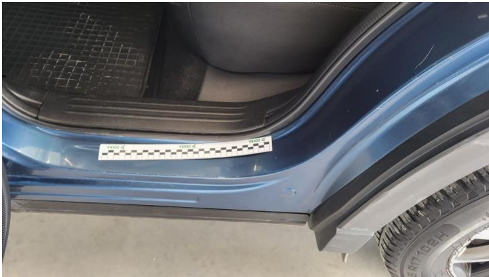
Photo 87. Próg L - Rysa/odprysk 1
