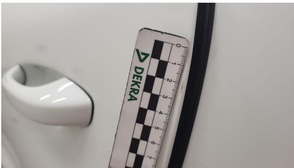
Photo 65. Drzwi tylne L - Rysa/odprysk 1
