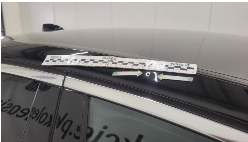
Photo 51. Stupek przedni P - Wgniecenie/odkształcenie 1
