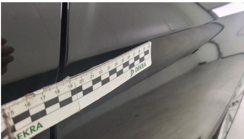
Photo 63. Drzwi tylne L - Rysa/odprysk 1
