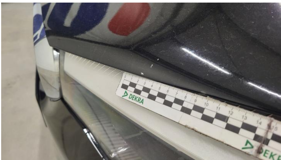
Photo 38. Pokrywa komory silnika - Rysa/odprysk 1
