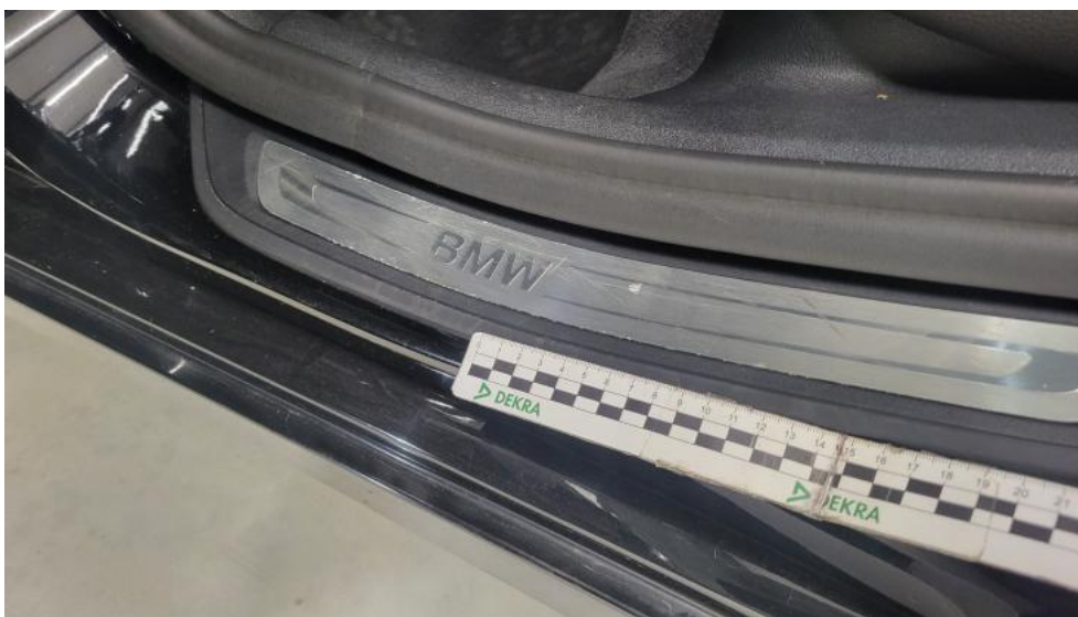
Photo 65. Próg L - Rysa/odprysk 1
