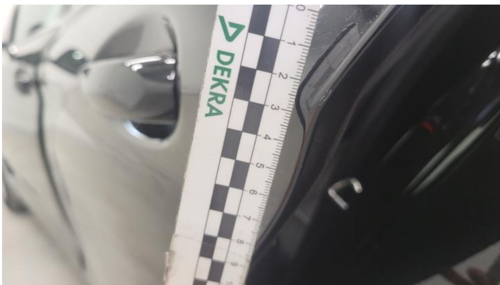
Photo 64. Drzwi tylne L - Rysa/odprysk 2
