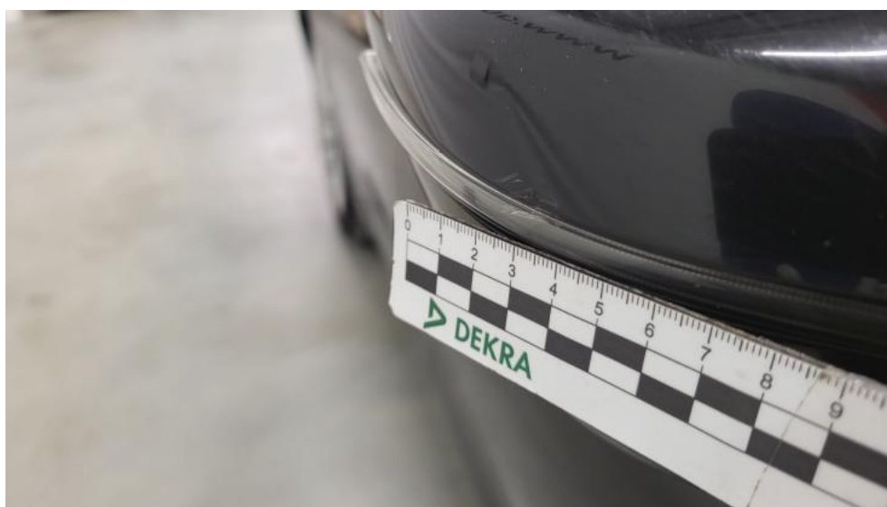
Photo 48. Lusterko zew P - Rysa/odprysk 1
