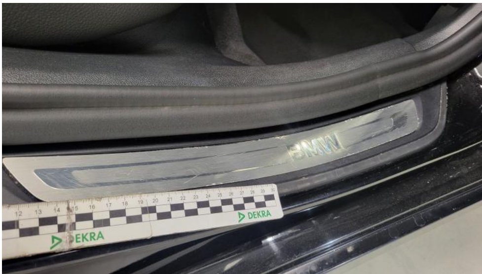
Photo 49. Próg P - Rysa/odprysk 1
