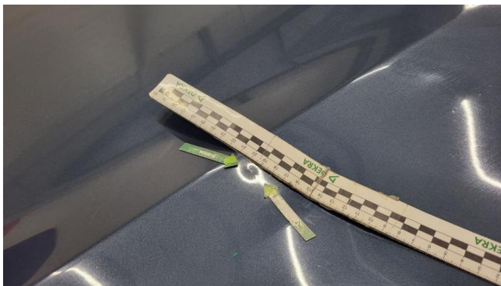
Fot. 43. Pokrywa komory silnika - Wgniecenie/odkształcenie 1
