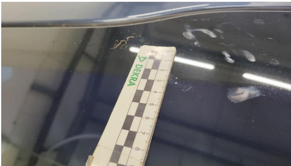
Fot. 45. Szyba czołowa - Rysa/odprysk 1
