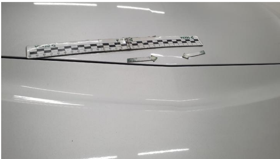
Photo 33. Pokrywa komory silnika - Wgniecenie/odkształcenie 1
