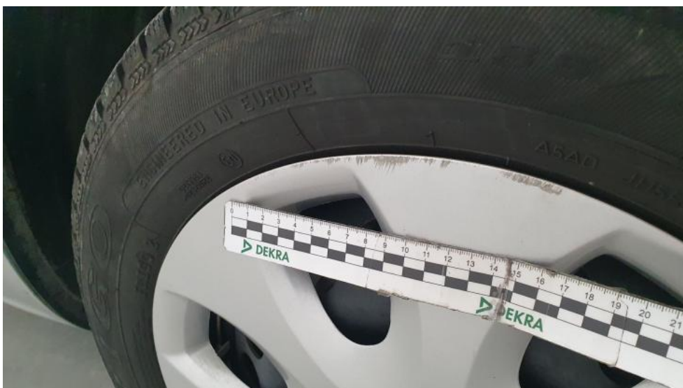
Photo 36. Kołpak przedni P - Rysa/odprysk 1
