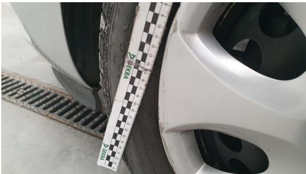
Photo 45. Kołpak przedni L - Rysa/odprysk 1
