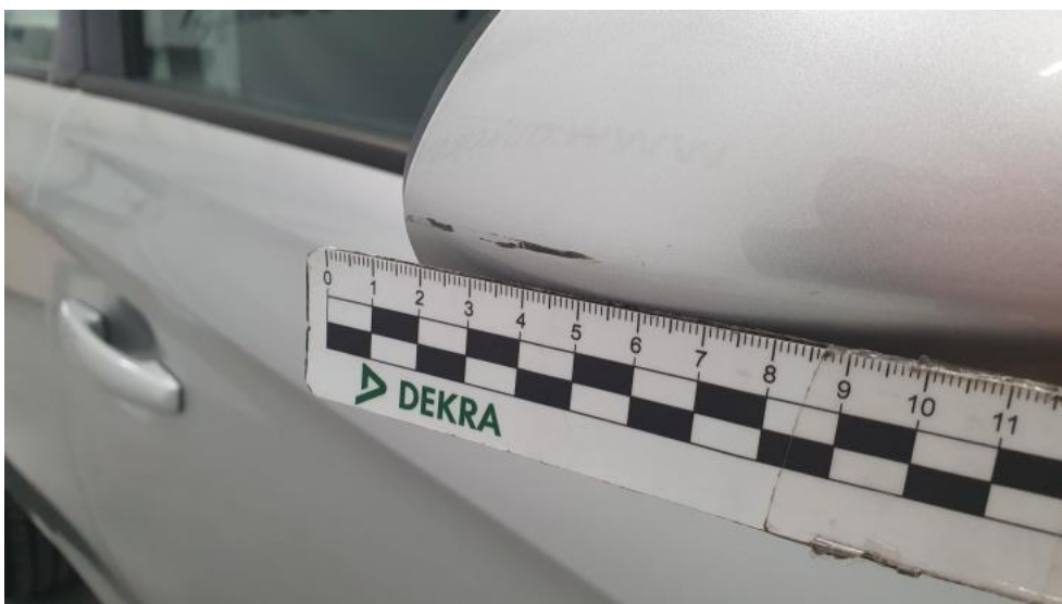
Photo 38. Lusterko zew P - Rysa/odprysk 1
