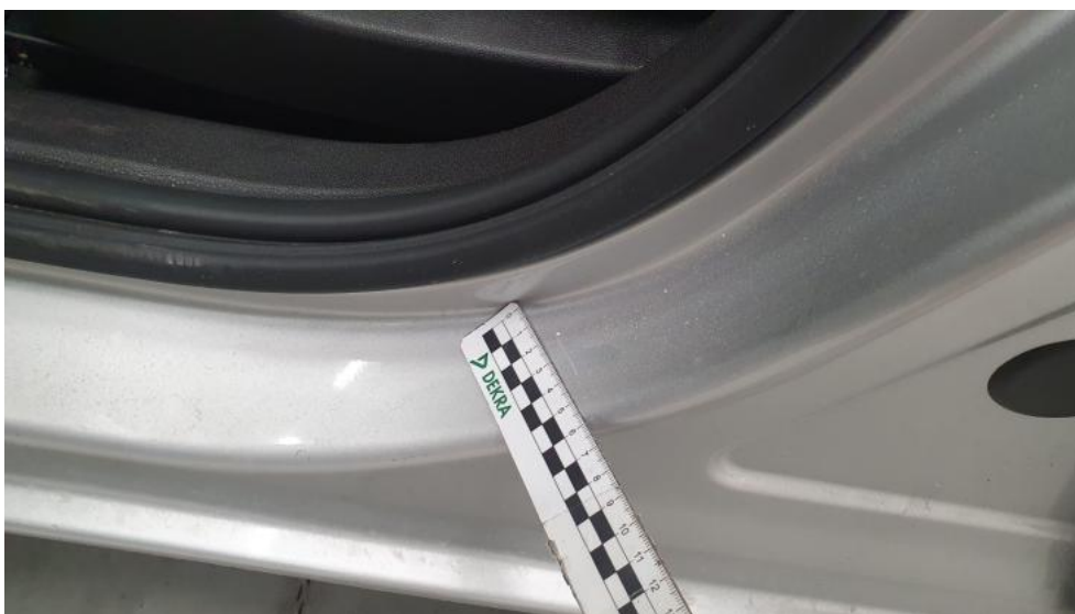
Photo 42. Próg L - Rysa/odprysk 1
