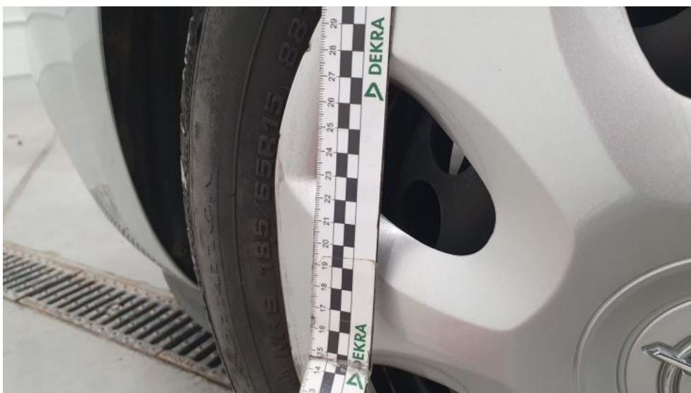
Photo 46. Kołpak przedni L - Wgniecenie/odkształcenie 1
