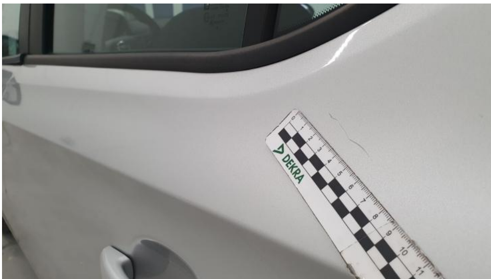
Photo 41. Drzwi tylne L - Rysa/odprysk 1
