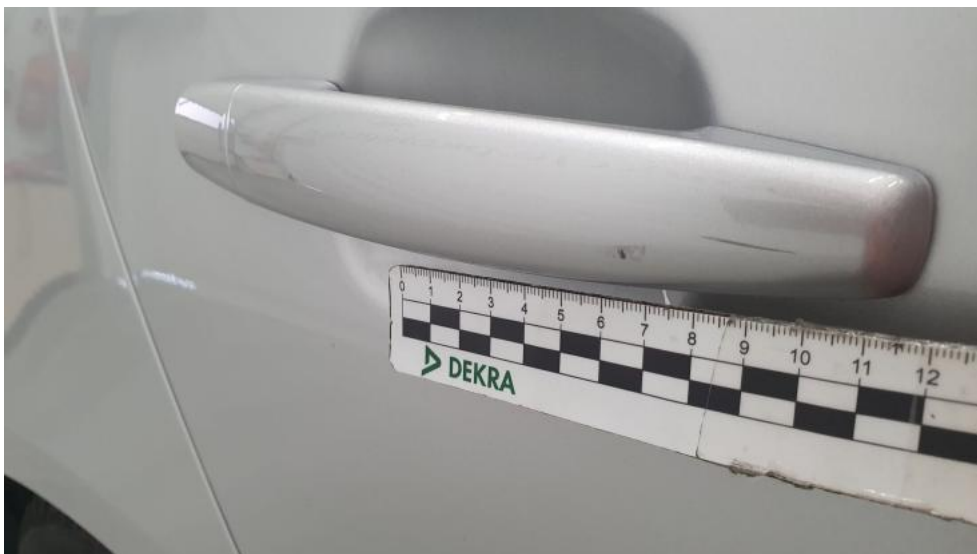
Photo 37. Klamka drzwi tyl P - Rysa/odprysk 1
