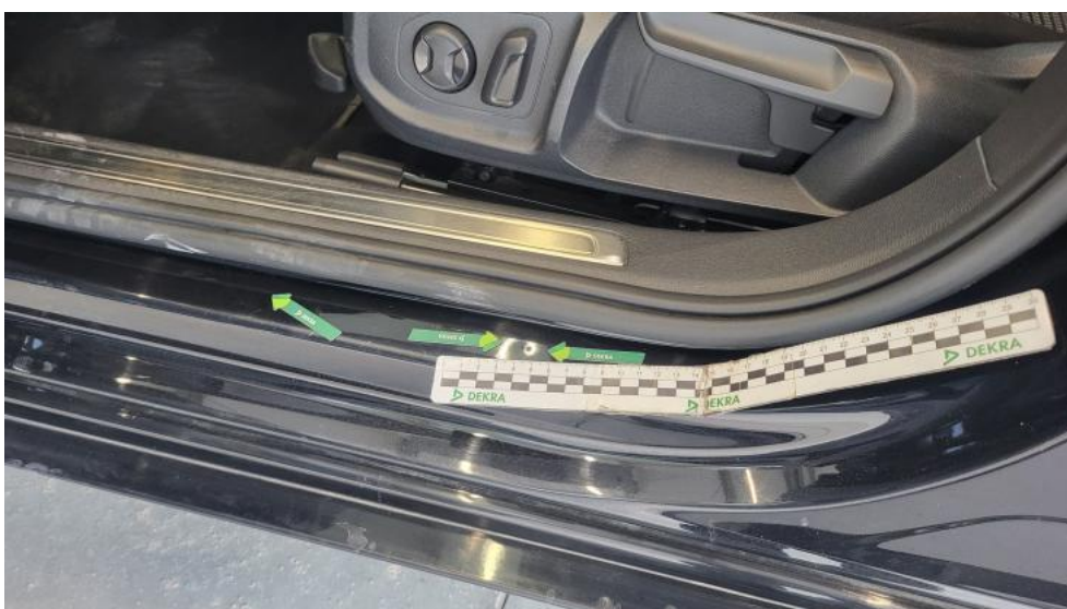
Fot. 62. Próg L - Wgniecenie/odkształcenie 1
