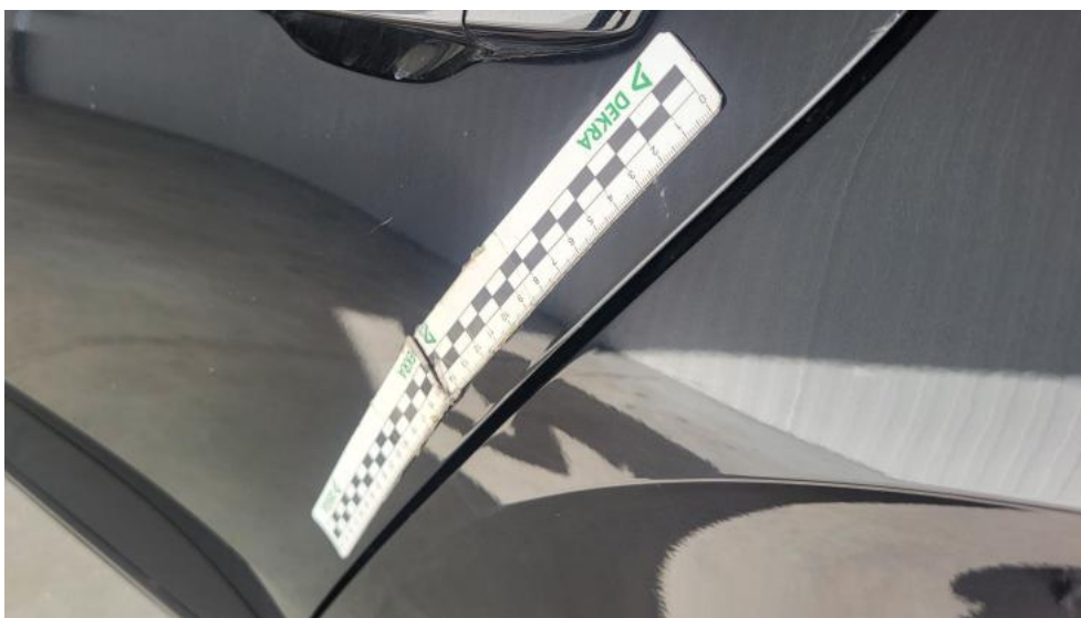
Fot. 61. Drzwi tylne L - Rysa/odprysk 1
