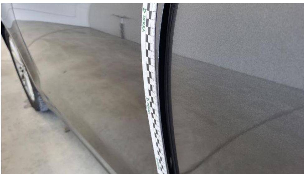
Fot. 50. Drzwi przed L - Rysa/odprysk 1
