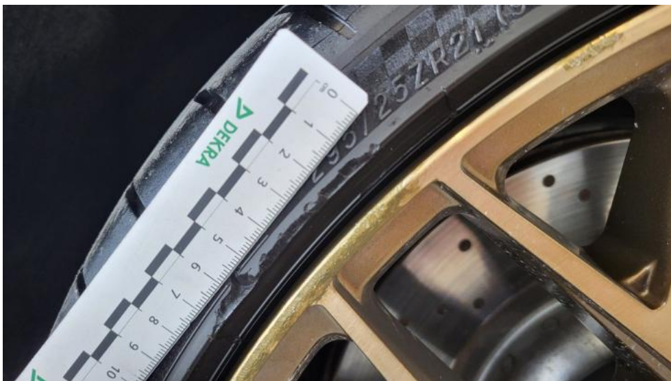
Fot. 64. Opona tylna P - Pęknięcie/rozerwanie 1
