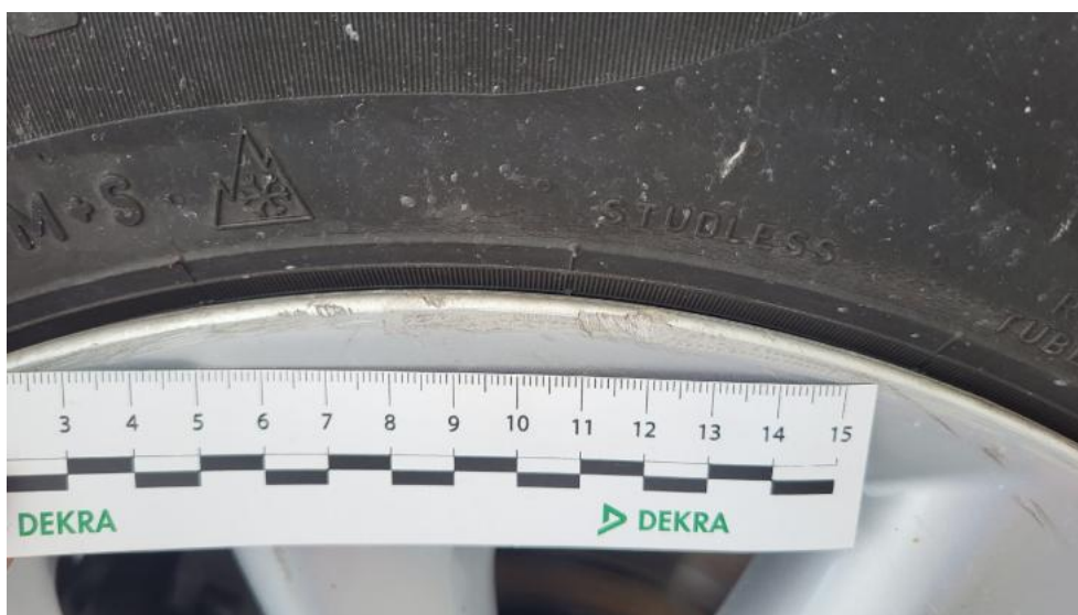
Photo 64. Felga aluminiowa tylna P - Rysa/odprysk 1
