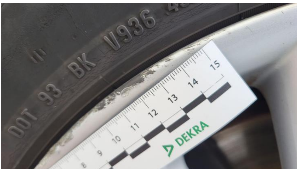
Photo 92. Felga Aluminiowa przednia L - Rysa/odprysk 1
