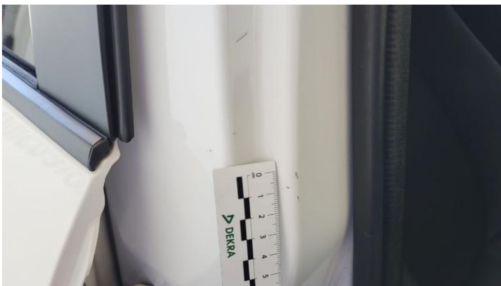
Photo 62. Słupek środkowy P - Rysa/odprysk 1
