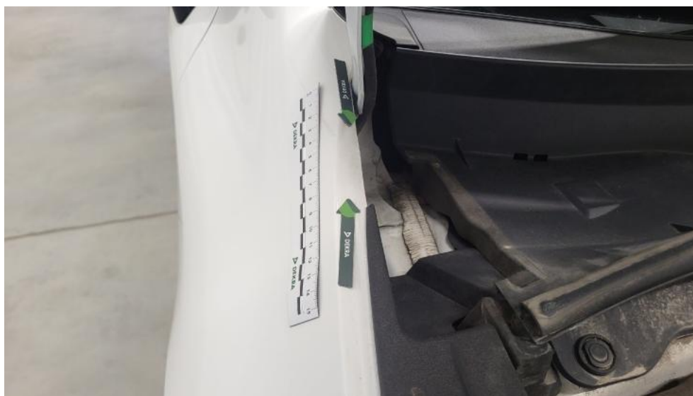
Photo 53. Błotnik przedni P - Wgniecenie/odkształcenie 1
