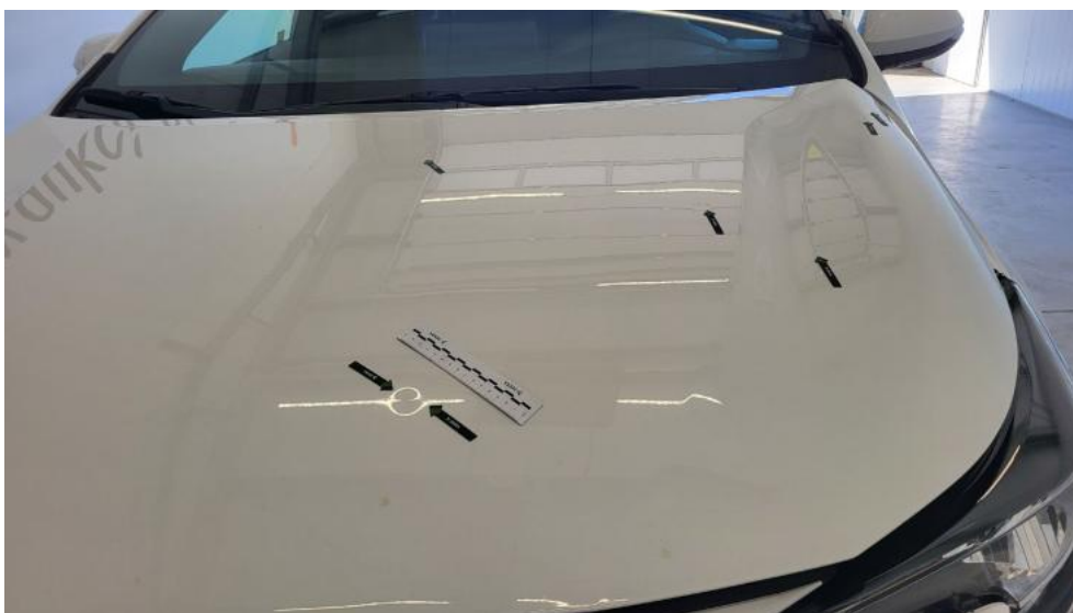
Photo 43. Pokrywa komory silnika - Wgniecenie/odkształcenie 1
