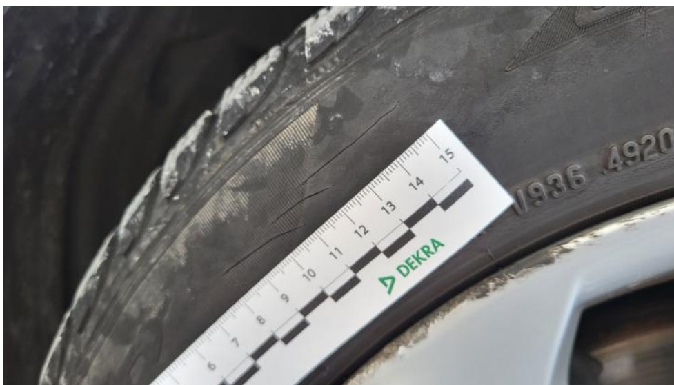
Photo 94. Opona przednia L - Pęknięcie/rozerwanie 1
