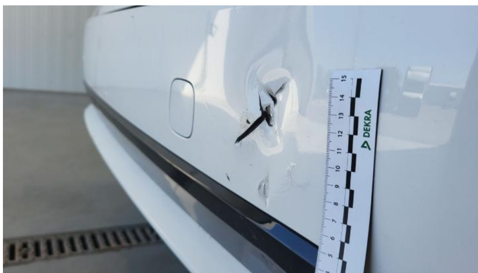
Photo 68. Zderzak tylny - Wgniecenie/odkształcenie 1
