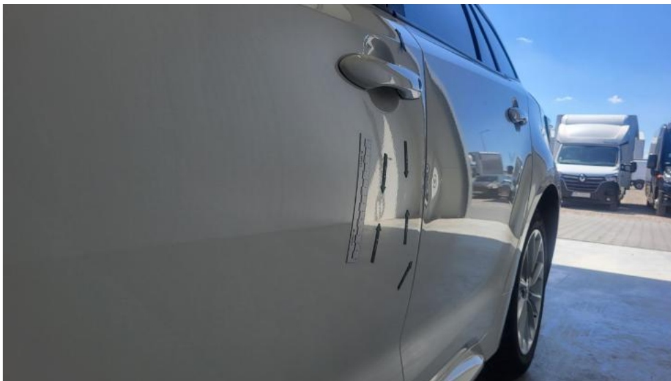
Photo 83. Drzwi przed L - Wgniecenie/odkształcenie 1
