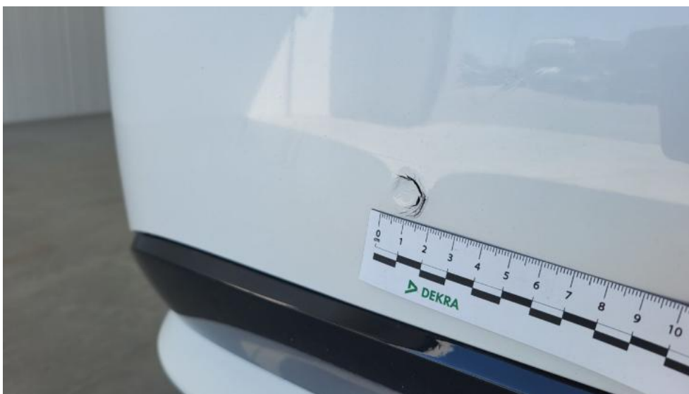
Photo 70. Zderzak tylny - Pęknięcie/rozerwanie 2
