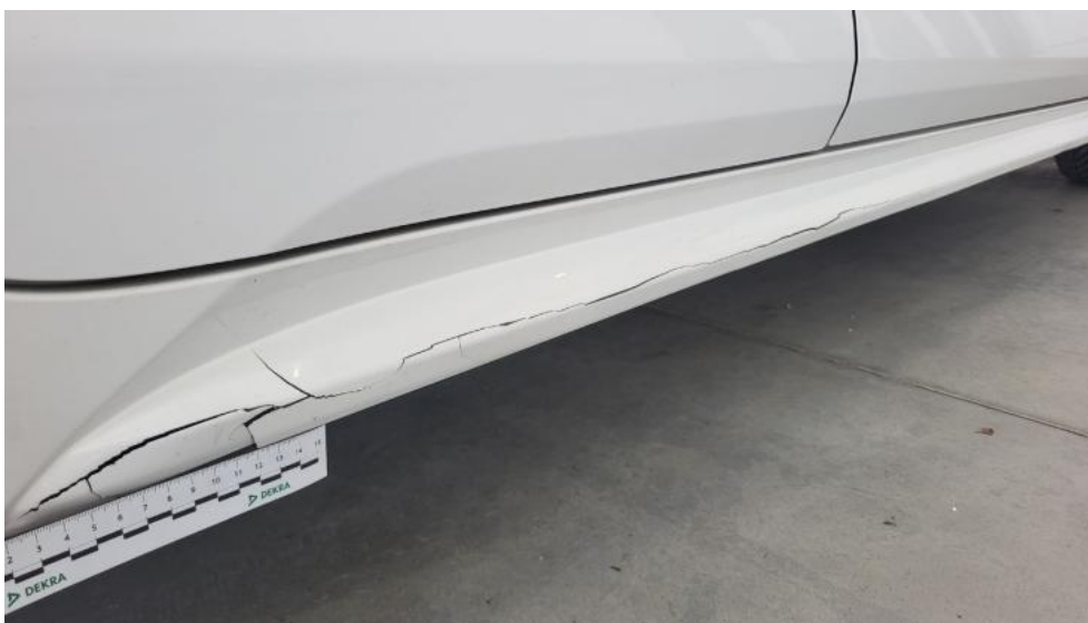
Photo 61. Próg P - Pęknięcie/rozerwanie 1
