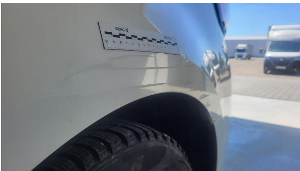
Photo 79. Błotnik tylny L / Ściana boczna L - Rysa/odprysk 1
