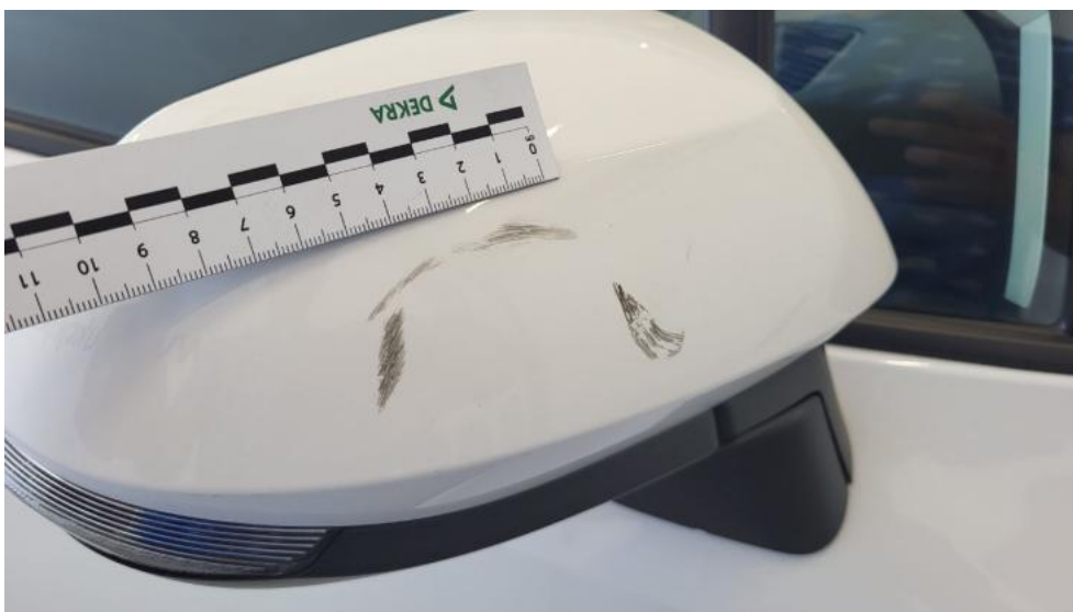
Photo 60. Lusterko zew P - Rysa/odprysk 1
