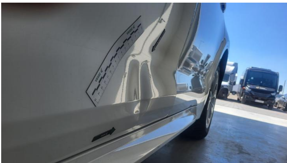
Photo 84. Drzwi przed L - Wgniecenie/odkształcenie 2
