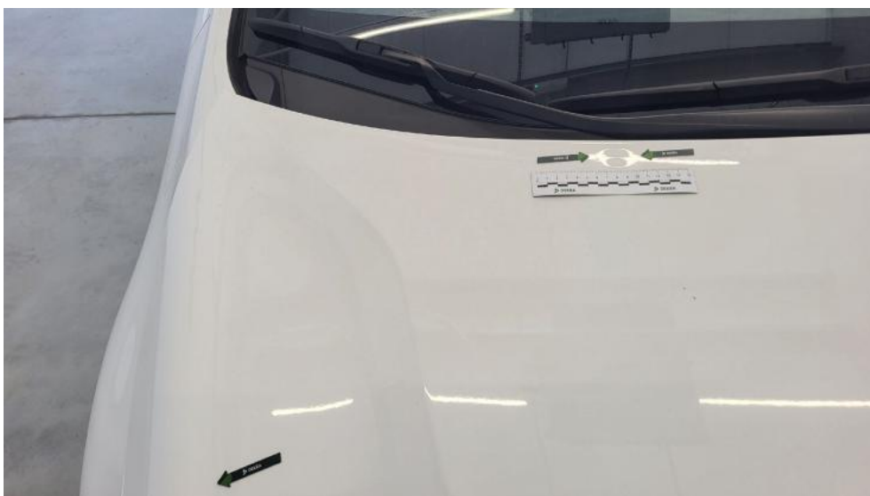
Photo 44. Pokrywa komory silnika - Wgniecenie/odkształcenie 2
