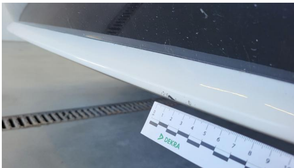
Photo 72. Zderzak tylny cz dolna - Rysa/odprysk 1
