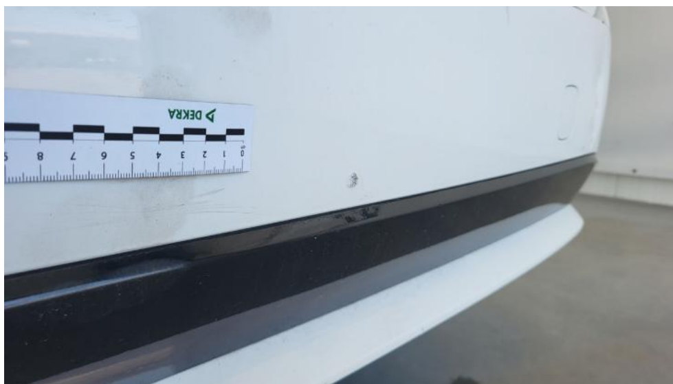
Photo 71. Zderzak tylny() - Pęknięcie/rozerwanie 3
