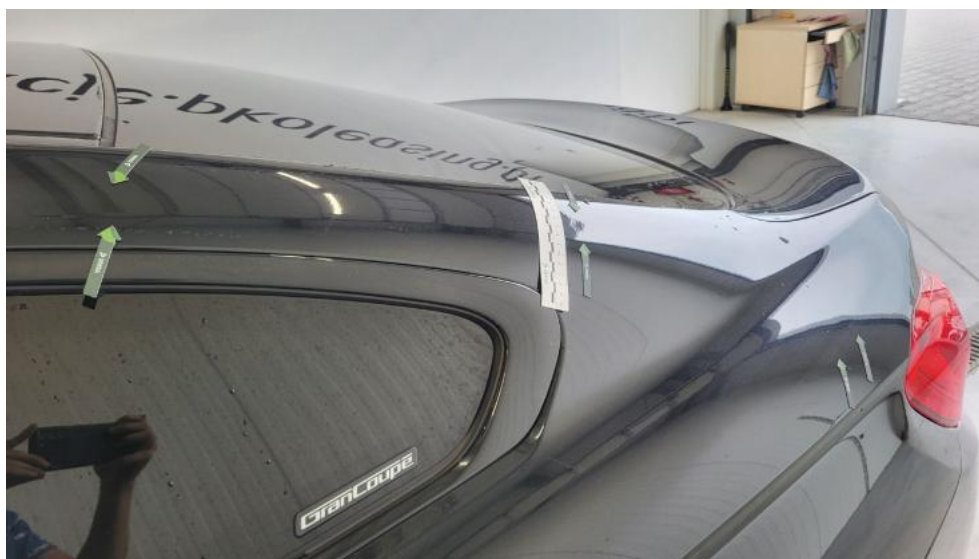
Photo 65. Błotnik tylny L / Ściana boczna L - Wgniecenie/odkształcenie 1
