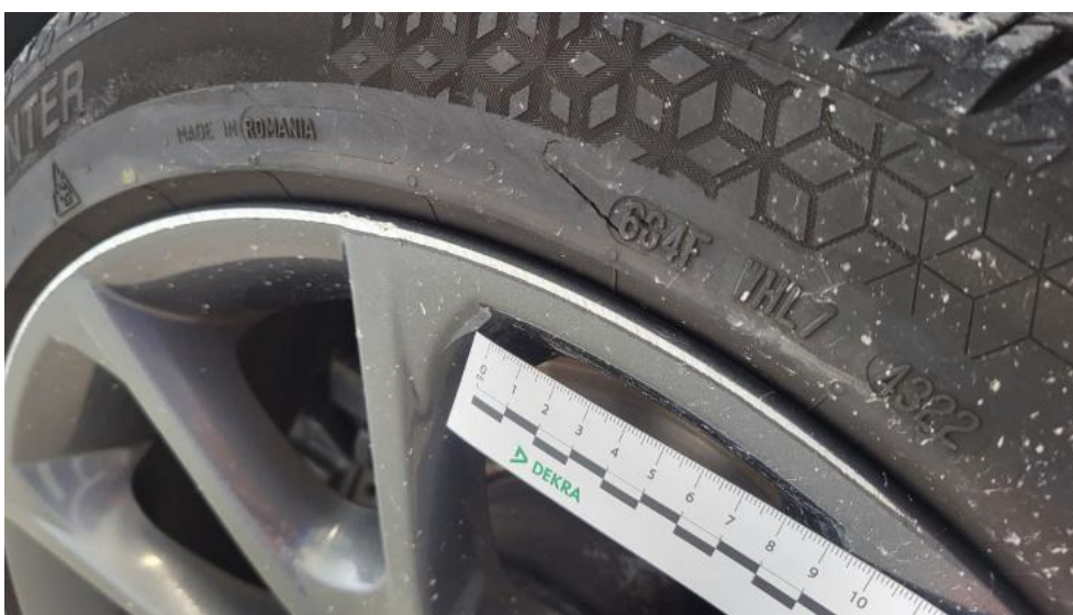
Photo 50. Felga aluminiowa przednia P - Rysa/odprysk 1
