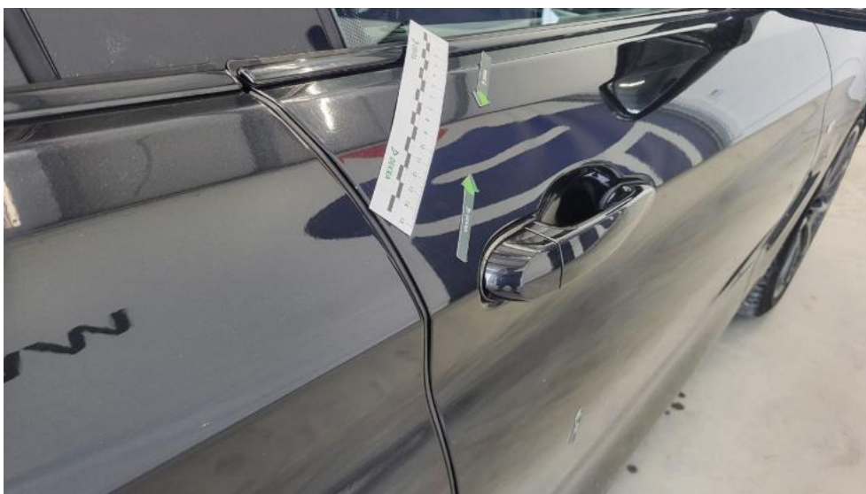
Photo 54. Drzwi przednie P - Wgniecenie/odkształcenie 2
