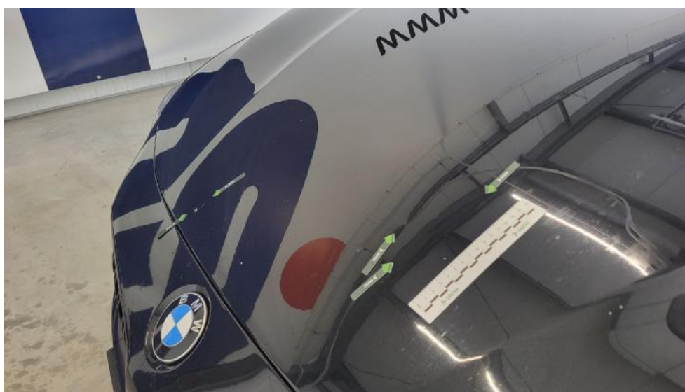
Photo 42. Pokrywa komory silnika - Wgniecenie/odkształcenie 1
