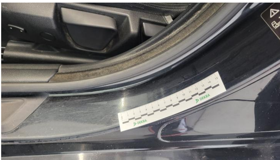
Photo 74. Próg L - Rysa/odprysk 1
