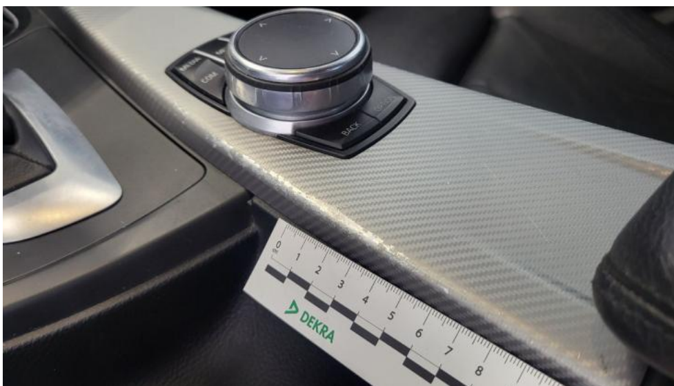
Photo 79. Konsola tunelu śr. - Rysa/odprysk 1
