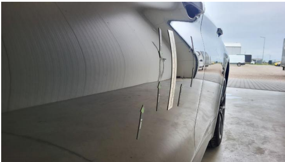
Photo 69. Drzwi przed L - Wgniecenie/odkształcenie 1
