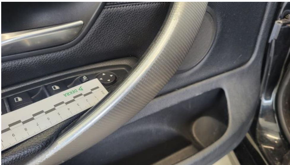
Photo 81. Uchwyt drzwi prze L - Rysa/odprysk 1
