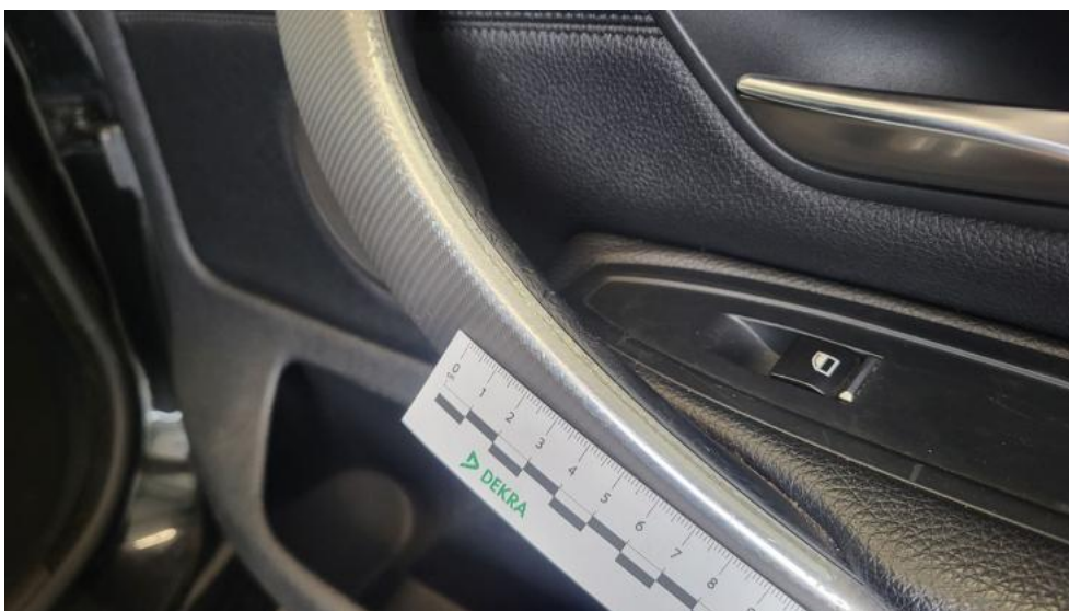
Photo 82. Uchwyt drzwi prze P - Rysa/odprysk 1
