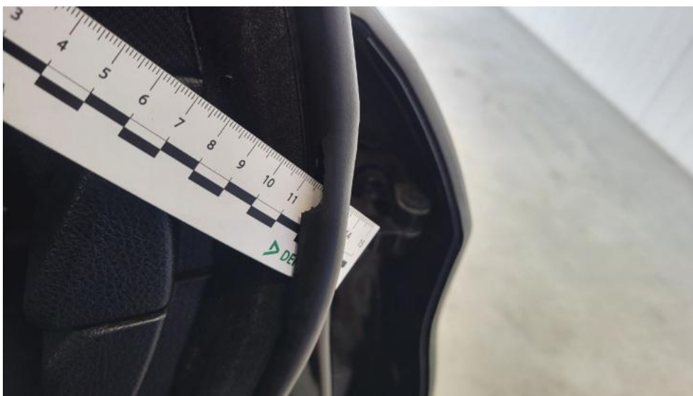
Photo 85. Uszczelka drzwi przednich L - Pęknięcie/rozerwanie 1
