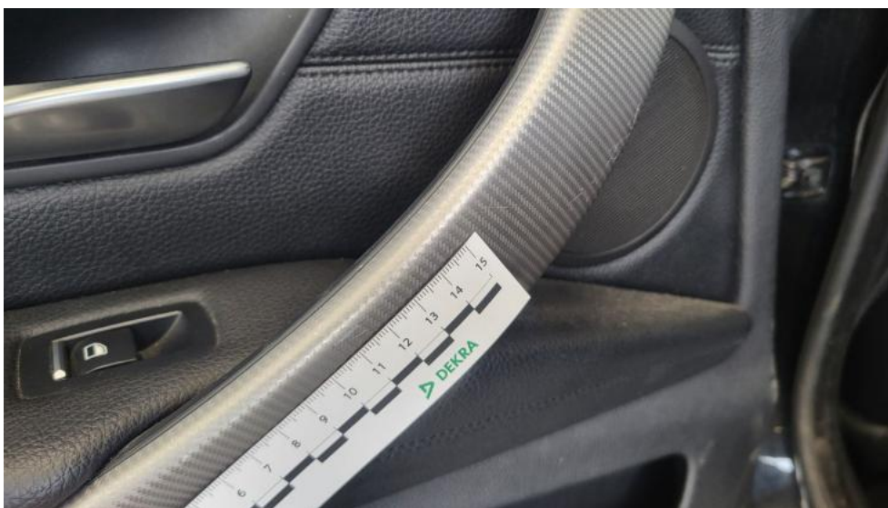
Photo 83. Uchwyt drzwi tyl L - Rysa/odprysk 1
