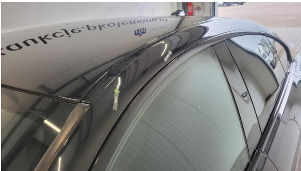
Photo 75. Stupek przedni L - Wgniecenie/odkształcenie 1
