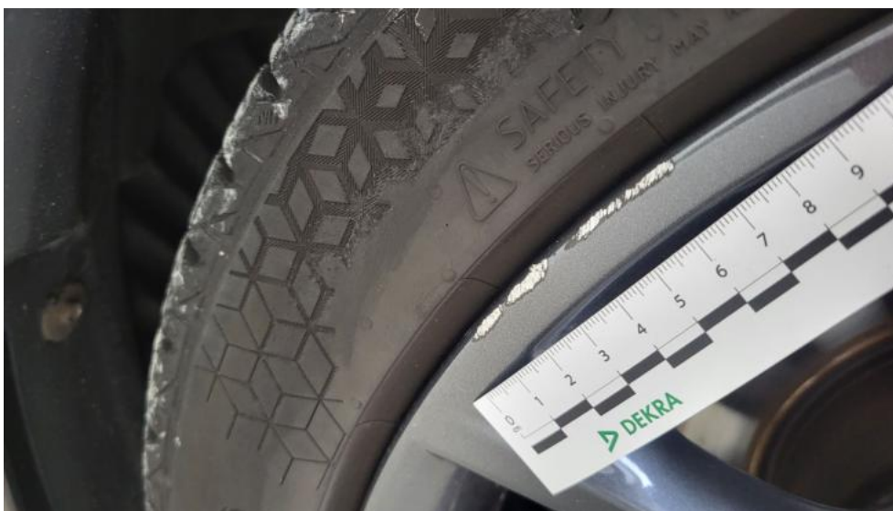
Photo 77. Felga Aluminiowa przednia L - Rysa/odprysk 1
