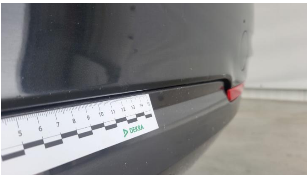
Photo 62. Zderzak tylny - Wgniecenie/odkształcenie 1
