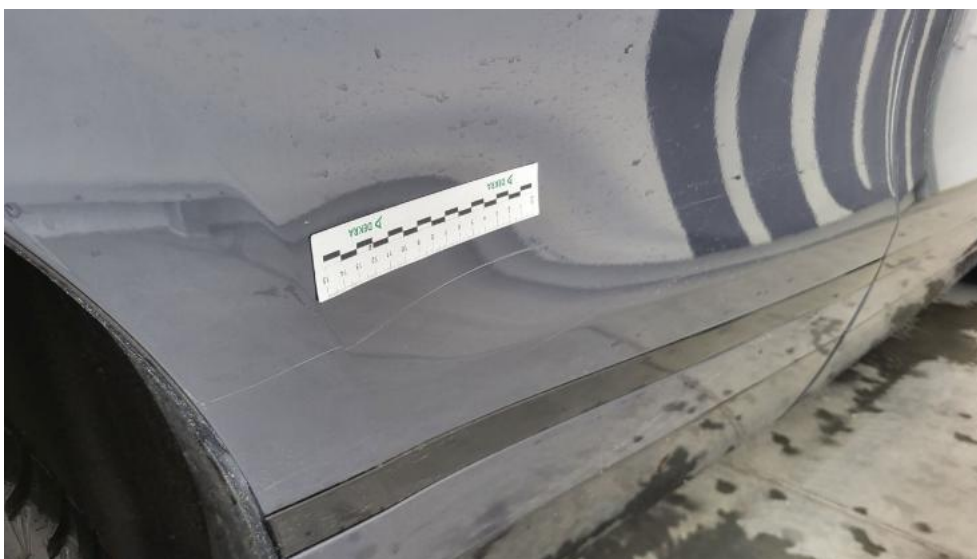
Fot. 47. Drzwi tylne P - Rysa/odprysk 1
