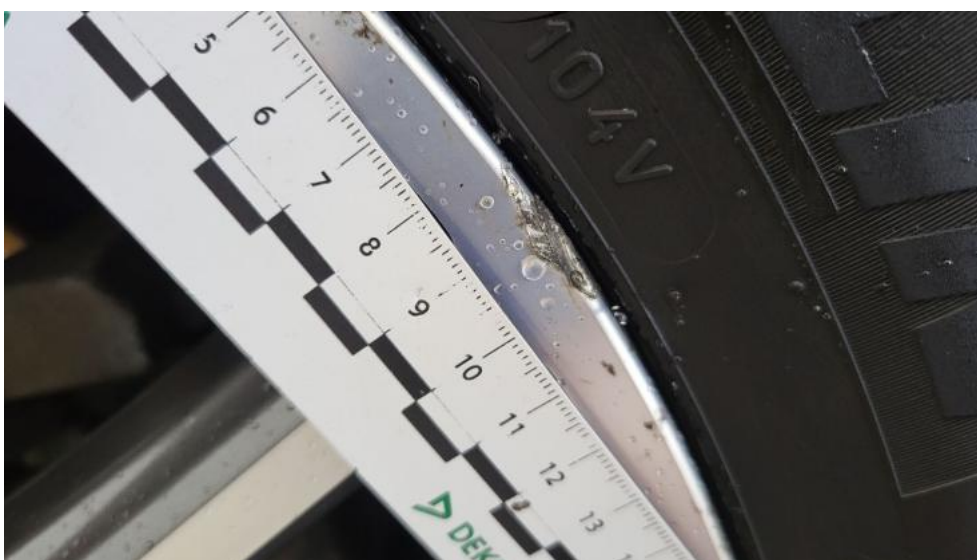
Fot. 56. Felga Aluminiowa przednia L - Rysa/odprysk 1
