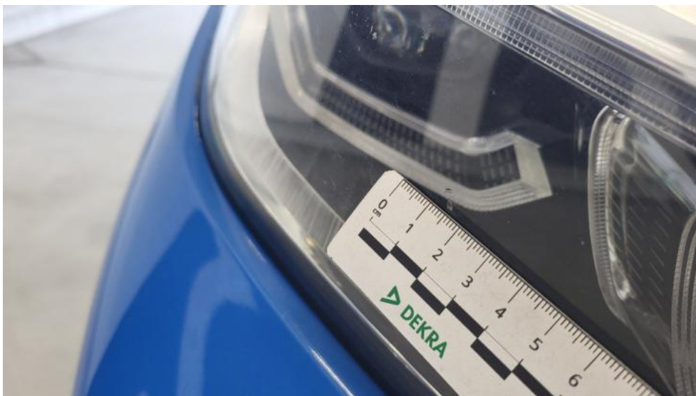
Fot. 51. Reflektor P - Rysa/odprysk 1
