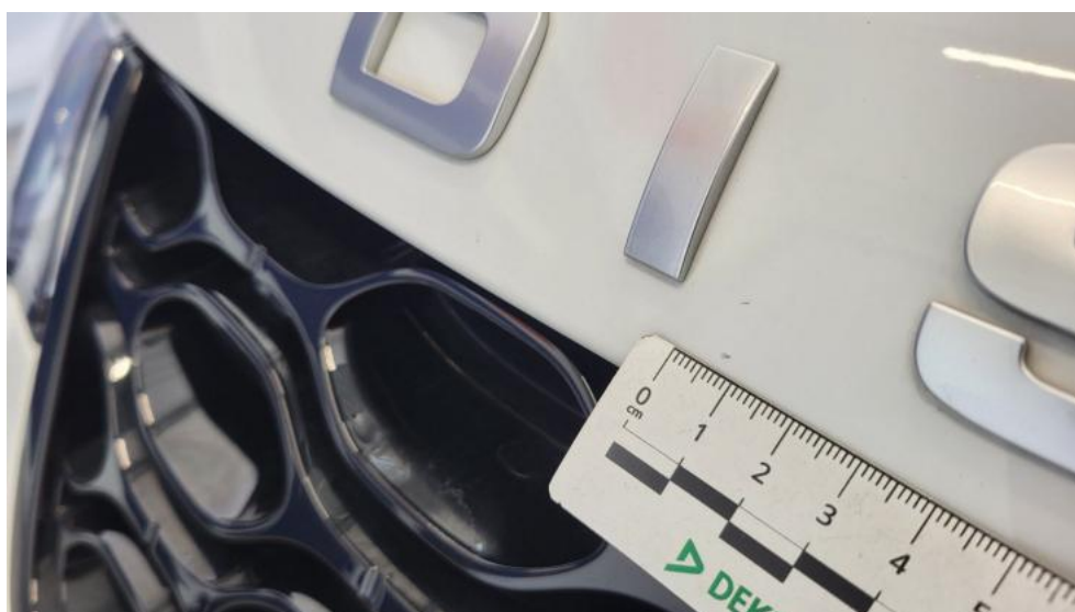
Photo 40. Pokrywa komory silnika - Rysa/odprysk 1
