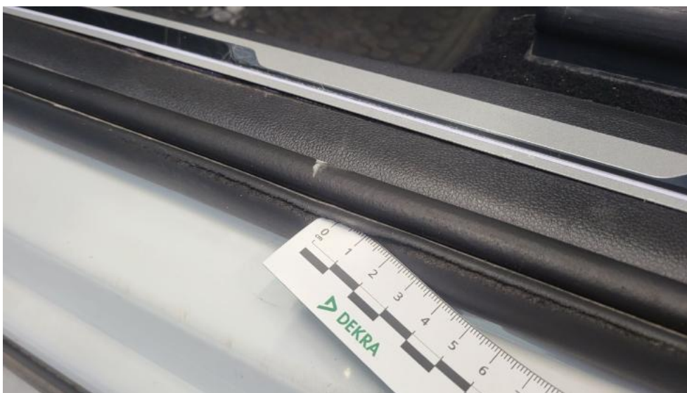
Fot. 83. Uszczelka drzwi przednich L - Pęknięcie/rozerwanie 1
