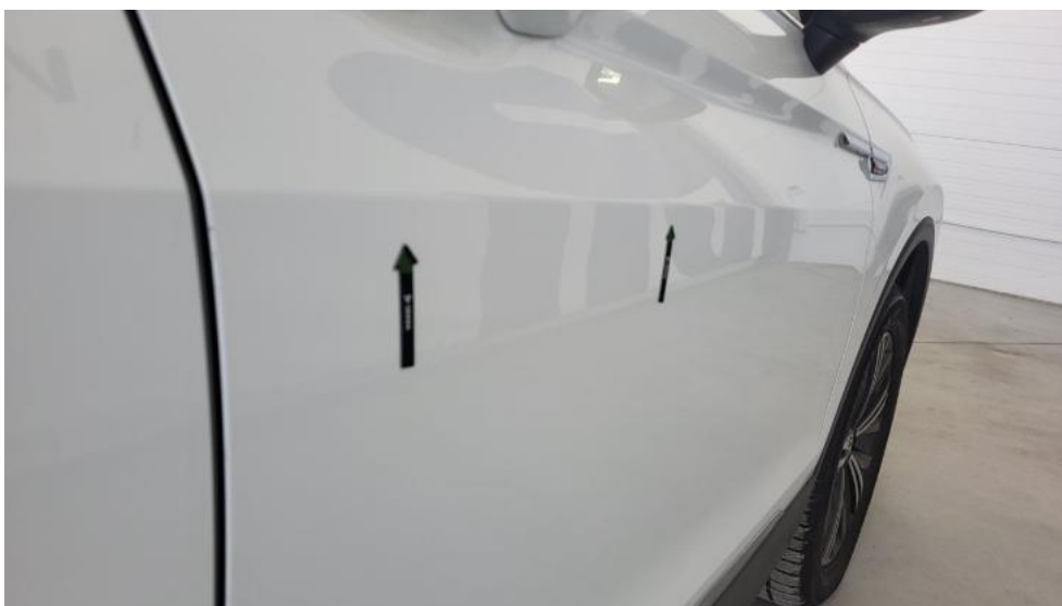
Fot. 50. Drzwi przednie P - Wgniecenie/odkształcenie 1
