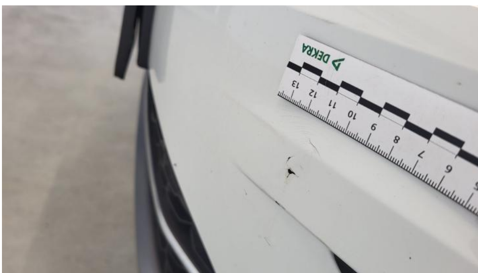
Fot. 46. Zderzak - Pęknięcie/rozerwanie 1
