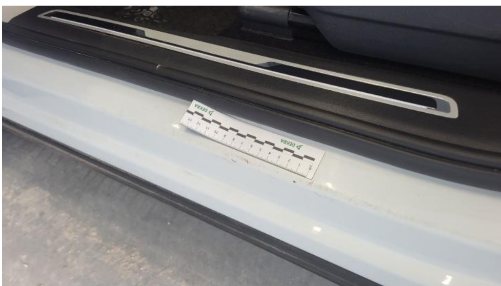
Fot. 78. Próg L - Rysa/odprysk 2
