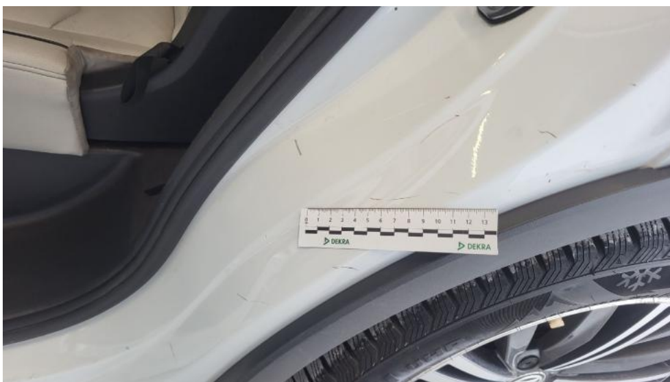
Fot. 68. Błotnik tylny L / Ściana boczna L - Rysa/odprysk 1
