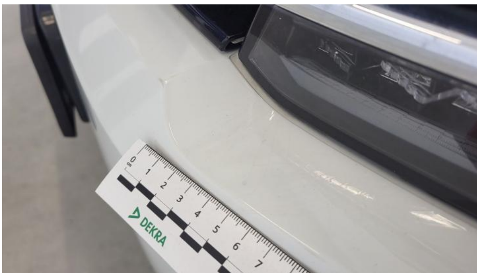
Fot. 47. Zderzak - Pęknięcie/rozerwanie 2
