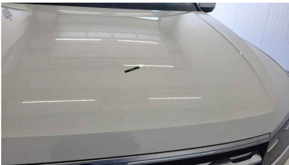
Fot. 45. Pokrywa komory silnika - Wgniecenie/odkształcenie 1
