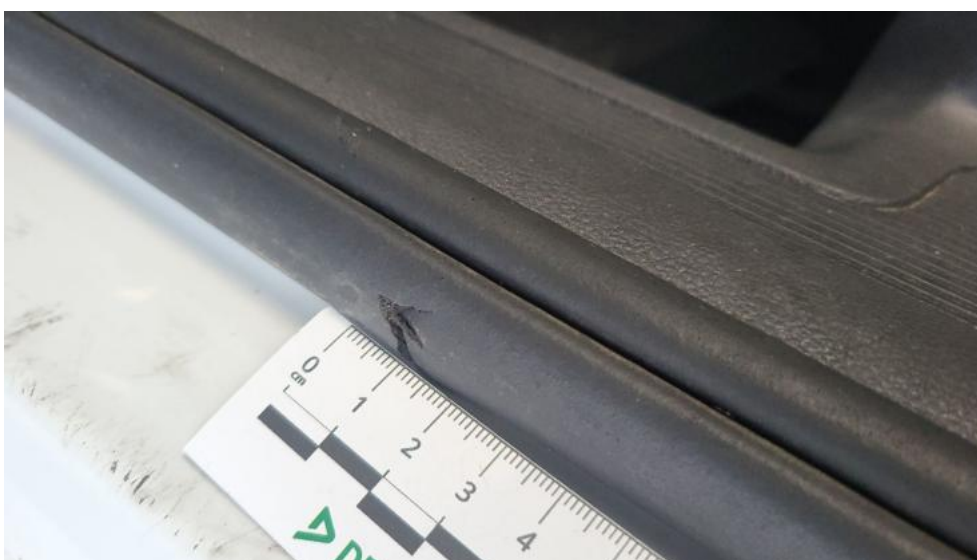
Fot. 84. Uszczelka drzwi tylnych L - Pęknięcie/rozerwanie 1
