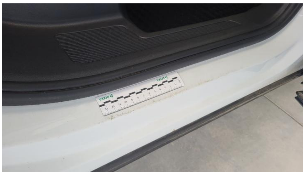
Fot. 54. Próg P - Rysa/odprysk 2
