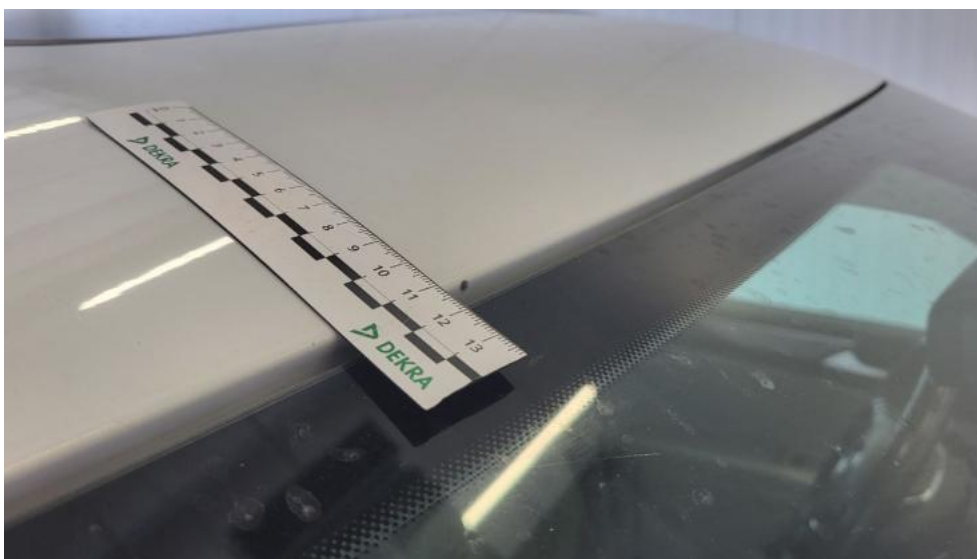
Fot. 67. Dach - Rysa/odprysk 1
