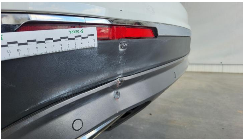
Fot. 65. Zderzak tylny cz dolna - Wgniecenie/odkształcenie 1
