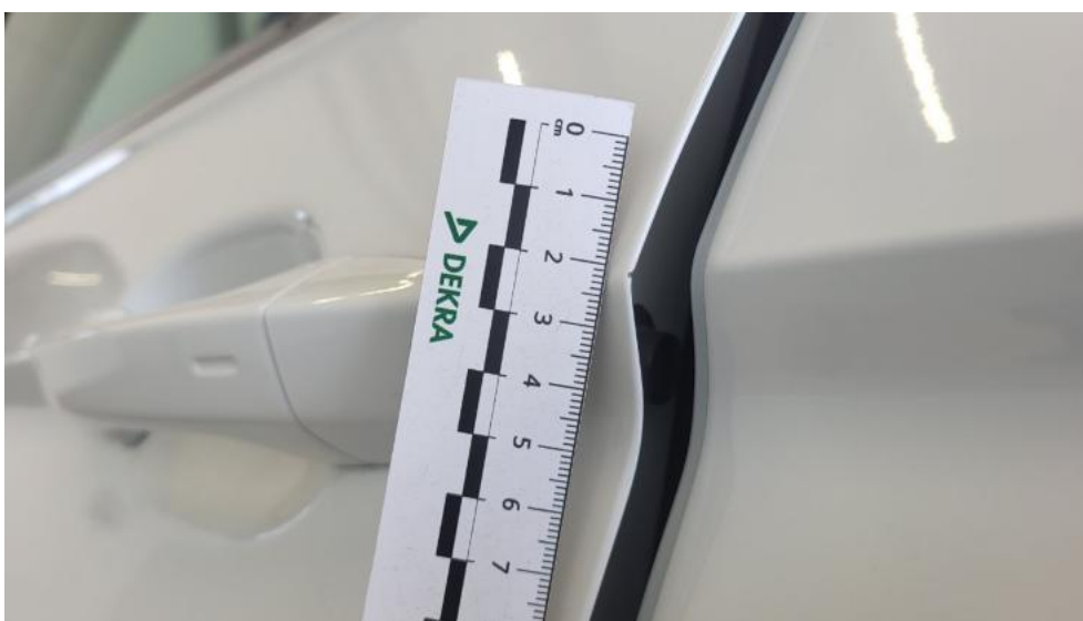
Fot. 72. Drzwi przed L - Rysa/odprysk 1
