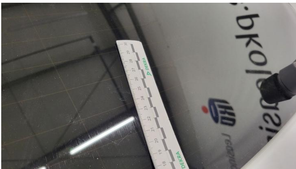
Photo 53. Szyba tylna - Rysa/odprysk 1
