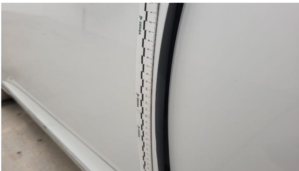
Photo 60. Drzwi przed L - Rysa/odprysk 1
