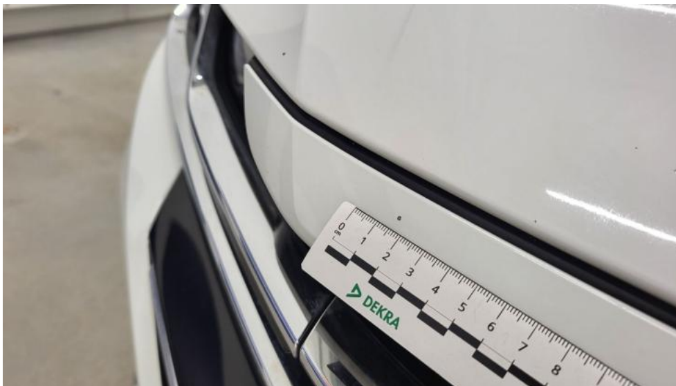
Photo 47. Zderzak przedni cz górna - Rysa/odprysk 1
