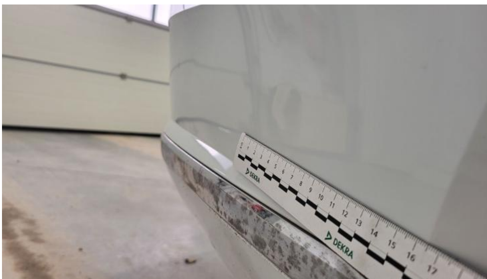
Photo 55. Zderzak tylny - Wgniecenie/odkształcenie 1
