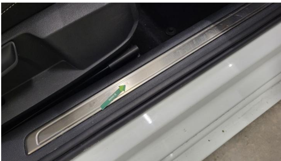
Photo 69. Listwy progowe praw. - Wgniecenie/odkształcenie 1
