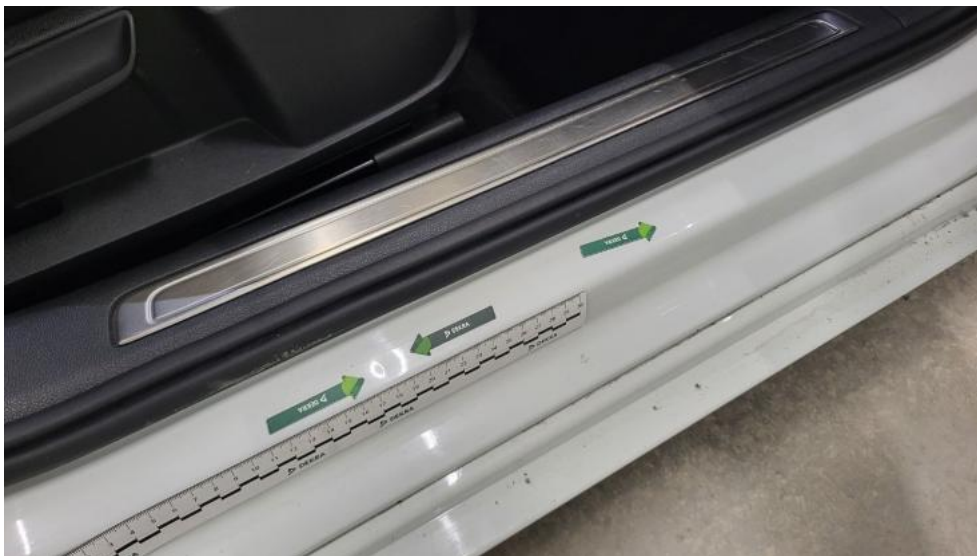
Photo 51. Próg P - Wgniecenie/odkształcenie 1
