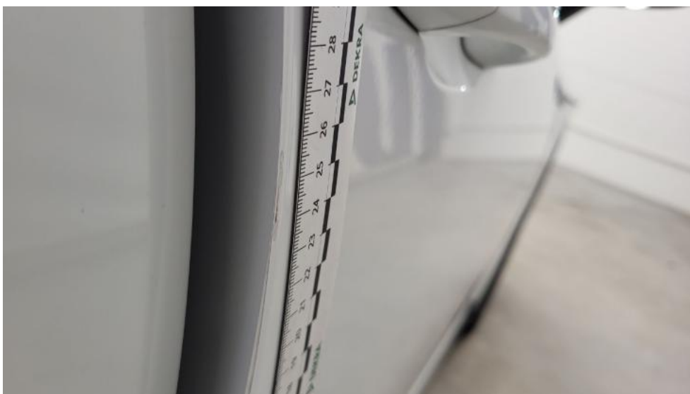
Photo 48. Drzwi przednie P - Rysa/odprysk 1
