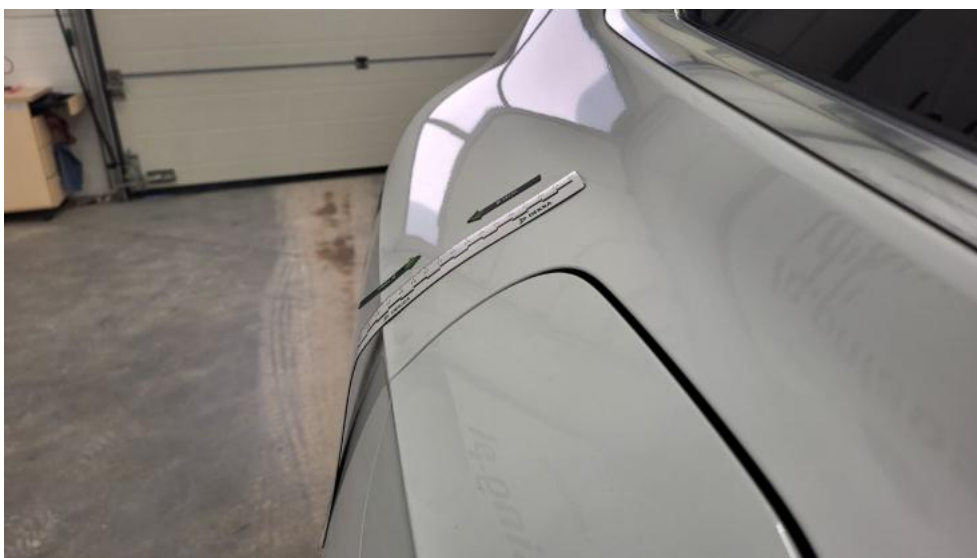
Photo 52. Błotnik tylny P / Ściana boczna P - Wgniecenie/odkształcenie 1
