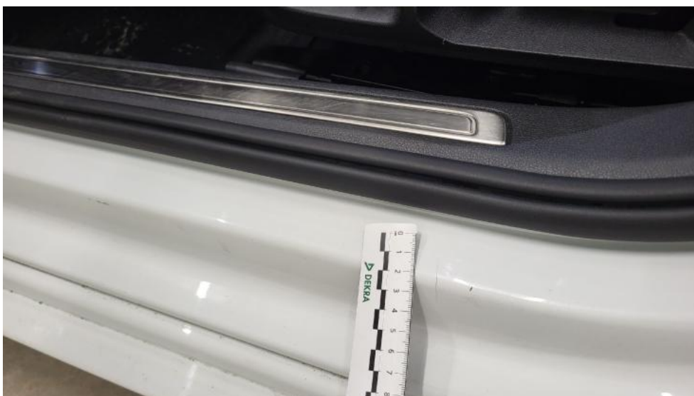
Photo 62. Próg L - Rysa/odprysk 1
