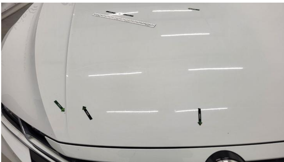
Photo 43. Pokrywa komory silnika - Wgniecenie/odkształcenie 1
