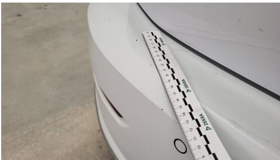
Photo 54. Zderzak tylny - Rysa/odprysk 1
