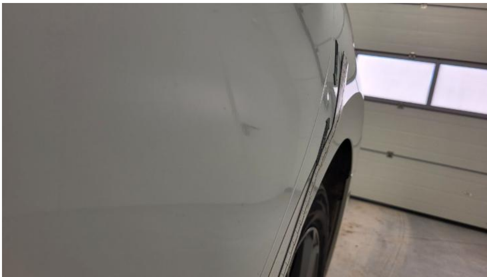
Photo 59. Błotnik tylny L / Ściana boczna L - Wgniecenie/odkształcenie 1
