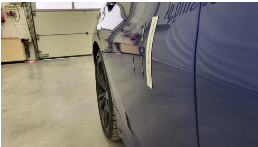
Fot. 55. Drzwi tylne P - Wgniecenie/odkształcenie 1
