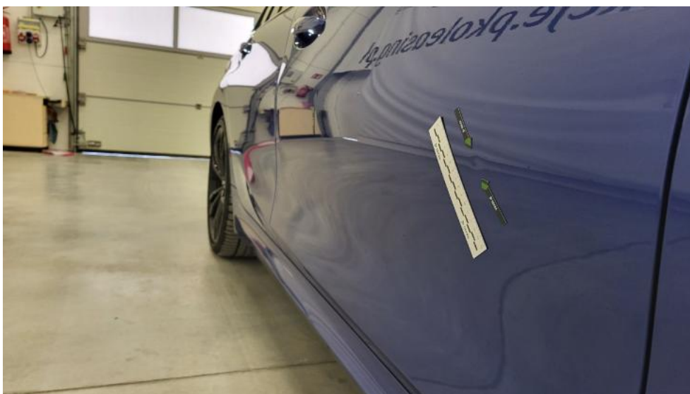
Fot. 54. Drzwi przednie P - Wgniecenie/odkształcenie 1
