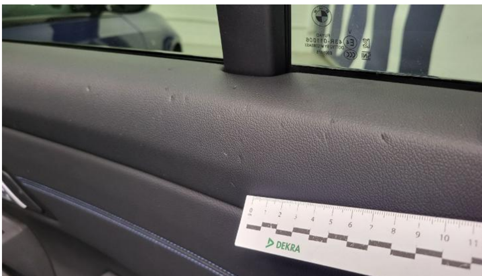
Fot. 75. Tapicerka drzwi tylnych P - Wgniecenie/odkształcenie 1
