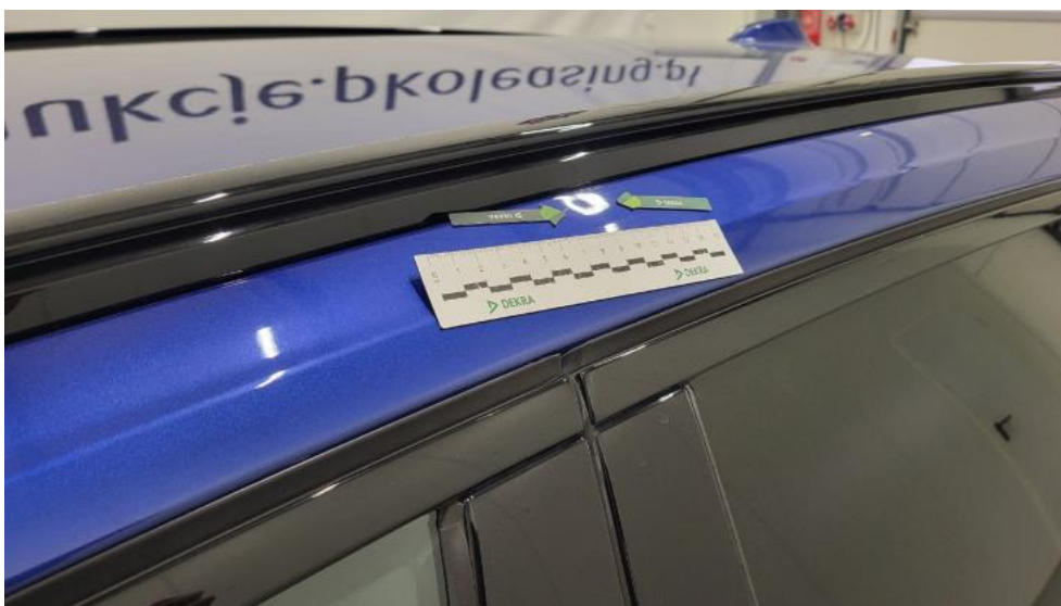
Fot. 68. Słupek przedni L - Wgniecenie/odkształcenie 1
