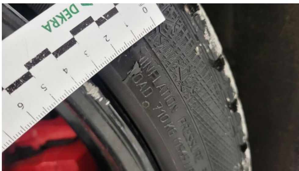
Fot. 58. Opona tylna P - Pęknięcie/rozerwanie 1
