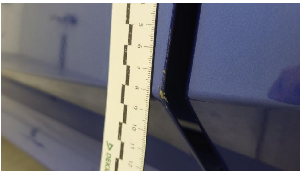
Fot. 63. Drzwi przed L - Rysa/odprysk 1
