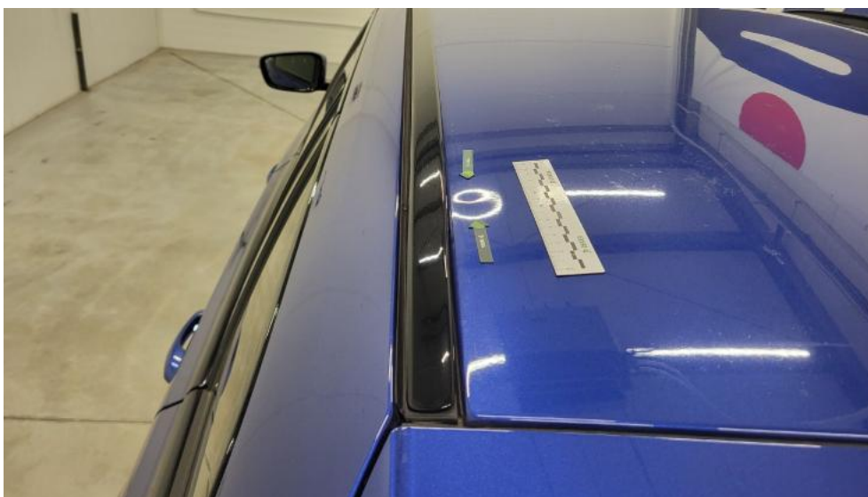
Fot. 61. Dach - Wgniecenie/odkształcenie 1
