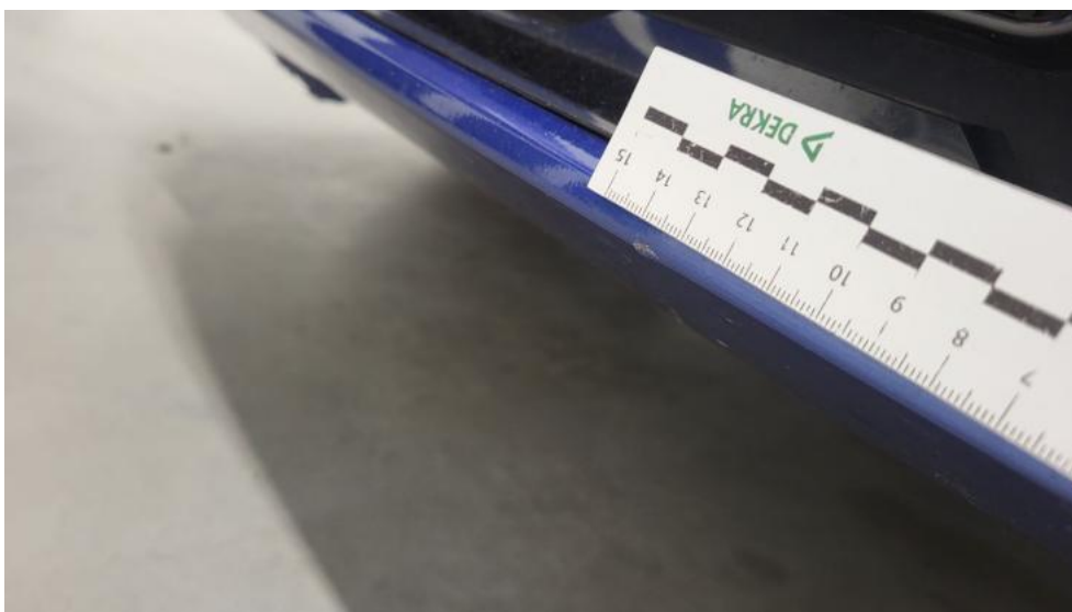
Fot. 50. Zderzak - Wgniecenie/odkształcenie 1
