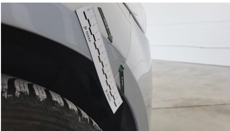
Fot. 58. Błotnik przedni P - Wgniecenie/odkształcenie 1
