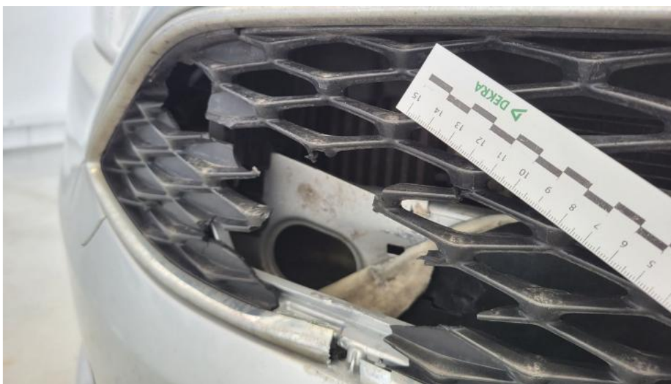
Fot. 41. Kratka zderzaka prz. - Pęknięcie/rozerwanie 2
