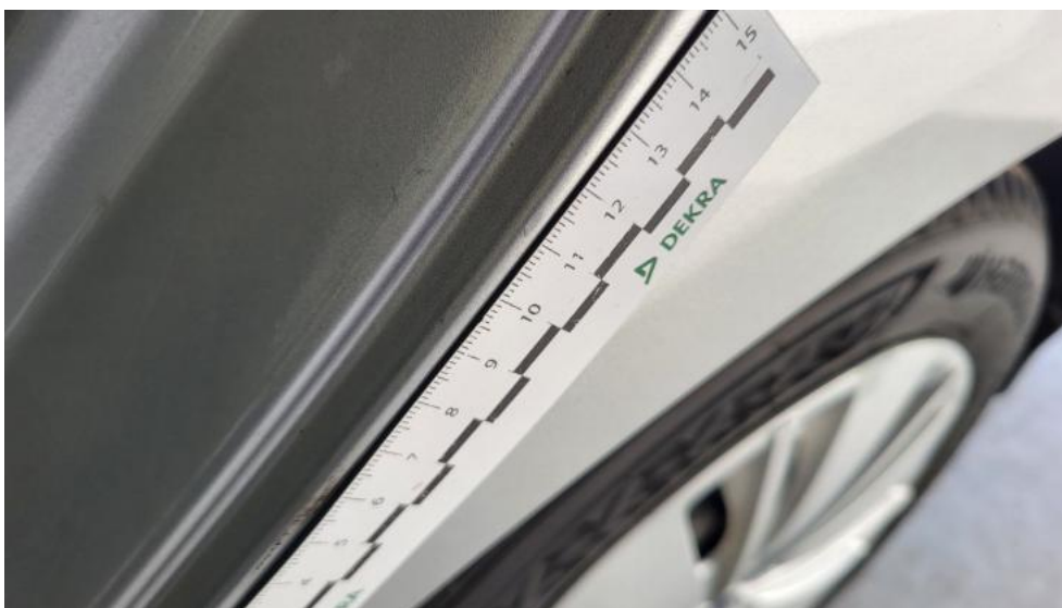
Fot. 75. Błotnik tylny L / Ściana boczna L - Rysa/odprysk 1
