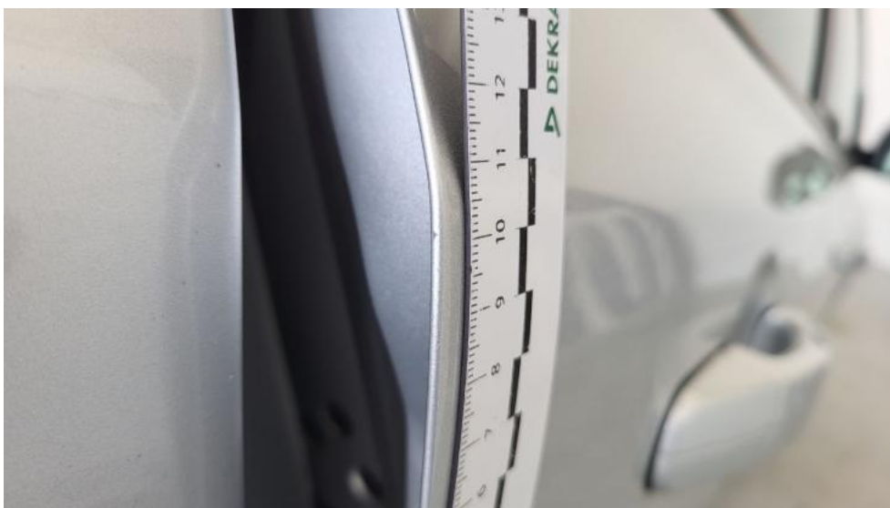
Fot. 64. Drzwi tylne P - Rysa/odprysk 1
