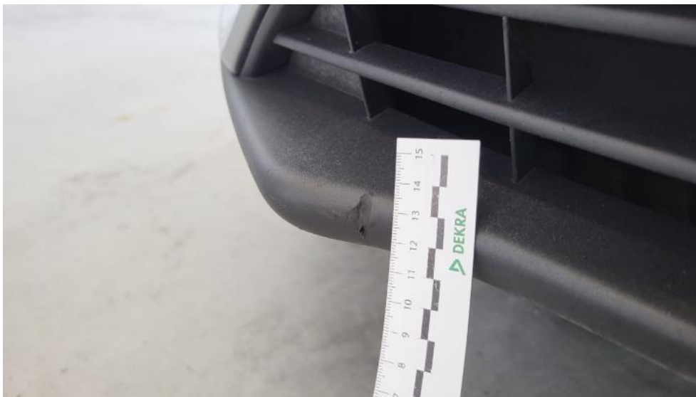
Fot. 47. Spoiler zderzaka przedniego - Wgniecenie/odkształcenie 1
