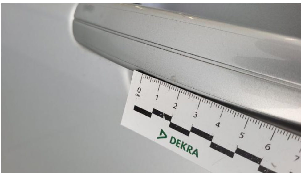
Fot. 82. Klamka drzwi tyl L - Rysa/odprysk 1
