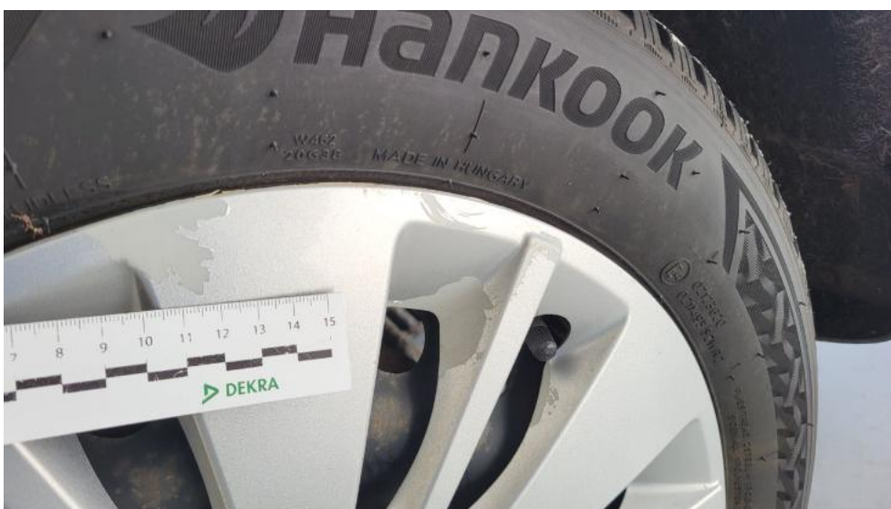
Fot. 76. Kołpak tylny L - Rysa/odprysk 1
