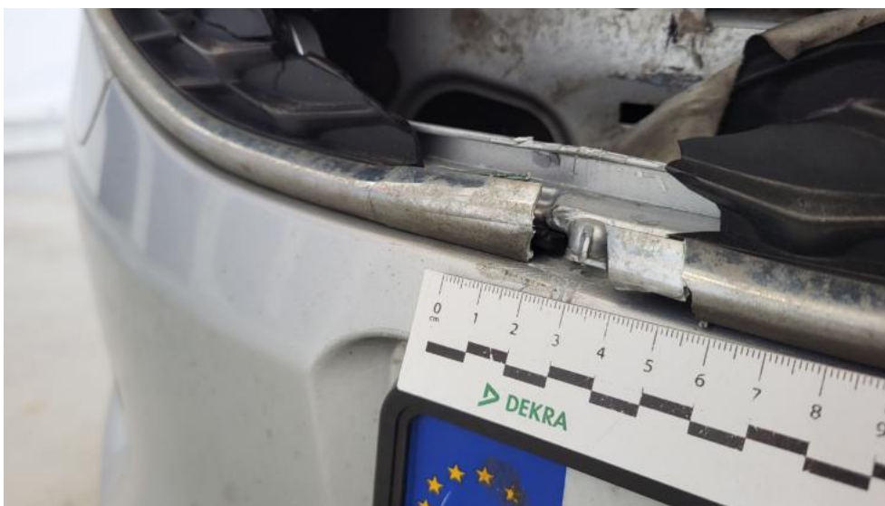
Fot. 43. Listwa śr zderzaka przedniego - Pęknięcie/rozerwanie 1
