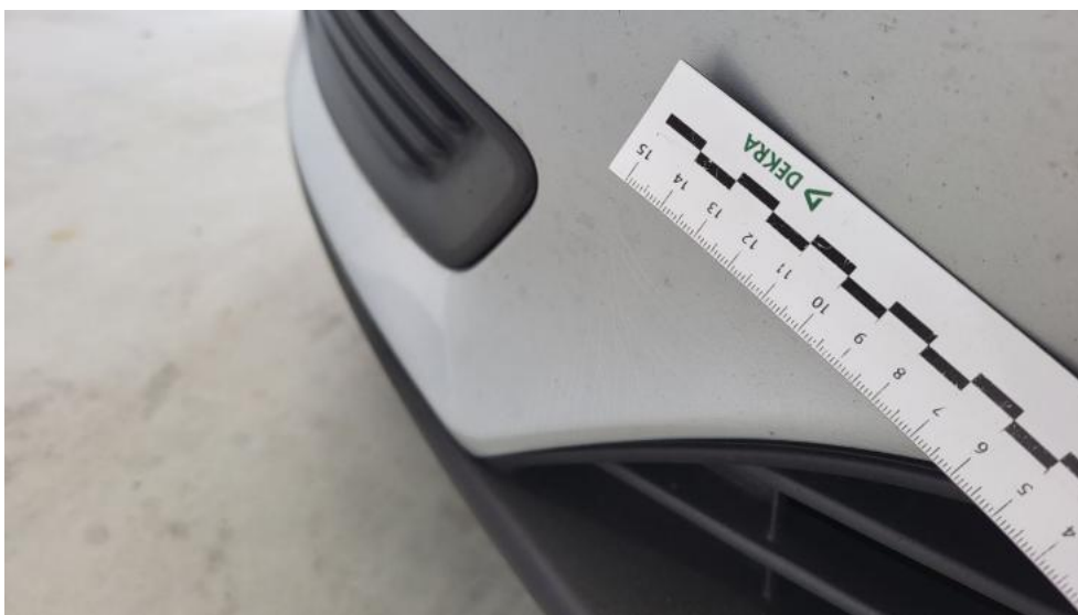
Fot. 56. Zderzak() - Pęknięcie/rozerwanie 3
