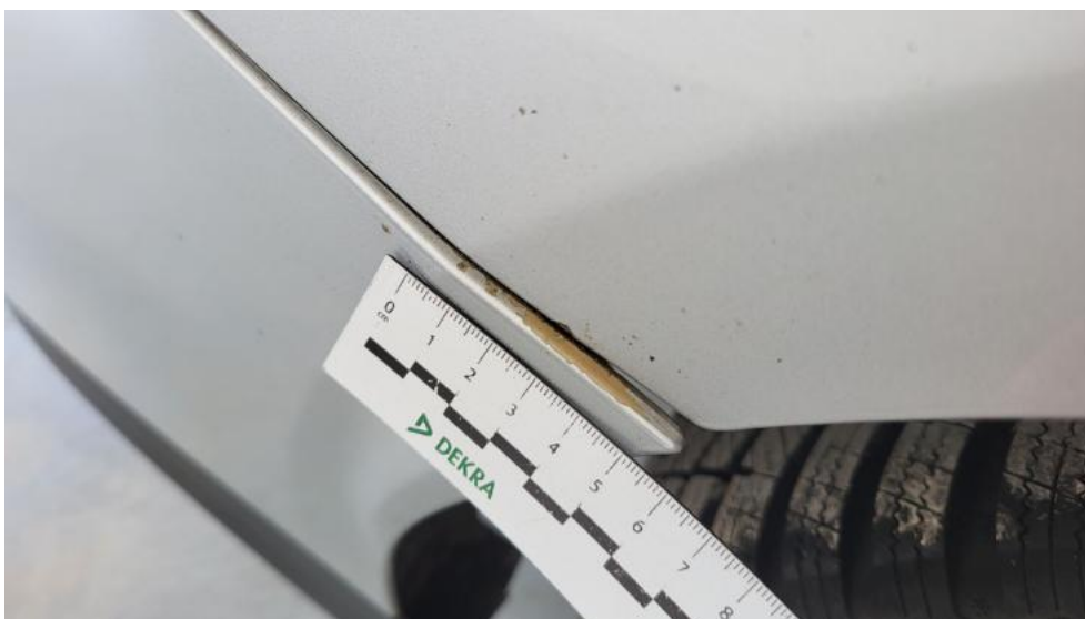
Fot. 72. Zderzak tylny cz P - Rysa/odprysk 1
