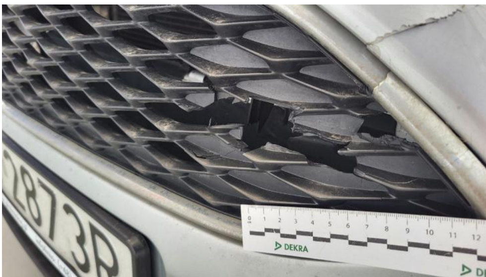
Fot. 40. Kratka zderzaka prz. - Pęknięcie/rozerwanie 1
