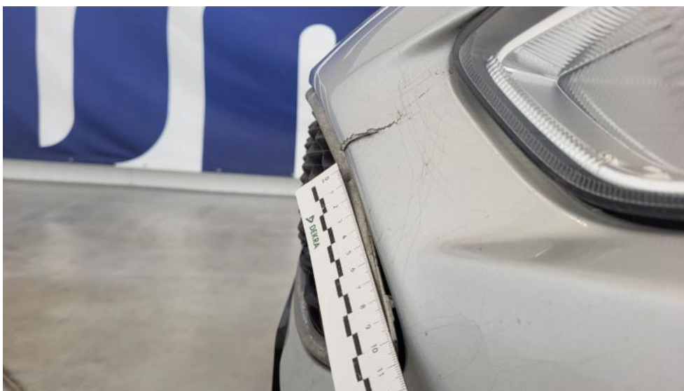
Fot. 52. Zderzak - Wgniecenie/odkształcenie 1
