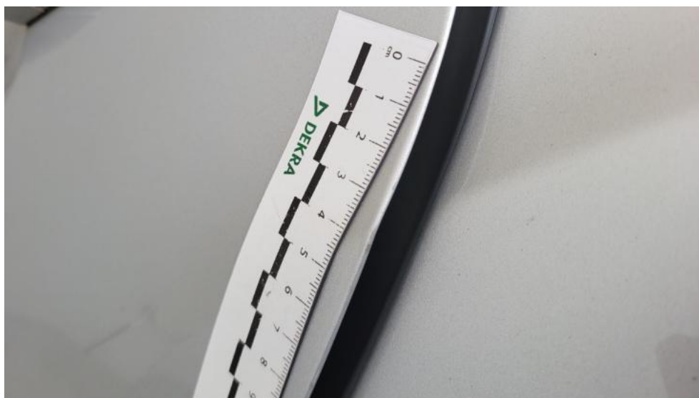
Fot. 80. Drzwi tylne L - Rysa/odprysk 1
