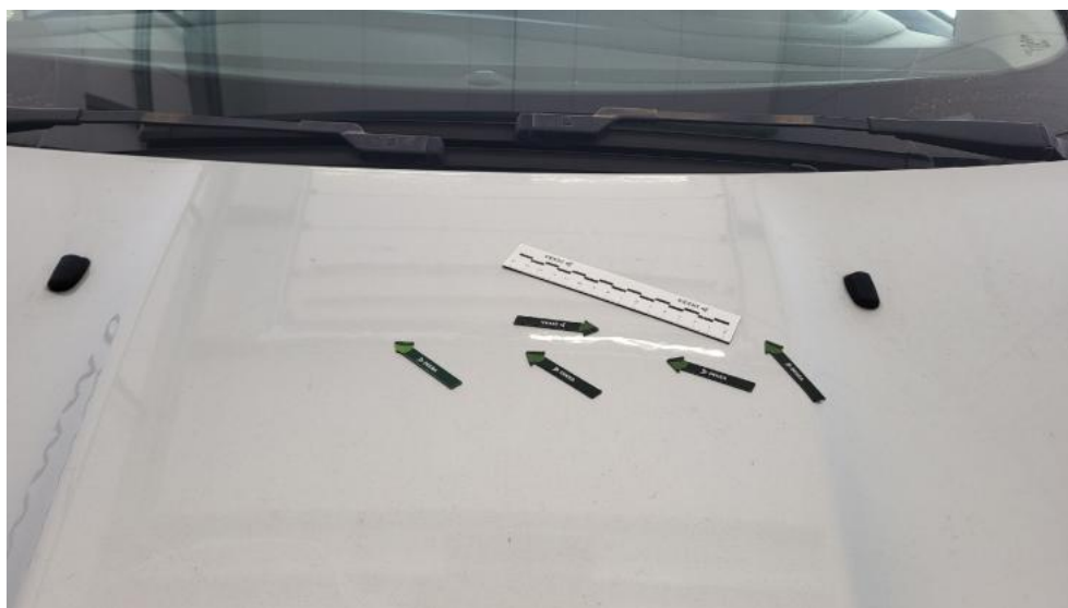
Fot. 46. Pokrywa komory silnika - Wgniecenie/odkształcenie 1
