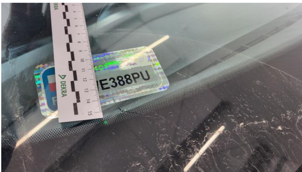
Fot. 49. Szyba czołowa - Pęknięcie/rozerwanie 1
