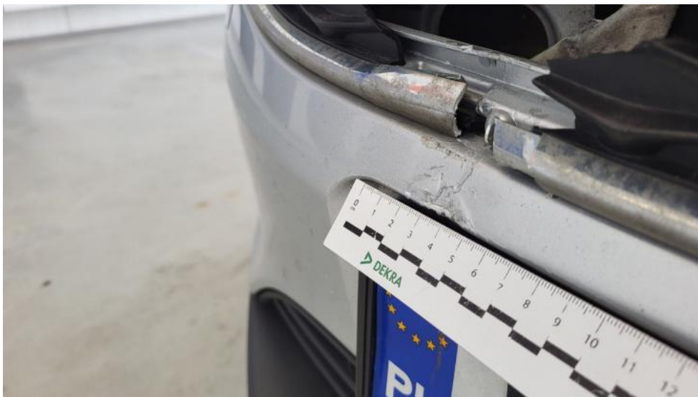
Fot. 53. Zderzak - Wgniecenie/odkształcenie 2
