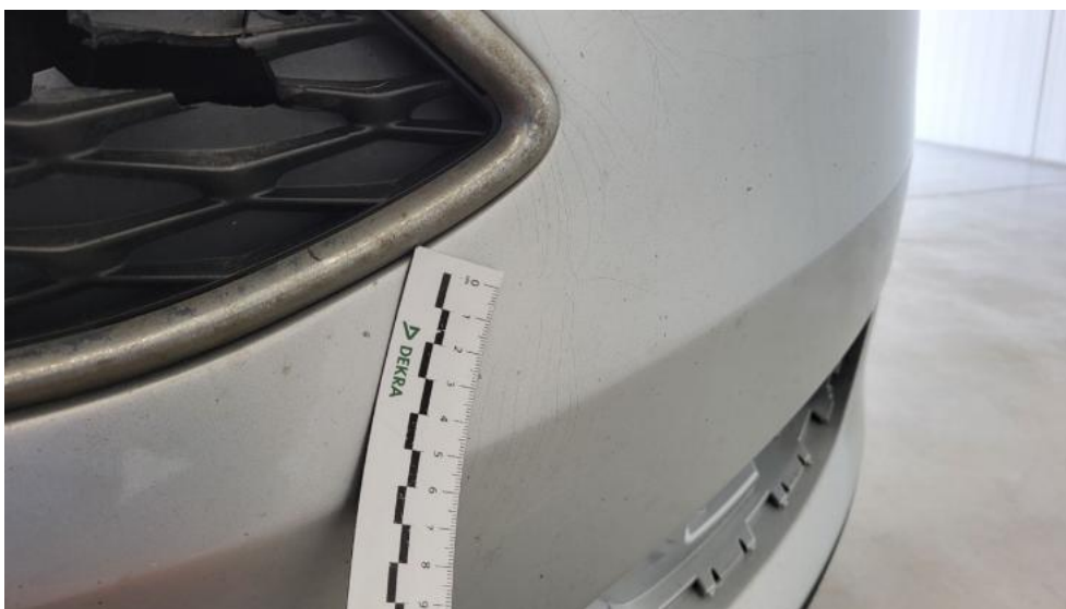
Fot. 55. Zderzak - Pęknięcie/rozerwanie 2
