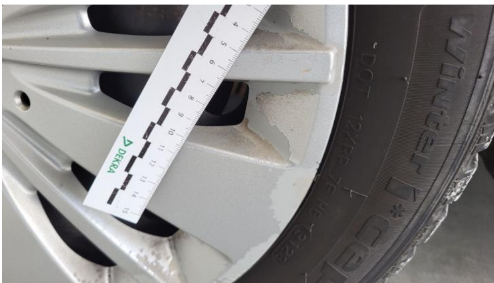
Fot. 87. Kołpak przedni L - Rysa/odprysk 1
