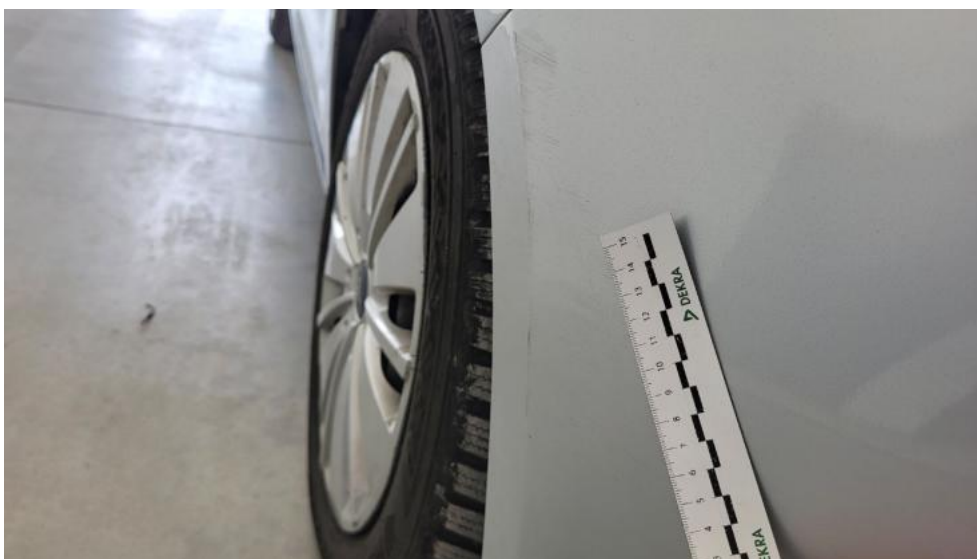
Fot. 51. Zderzak - Rysa/odprysk 2
