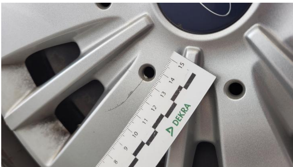
Fot. 61. Kołpak przedni P - Pęknięcie/rozerwanie 1
