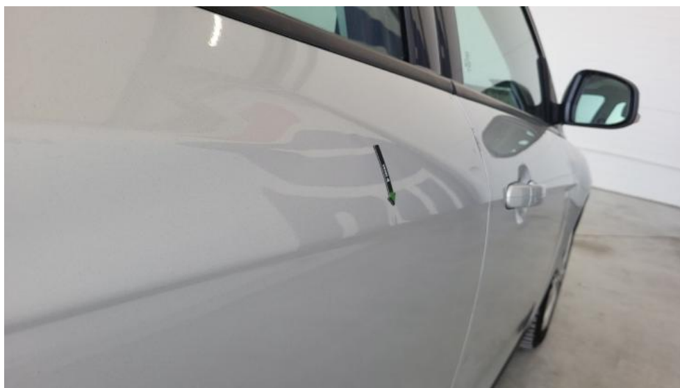
Fot. 65. Drzwi tylne P - Wgniecenie/odkształcenie 1
