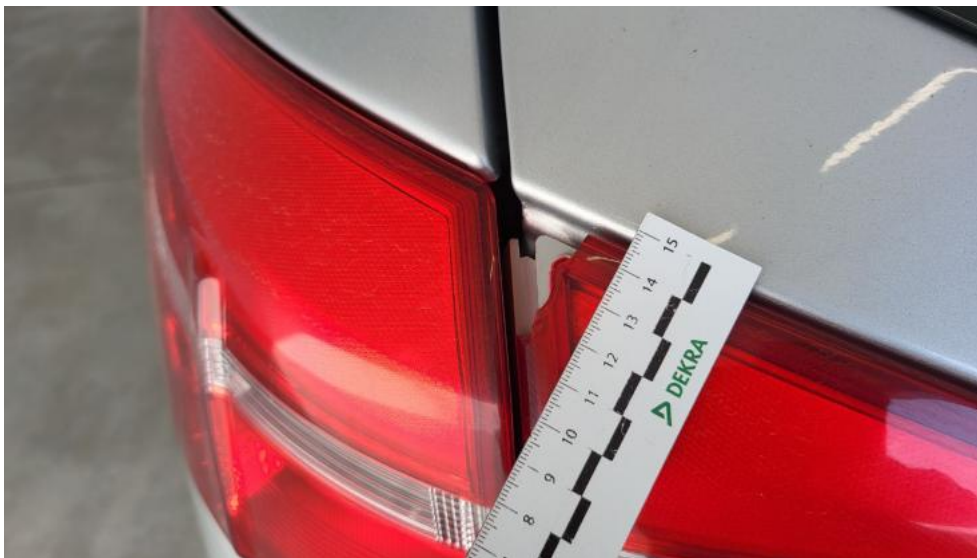
Fot. 77. Lampa tylna wew L - Pęknięcie/rozerwanie 1
