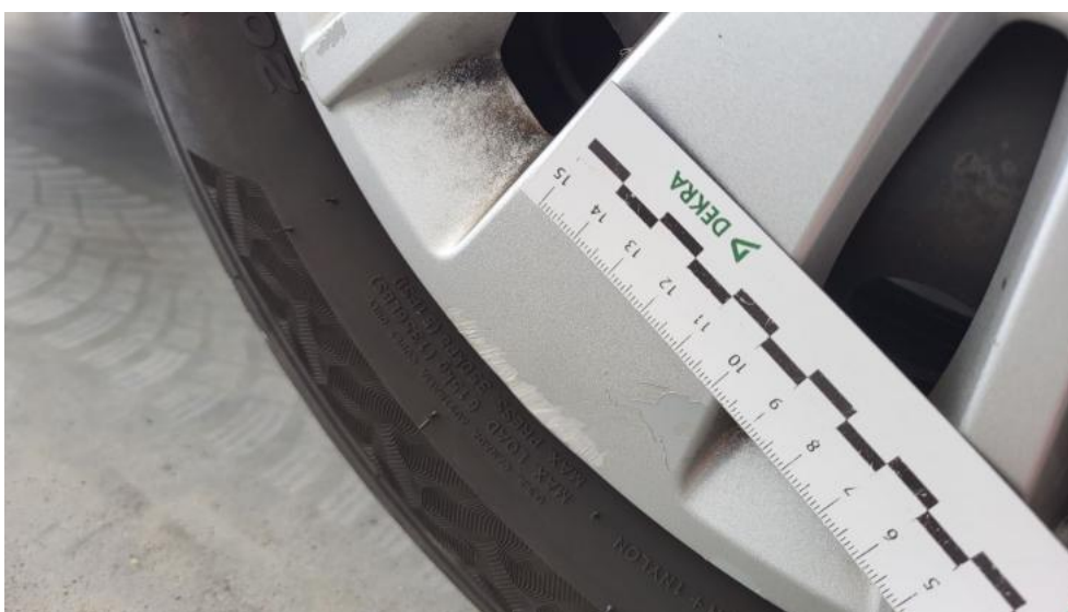
Fot. 60. Kołpak przedni P - Rysa/odprysk 1
