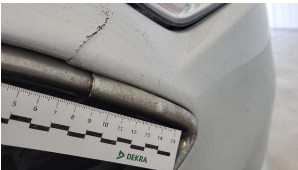
Fot. 44. Listwa śr zderzaka przedniego - Pęknięcie/rozerwanie 2
