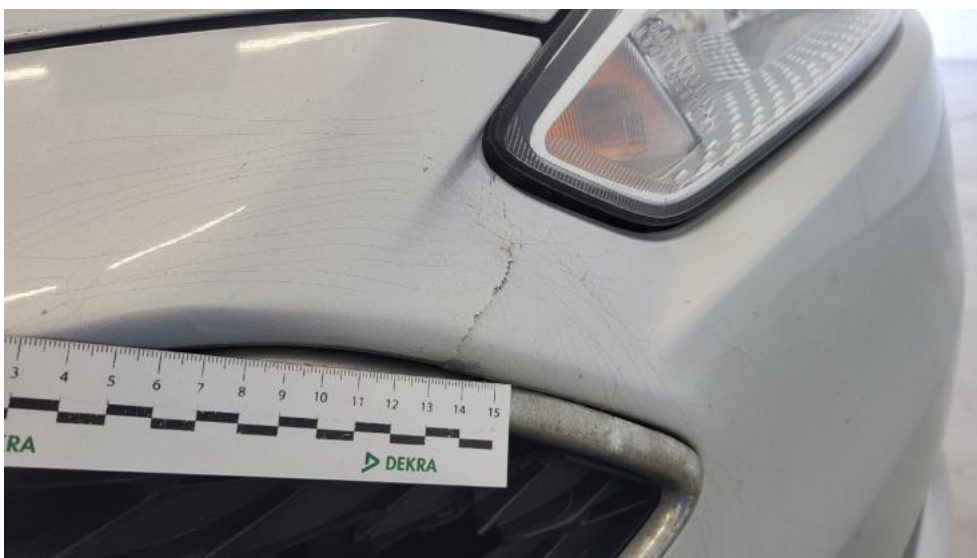
Fot. 54. Zderzak - Pęknięcie/rozerwanie 1
