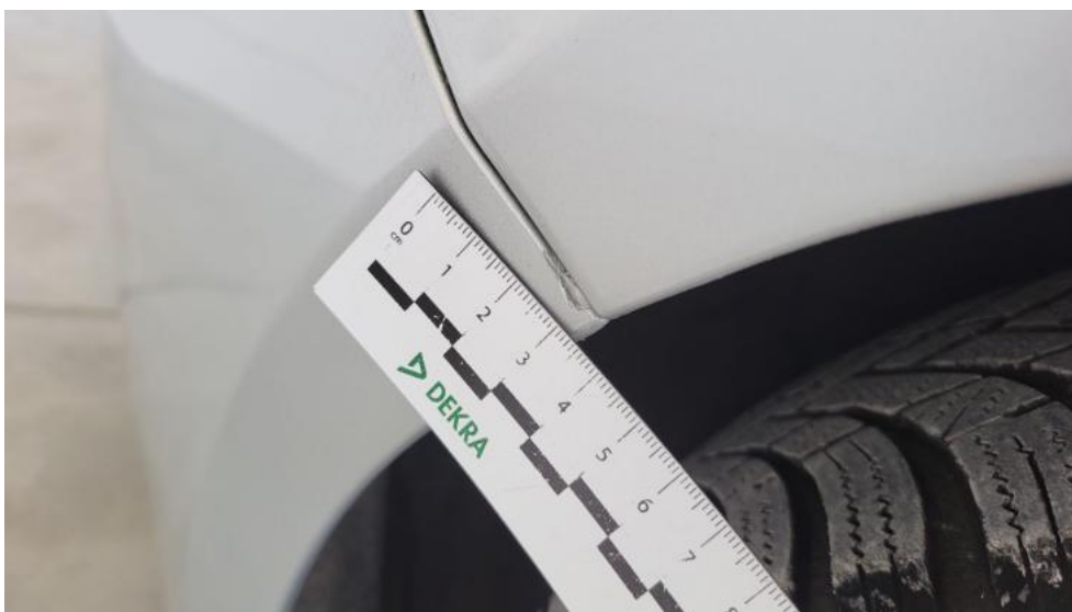
Fot. 50. Zderzak - Rysa/odprysk 1
