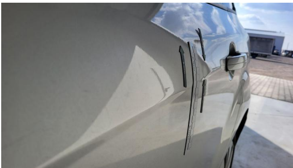
Fot. 81. Drzwi tylne L - Wgniecenie/odkształcenie 1
