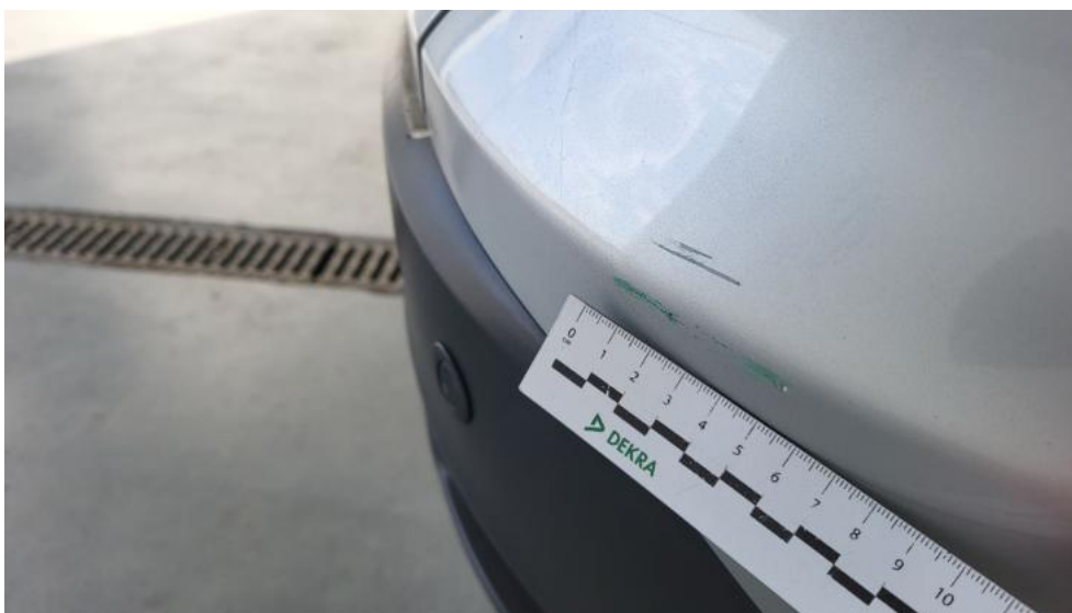
Fot. 73. Zderzak tylny cz P - Rysa/odprysk 2
