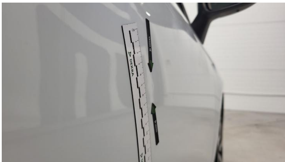
Photo 45. Drzwi przednie P - Wgniecenie/odkształcenie 1
