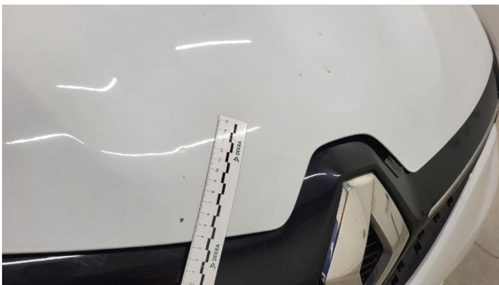
Photo 38. Pokrywa komory silnika - Rysa/odprysk 1
