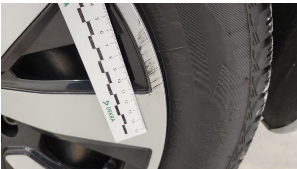
Photo 58. Kołpak tylny L - Rysa/odprysk 1
