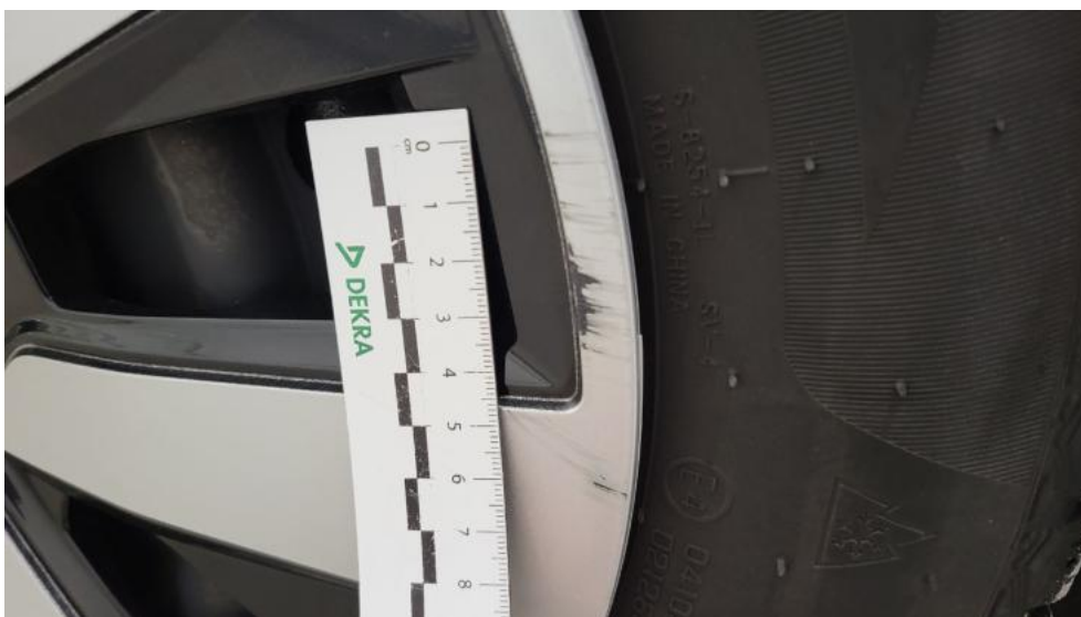
Photo 44. Kołpak przedni P - Rysa/odprysk 1
