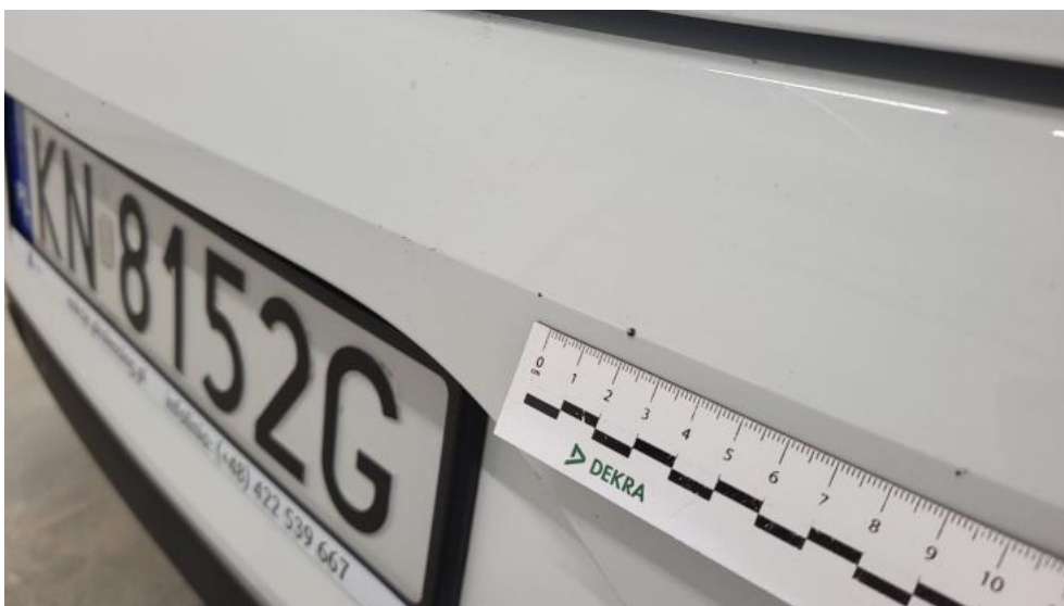
Photo 52. Zderzak tylny - Rysa/odprysk 1
