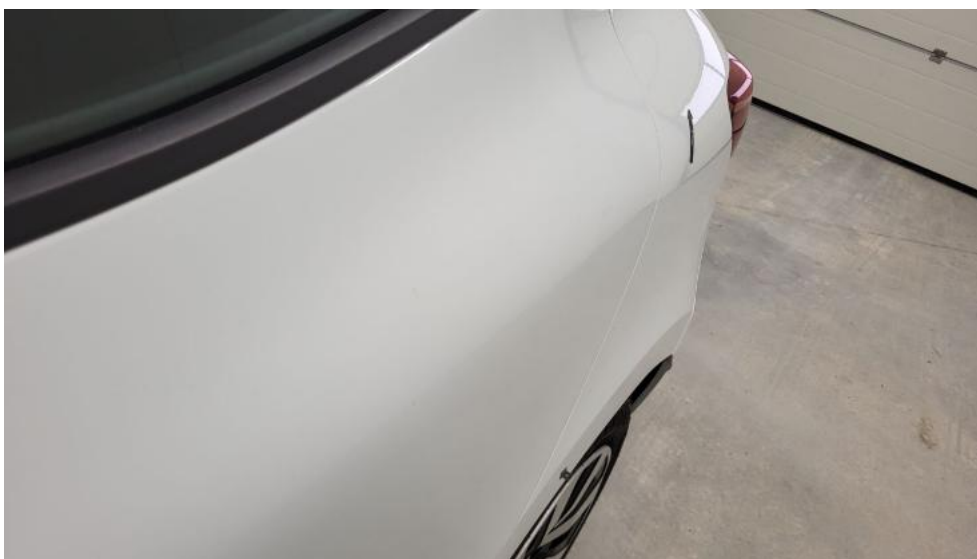
Photo 57. Błotnik tylny L / Ściana boczna L - Wgniecenie/odkształcenie 1
