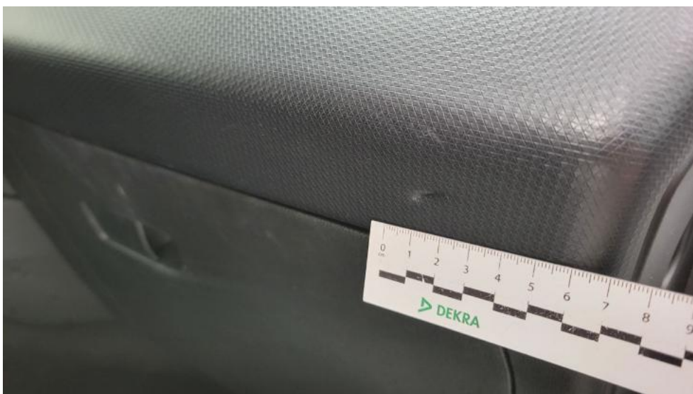
Photo 64. Deska rozdzielcza - Wgniecenie/odkształcenie 1
