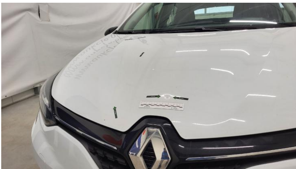
Photo 39. Pokrywa komory silnika - Wgniecenie/odkształcenie 1
