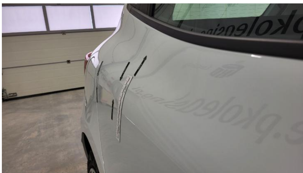
Photo 46. Drzwi przednie P - Wgniecenie/odkształcenie 2
