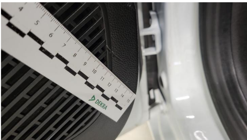
Photo 70. Tapicerka drzwi przednich L - Rysa/odprysk 1
