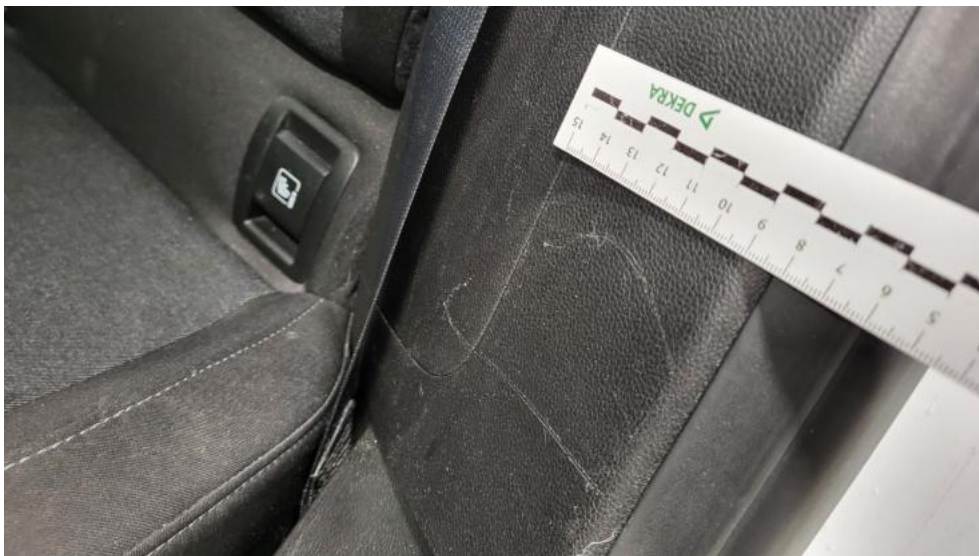
Photo 71. Wykładzina(y) słupka tylnego L - Rysa/odprysk 1
