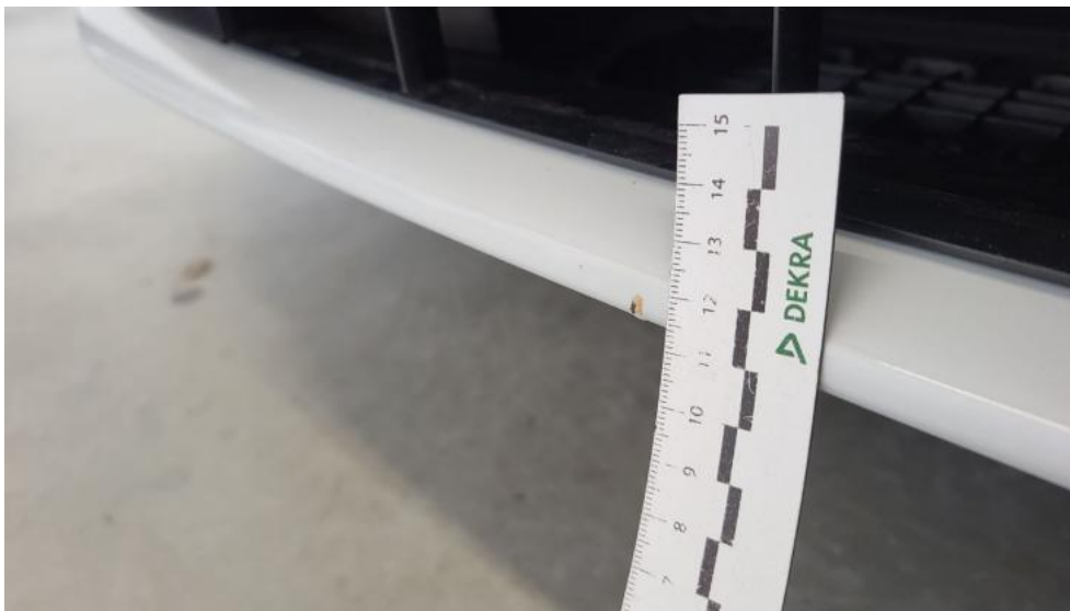
Fot. 41. Zderzak - Rysa/odprysk 1
