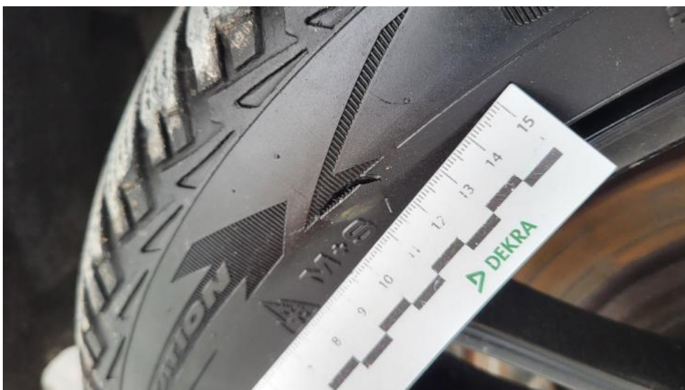
Fot. 46. Opona tylna P - Pęknięcie/rozerwanie 1
