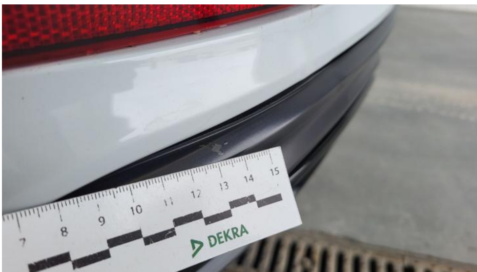
Fot. 48. Zderzak tylny cz dolna - Rysa/odprysk 1
