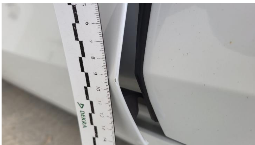
Fot. 52. Drzwi przed L - Rysa/odprysk 1
