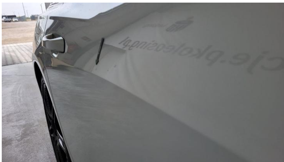
Fot. 44. Drzwi tylne P - Wgniecenie/odkształcenie 1
