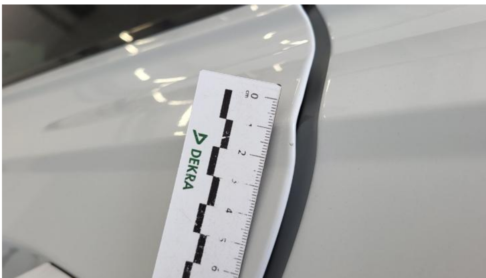
Fot. 53. Drzwi tylne L - Rysa/odprysk 1
