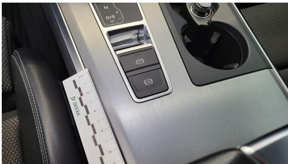
Fot. 57. Konsola tunelu śr. - Rysa/odprysk 1
