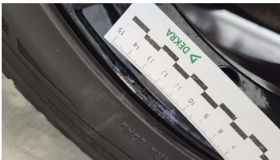
Fot. 56. Felga Aluminiowa przednia L - Rysa/odprysk 1
