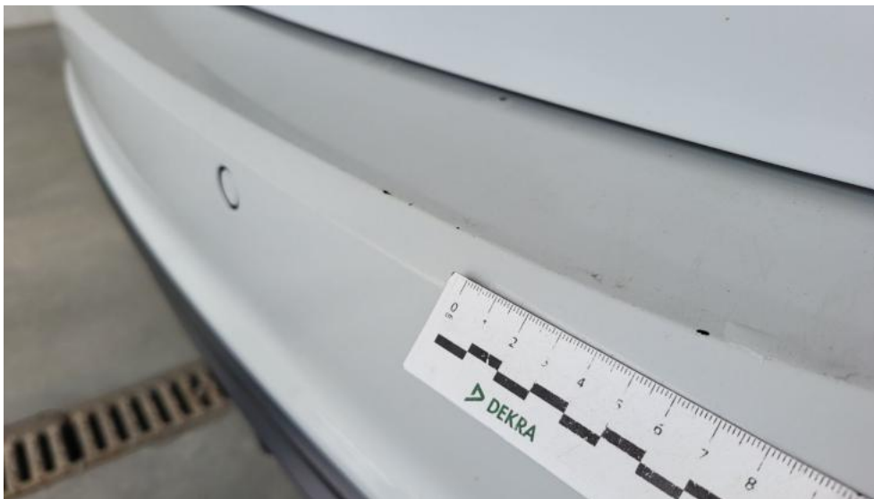
Fot. 47. Zderzak tylny - Rysa/odprysk 1
