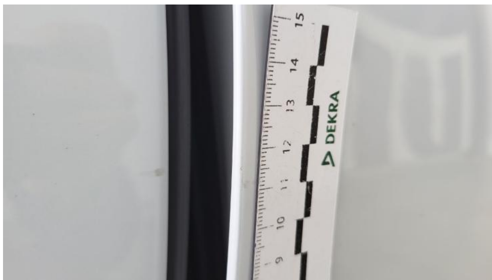
Fot. 43. Drzwi przednie P - Rysa/odprysk 1
