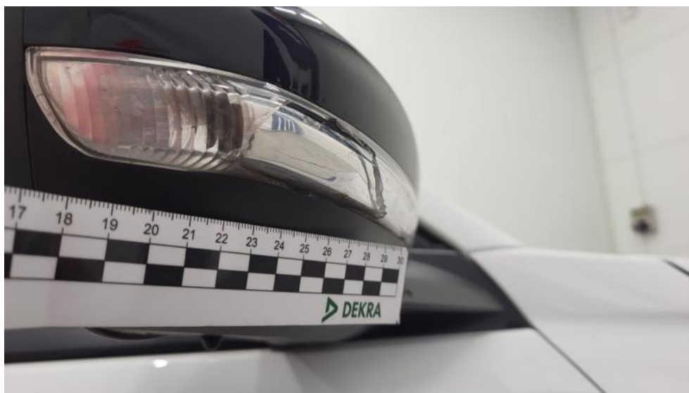
Photo 63. Lusterko zew P - Pęknięcie/rozerwanie 1
