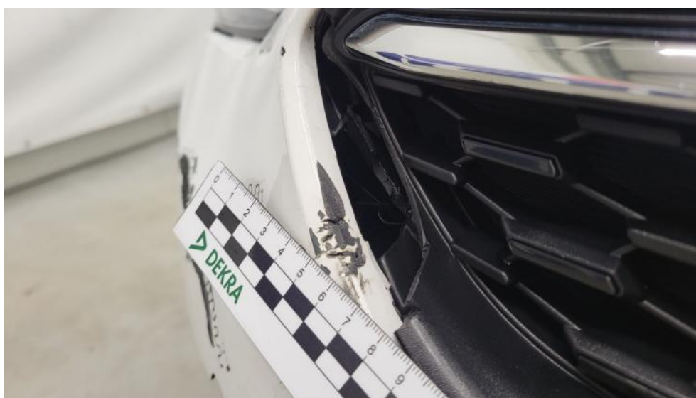
Photo 38. Atrapa przednia - Pęknięcie/rozerwanie 1
