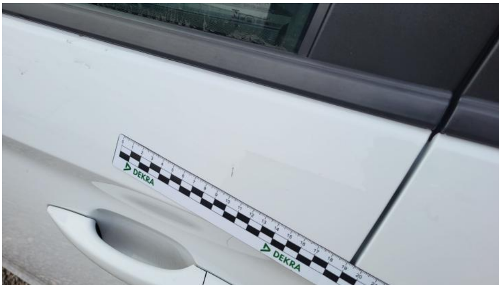
Photo 69. Drzwi przed L - Wgniecenie/odkształcenie 1
