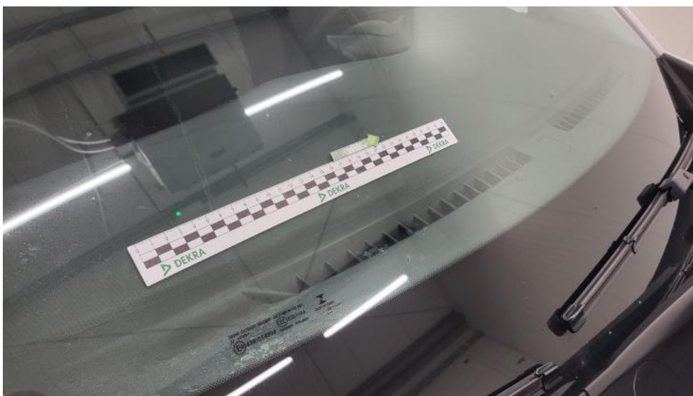
Photo 46. Szyba czołowa - Rysa/odprysk 1
