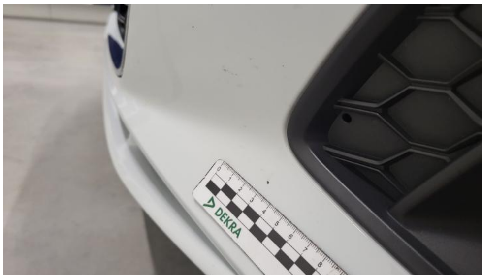
Fot. 41. Zderzak - Rysa/odprysk 1
