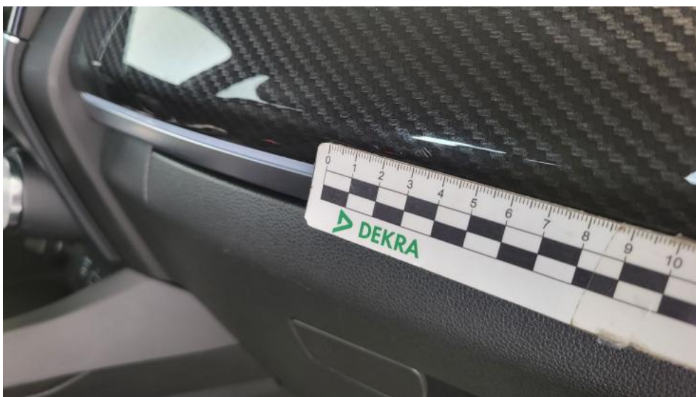
Photo 52. Deska rozdzielcza - Rysa/odprysk 1
