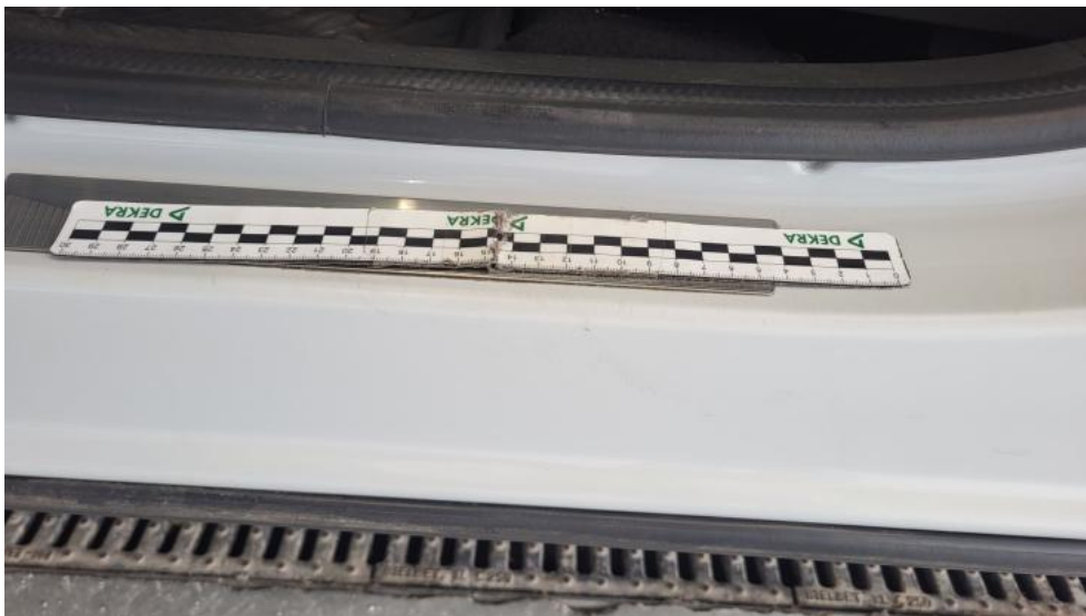
Photo 51. Próg L - Rysa/odprysk 1
