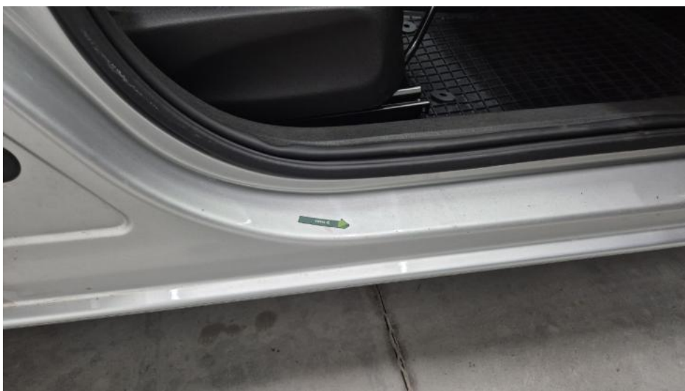
Photo 42. Próg P - Wgniecenie/odkształcenie 1
