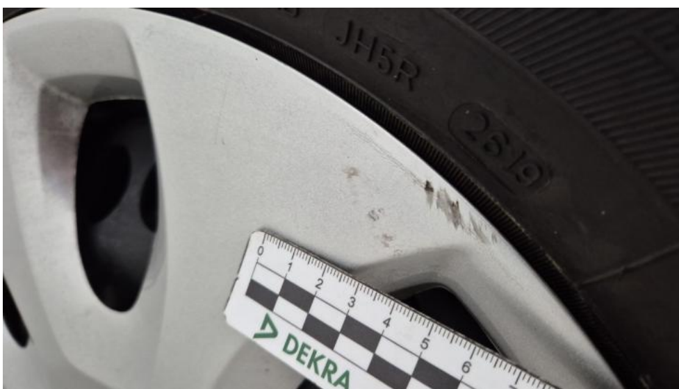
Photo 36. Kołpak przedni P - Rysa/odprysk 1
