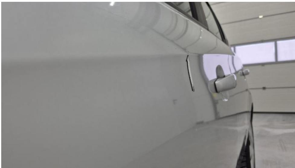
Photo 53. Drzwi przed L - Wgniecenie/odkształcenie 1
