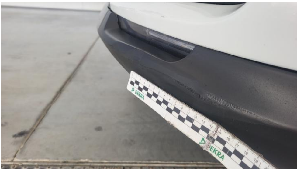
Photo 41. Zderzak przedni cz L - Wgniecenie/odkształcenie 1
