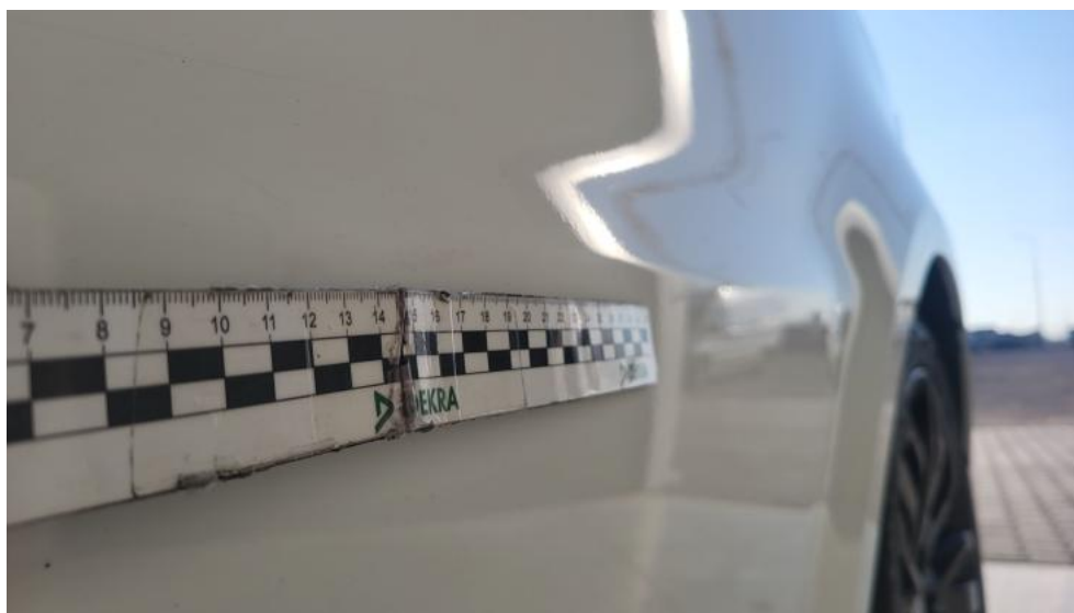
Photo 63. Drzwi tylne L - Wgniecenie/odkształcenie 1
