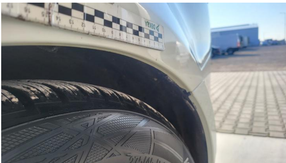
Photo 57. Błotnik tylny L / Ściana boczna L - Wgniecenie/odkształcenie 1
