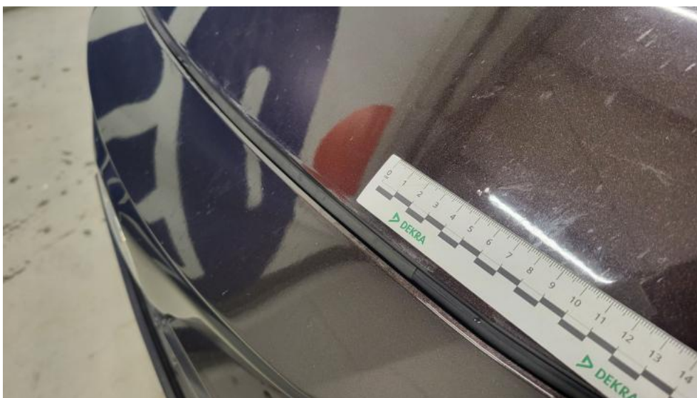
Photo 36. Pokrywa komory silnika - Rysa/odprysk 1
