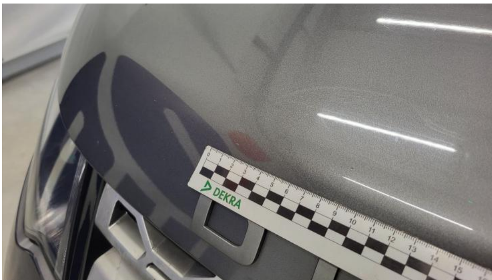
Fot. 44. Pokrywa komory silnika - Rysa/odprysk 1
