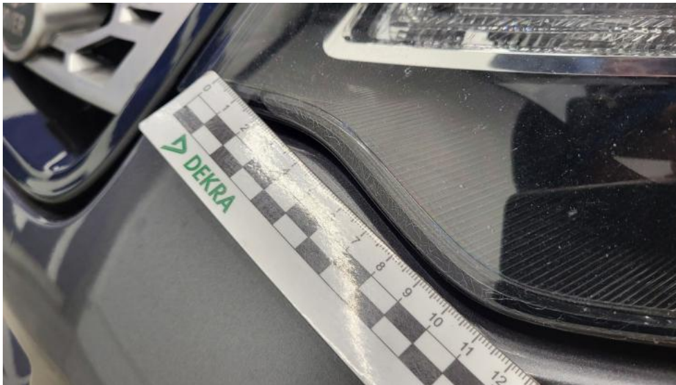
Fot. 65. Reflektor L - Pęknięcie/rozerwanie 1
