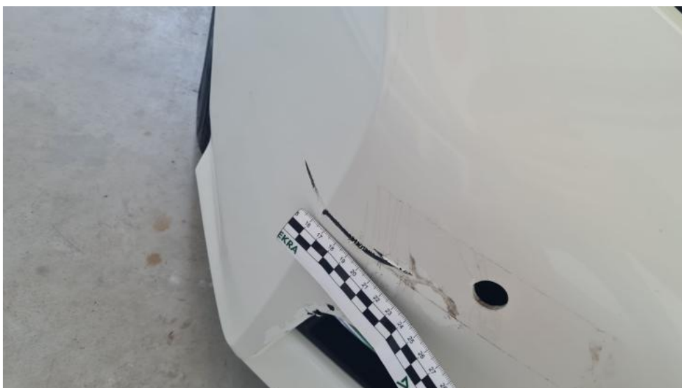
Fot. 42. Zderzak - Rysa/odprysk 1
