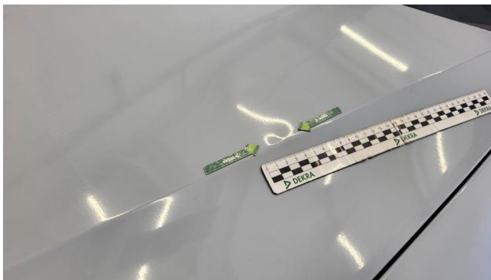
Fot. 43. Pokrywa komory silnika - Wgniecenie/odkształcenie 1
