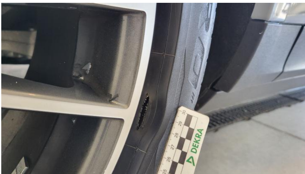
Fot. 76. Opona przednia L - Pęknięcie/rozerwanie 1
