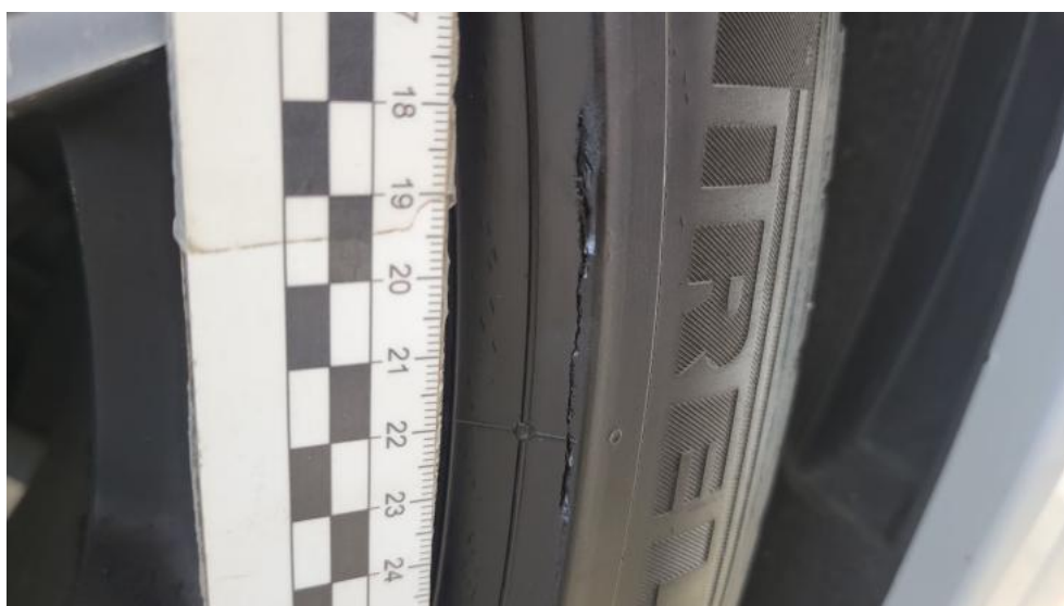
Fot. 52. Opona przednia P - Pęknięcie/rozerwanie 1
