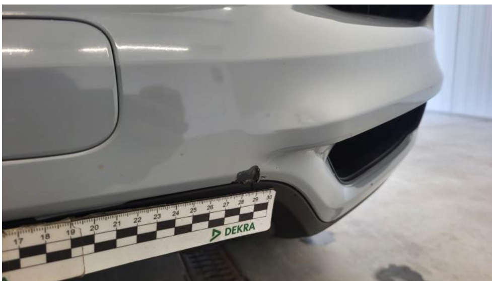
Fot. 45. Zderzak() - Rysa/odprysk 3
