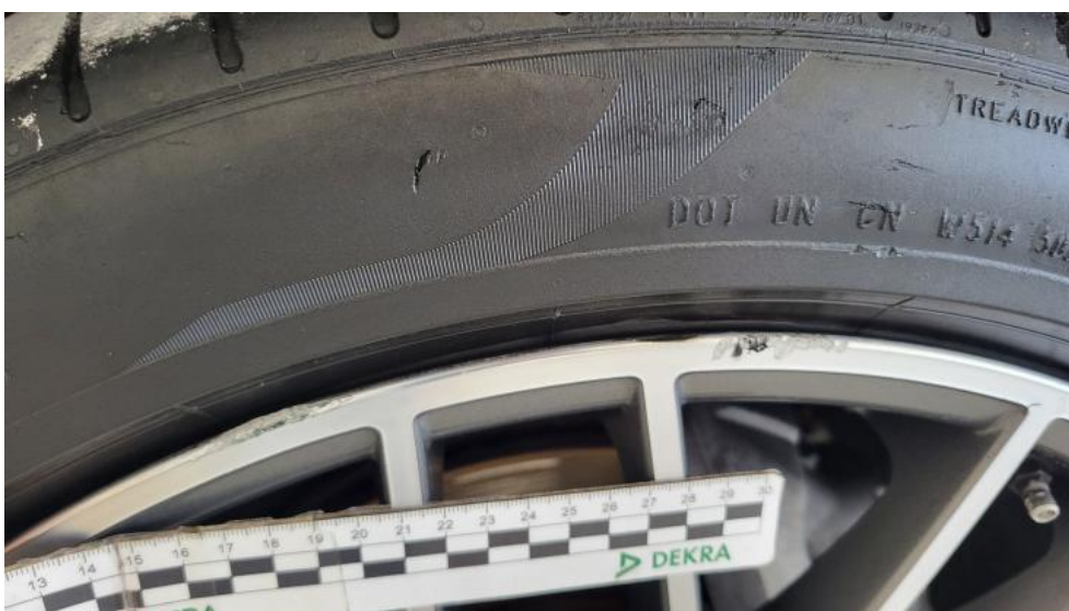
Fot. 74. Felga Aluminiowa przednia L - Rysa/odprysk 1
