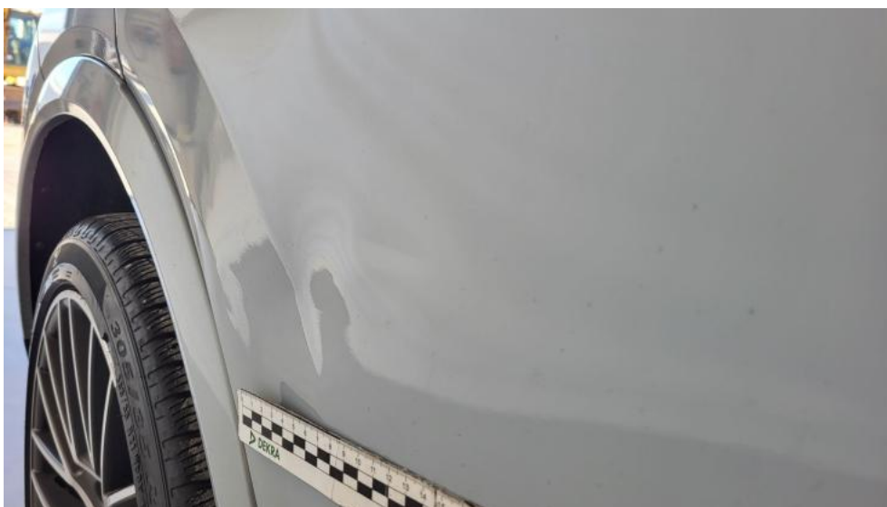
Fot. 57. Drzwi tylne P - Wgniecenie/odkształcenie 2
