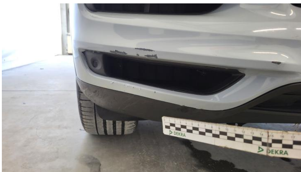
Fot. 44. Zderzak - Rysa/odprysk 1
