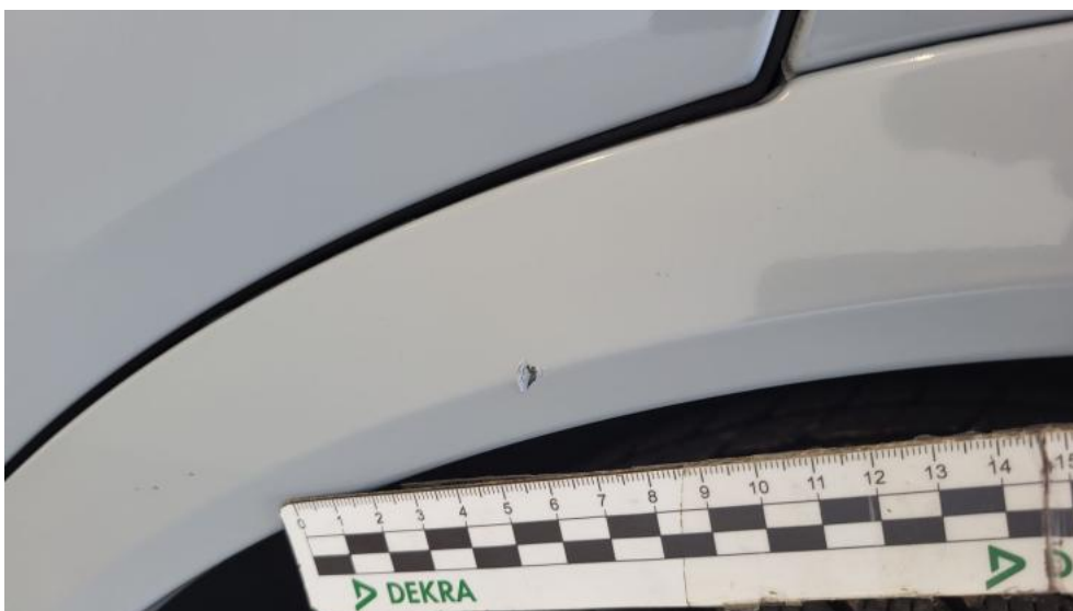
Fot. 66. Listwa krawędzi błotnika tył L - Rysa/odprysk 1
