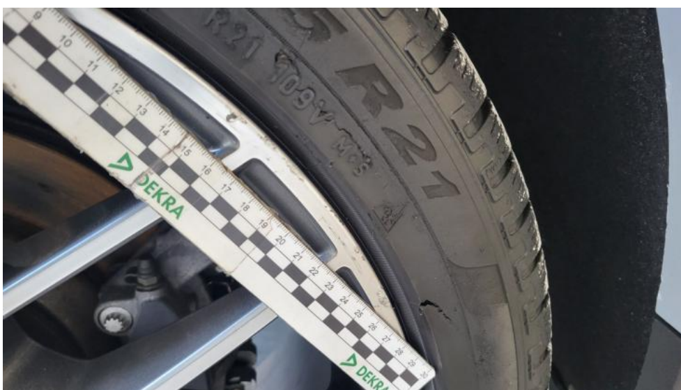
Fot. 62. Opona tylna P - Pęknięcie/rozerwanie 1
