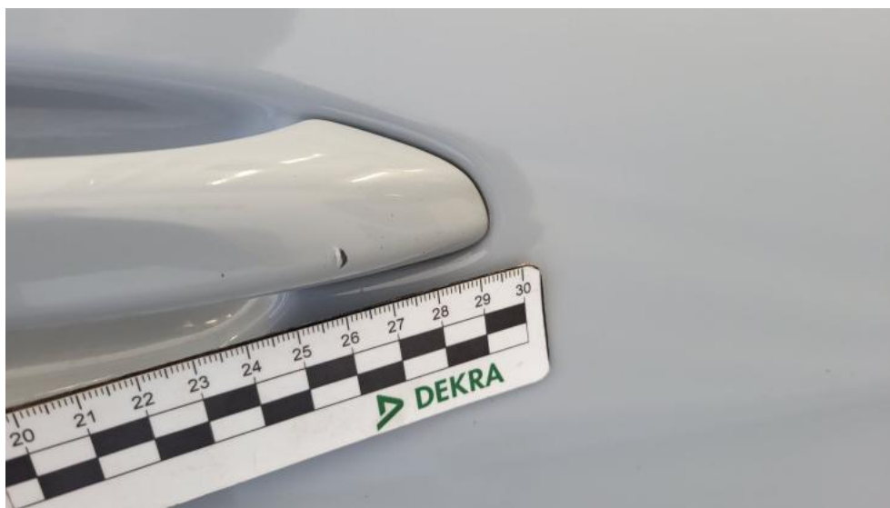
Fot. 53. Drzwi przednie P - Rysa/odprysk 1
