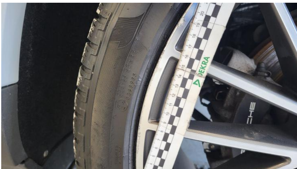
Fot. 65. Felga aluminiowa tylna L - Rysa/odprysk 1
