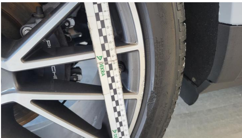
Fot. 61. Felga aluminiowa tylna P - Rysa/odprysk 2
