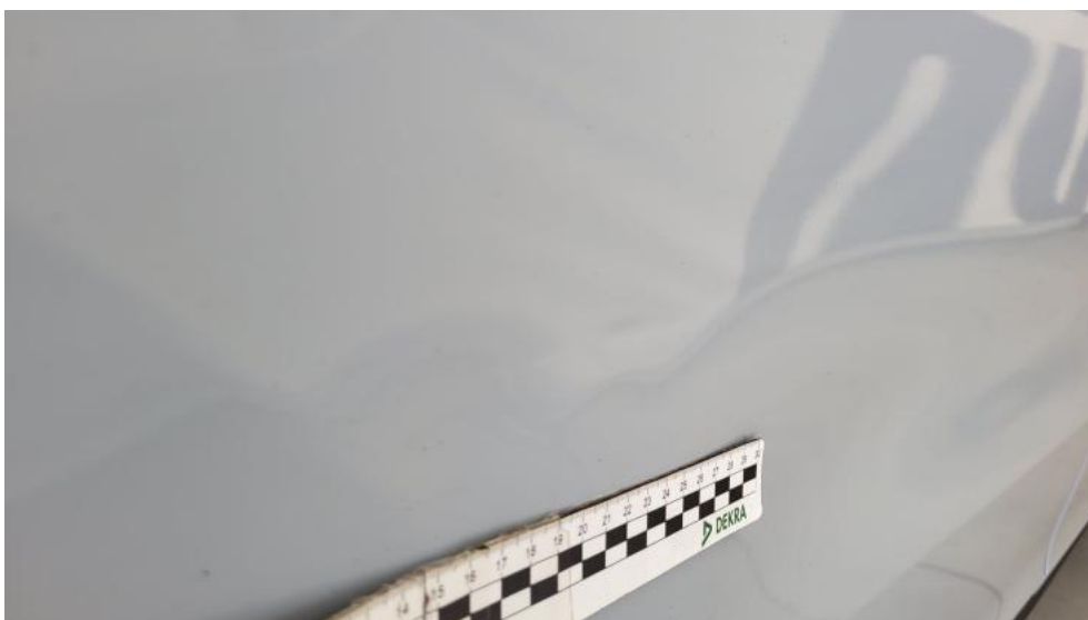
Fot. 58. Drzwi tylne P() - Wgniecenie/odkształcenie 3
