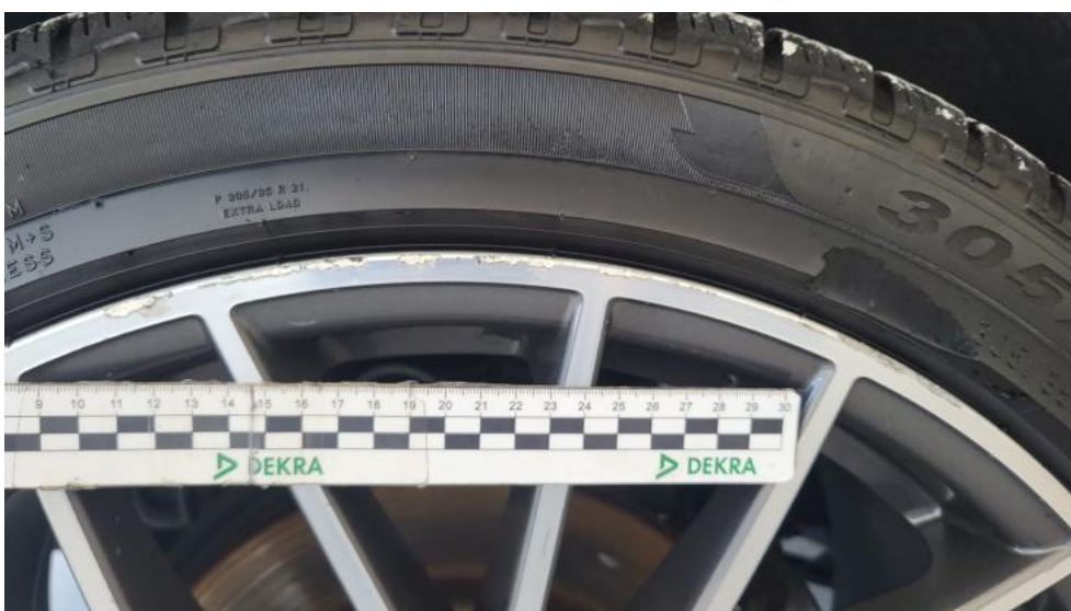
Fot. 60. Felga aluminiowa tylna P - Rysa/odprysk 1
