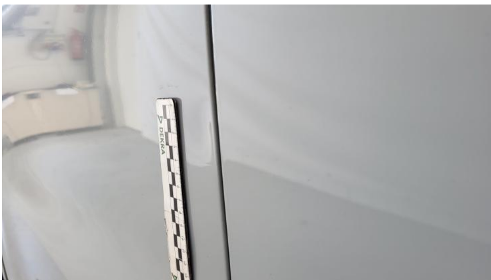
Fot. 56. Drzwi tylne P - Wgniecenie/odkształcenie 1
