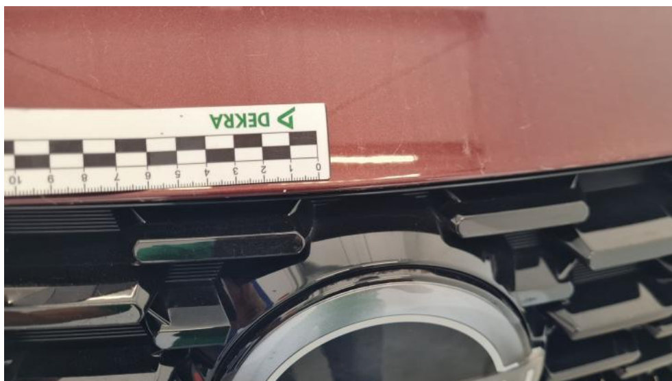
Photo 34. Pokrywa komory silnika - Rysa/odprysk 1
