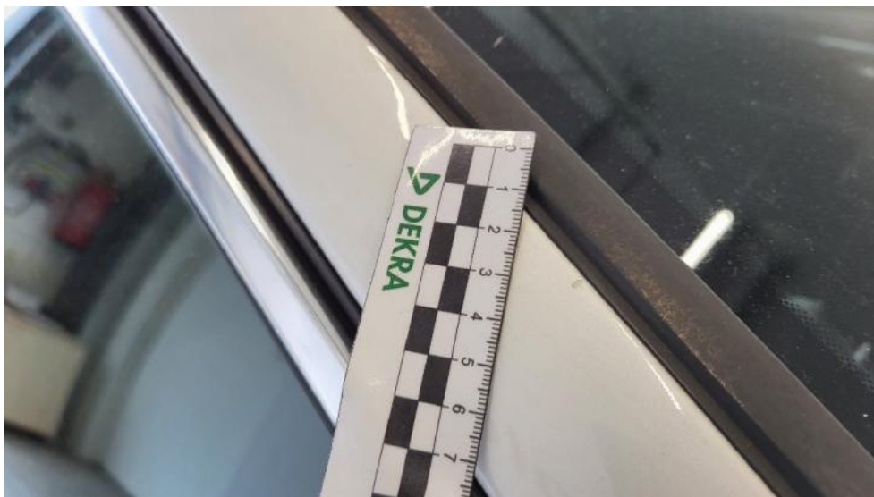
Fot. 27. Słupek przedni prawy (Rysa/Odprysk)
