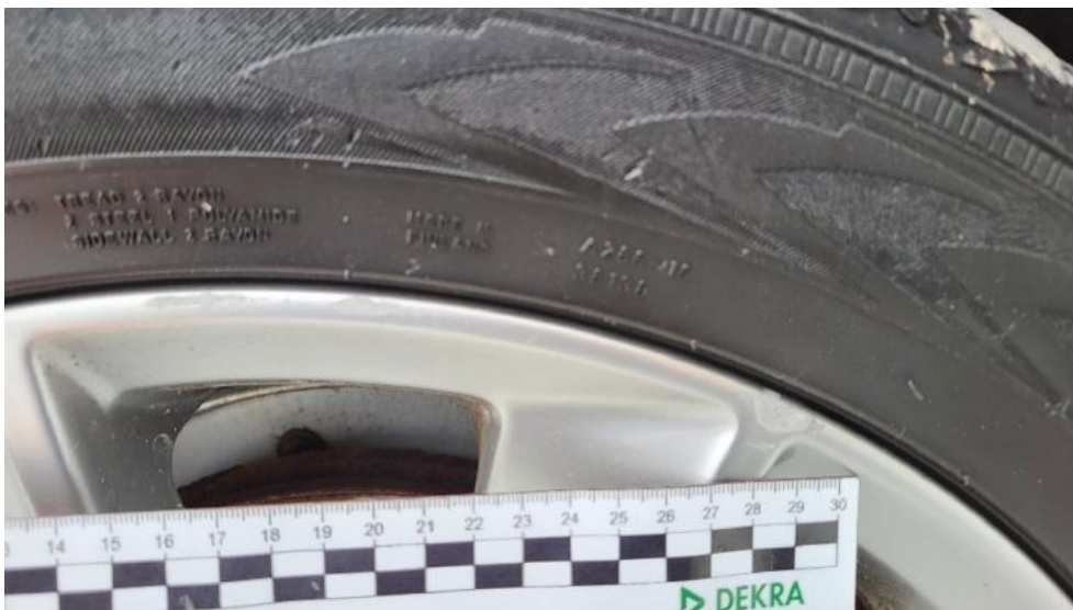
Fot. 34. Felga przednia lewa (Rysa/Odprysk)
