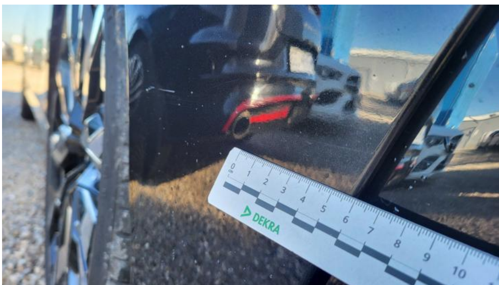
Fot. 52. Zderzak - Wgniecenie/odkształcenie 2
