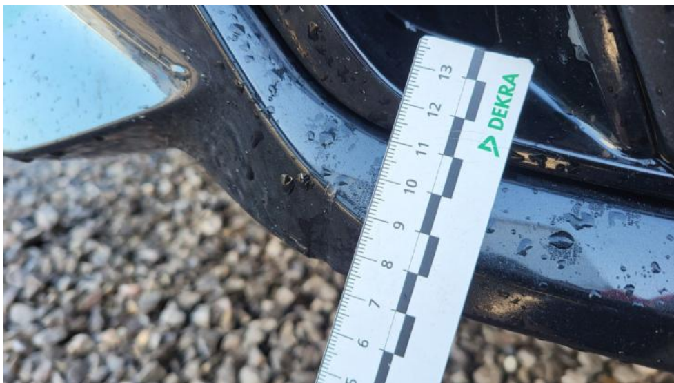
Fot. 51. Zderzak - Wgniecenie/odkształcenie 1
