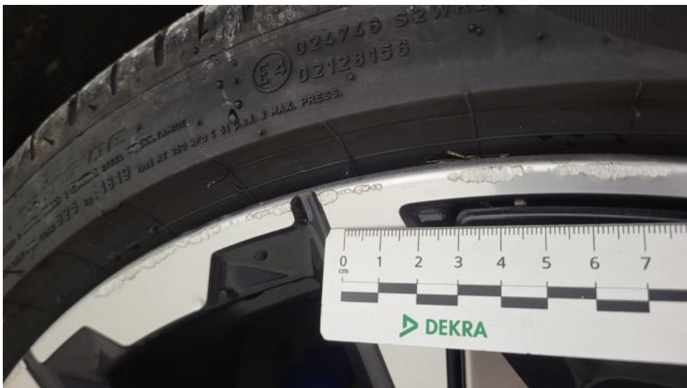
Fot. 54. Felga aluminiowa przednia P - Rysa/odprysk 1
