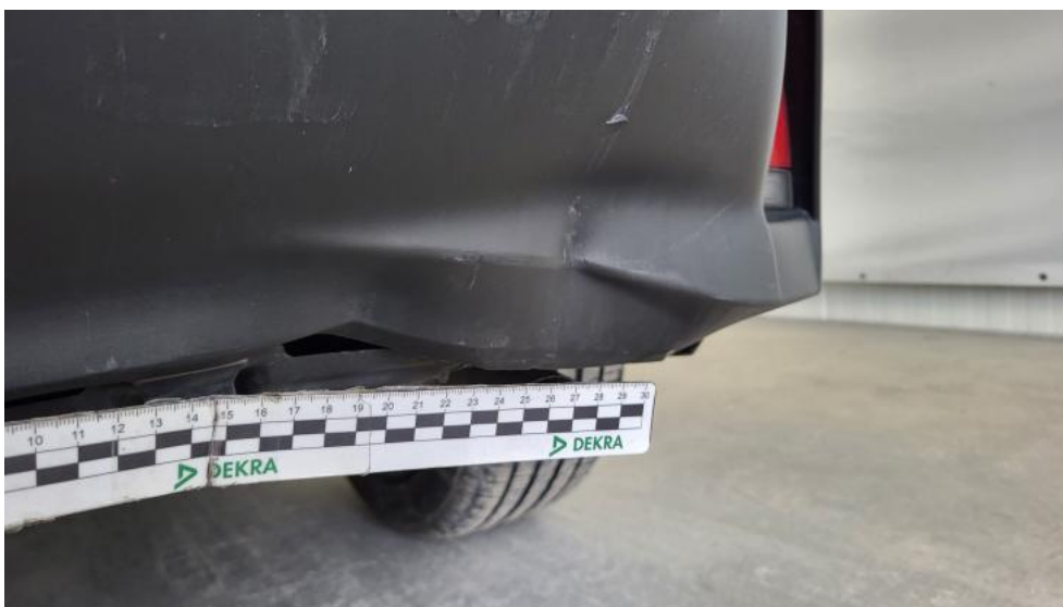
Fot. 60. Zderzak tylny cz dolna - Wgniecenie/odkształcenie 2
