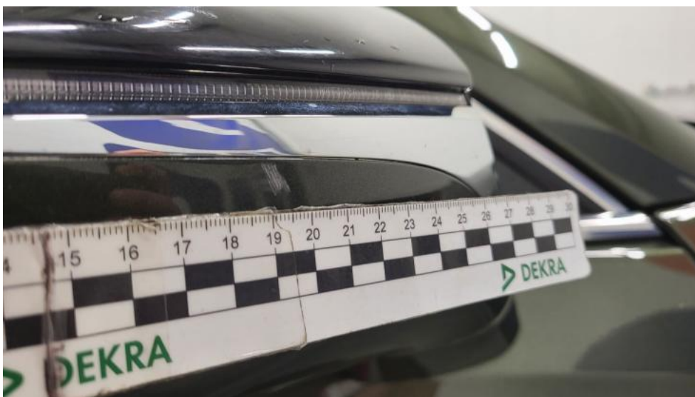
Fot. 49. Lusterko zew P - Rysa/odprysk 1
