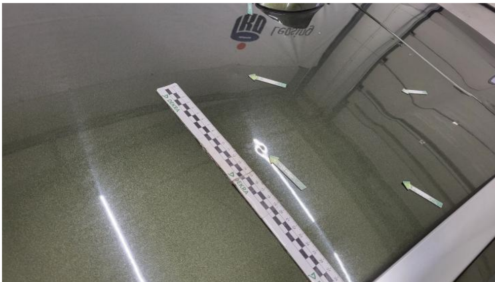
Fot. 65. Dach - Wgniecenie/odkształcenie 2
