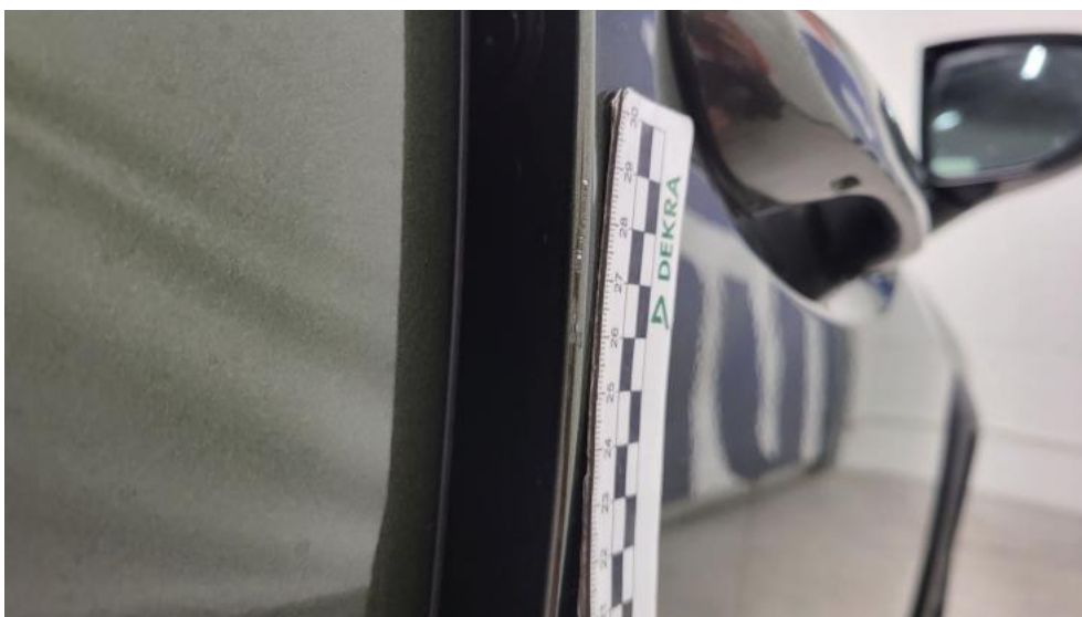
Fot. 44. Drzwi przednie P - Rysa/odprysk 1
