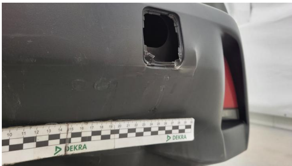
Fot. 63. Zderzak tylny cz dolna() - Pęknięcie/rozerwanie 3
