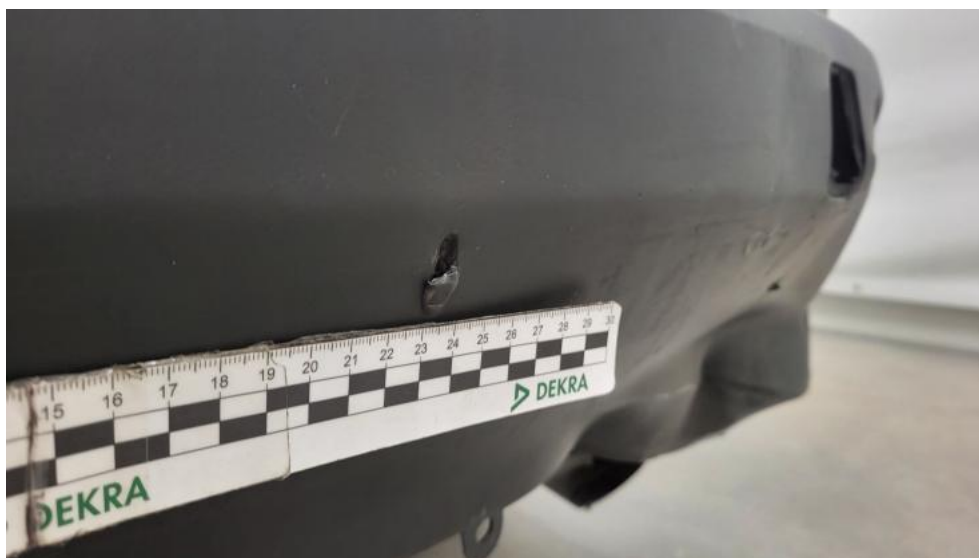
Fot. 62. Zderzak tylny cz dolna - Pęknięcie/rozerwanie 2
