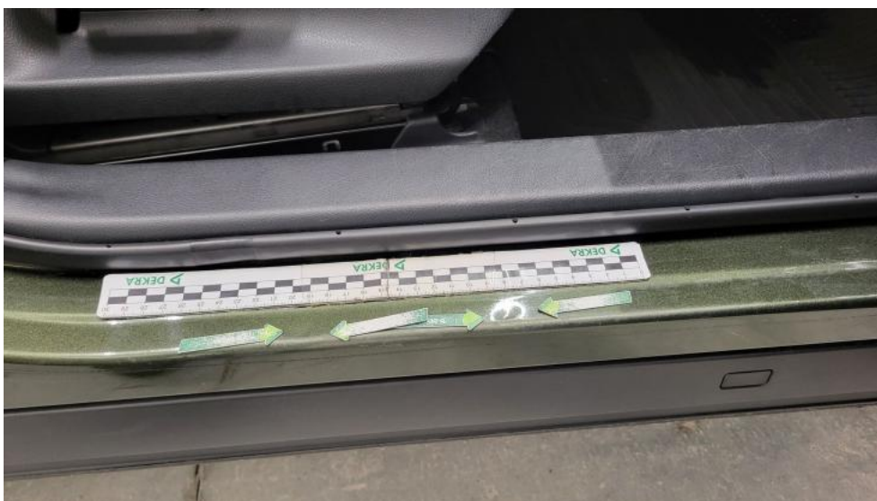
Fot. 50. Próg P - Wgniecenie/odkształcenie 1
