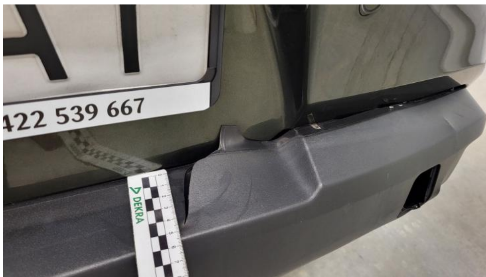
Fot. 61. Zderzak tylny cz dolna - Pęknięcie/rozerwanie 1
