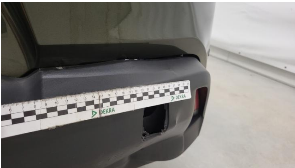
Fot. 59. Zderzak tylny cz dolna - Wgniecenie/odkształcenie 1
