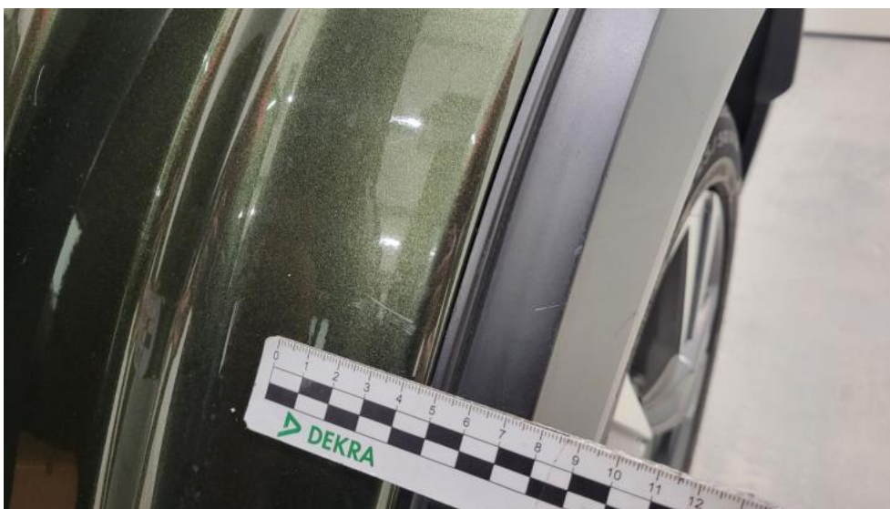
Fot. 67. Błotnik tylny L / Ściana boczna L - Rysa/odprysk 1
