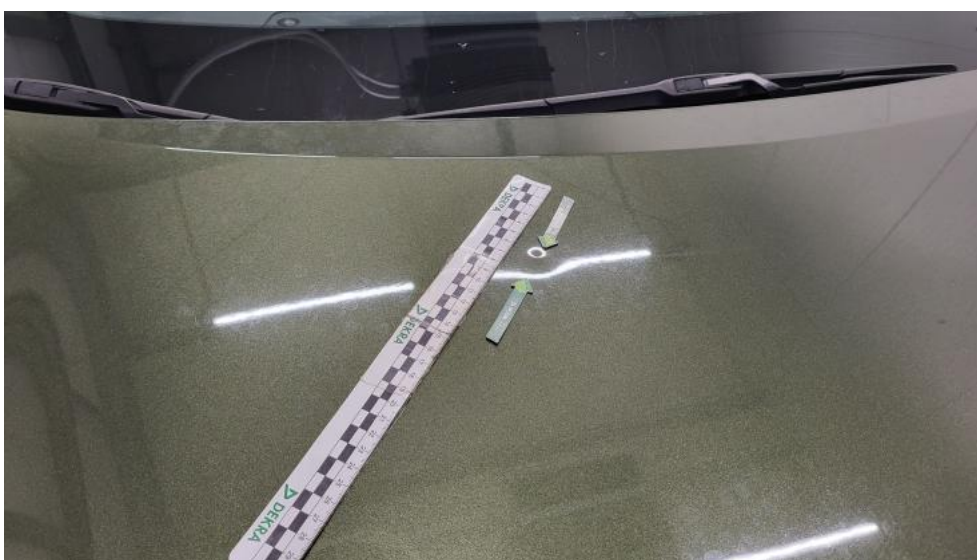
Fot. 54. Pokrywy przód - Wgniecenie/odkształcenie 2
