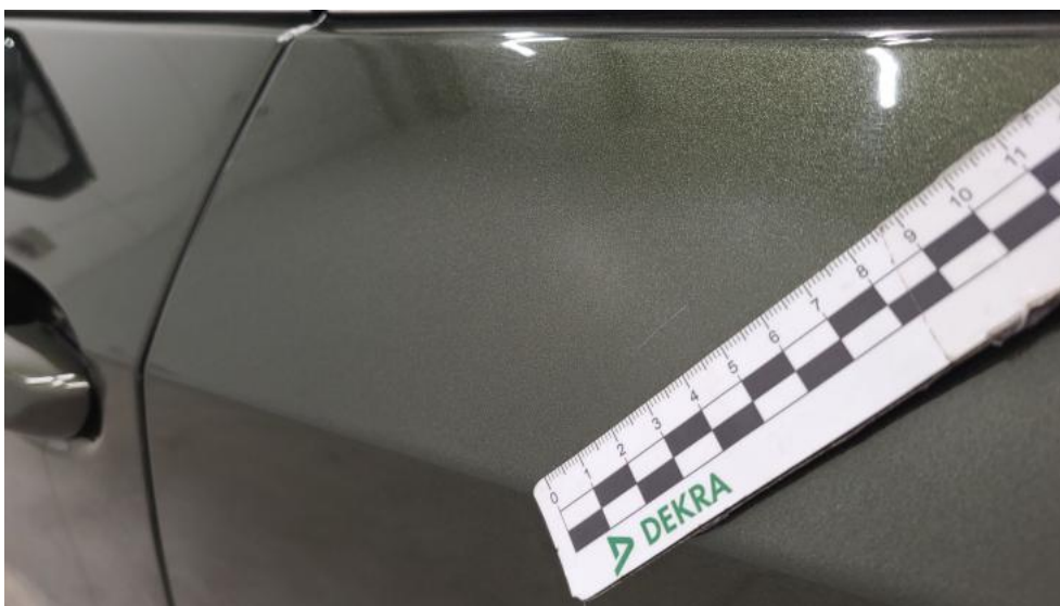
Fot. 71. Drzwi tylne L - Rysa/odprysk 1
