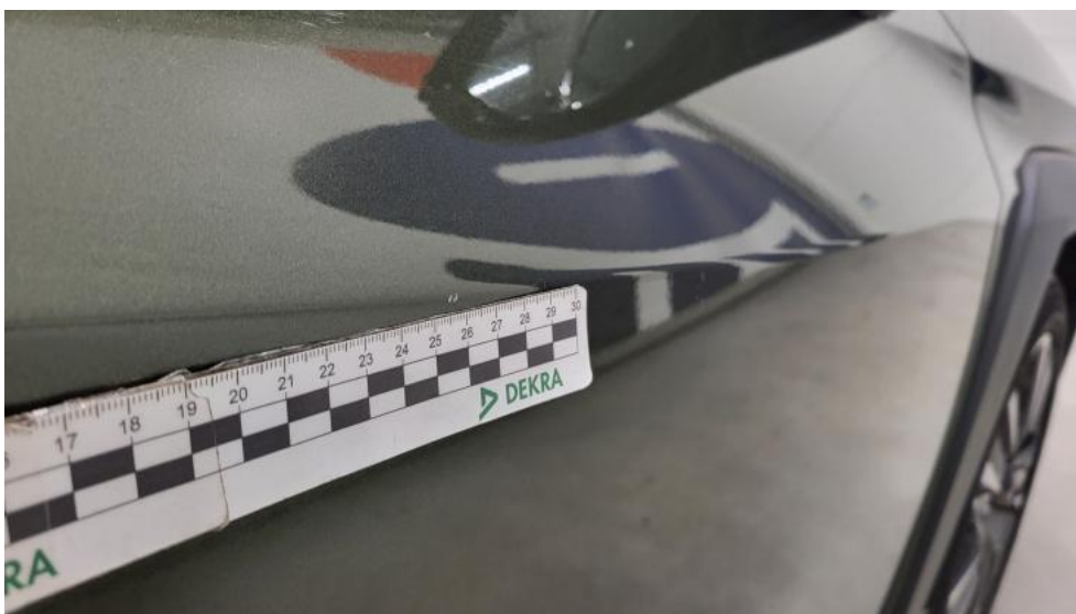
Fot. 46. Drzwi przednie P() - Rysa/odprysk 3
