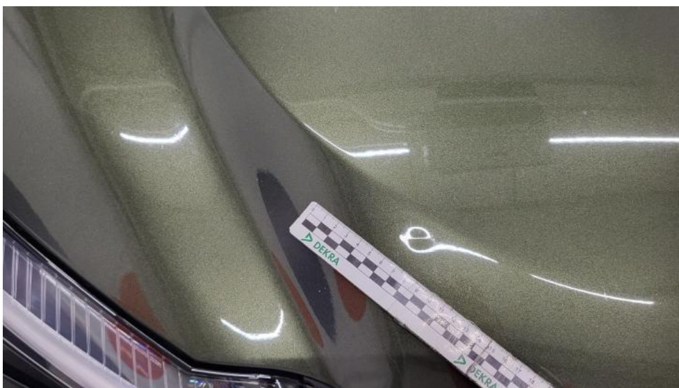
Fot. 53. Pokrywy przód - Wgniecenie/odkształcenie 1
