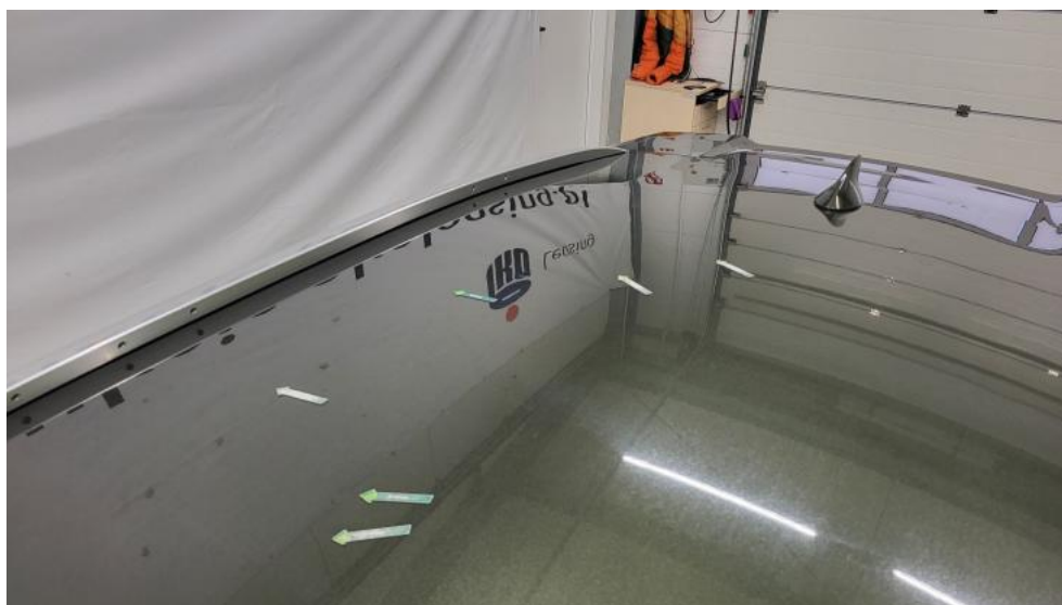
Fot. 64. Dach - Wgniecenie/odkształcenie 1
