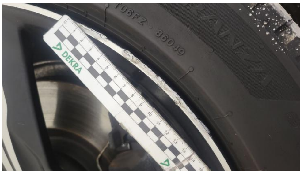
Photo 49. Felga aluminiowa przednia P - Rysa/odprysk 1
