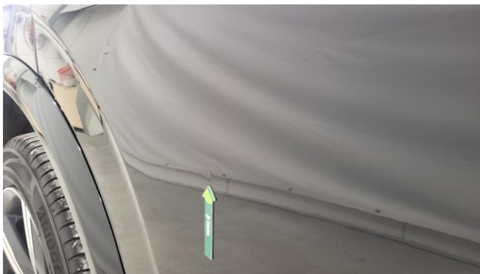
Photo 50. Drzwi tylne P - Wgniecenie/odkształcenie 1
