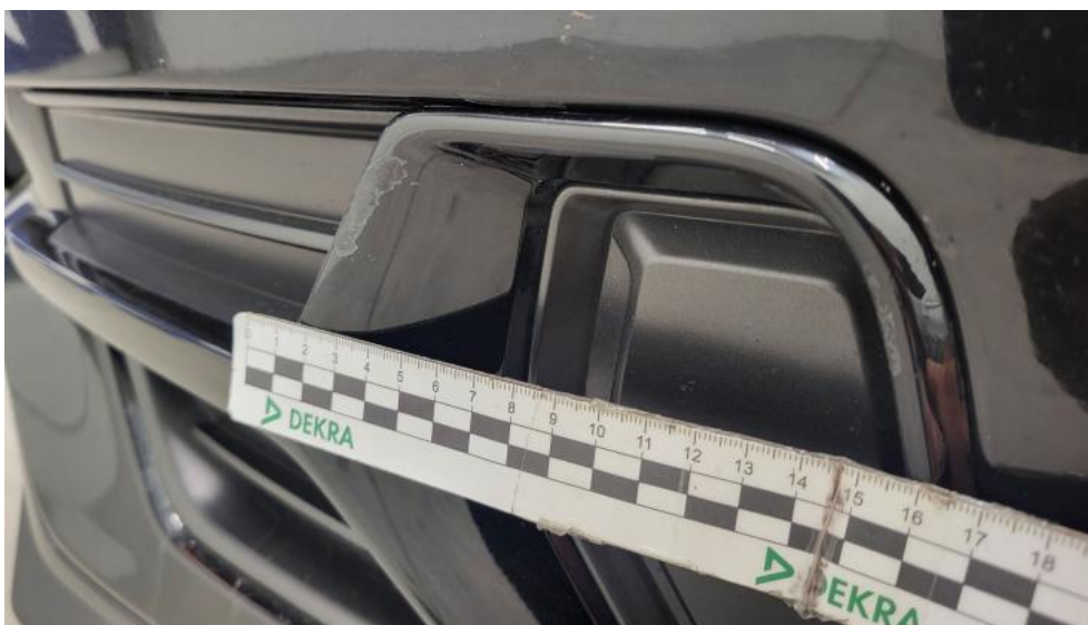
Photo 43. Kratka/zaślepka halogenu L - Rysa/odprysk 1
