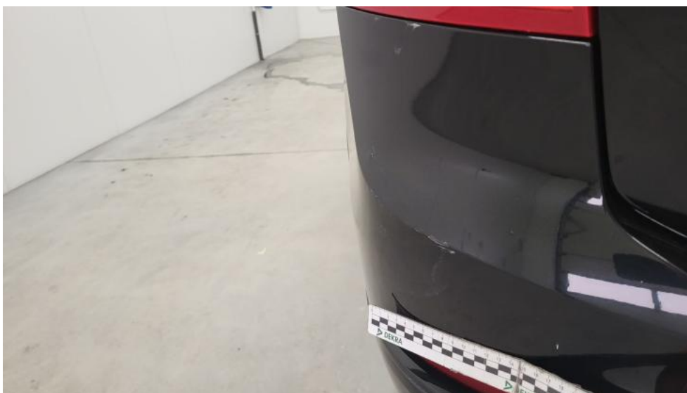
Photo 53. Zderzak tylny - Rysa/odprysk 2
