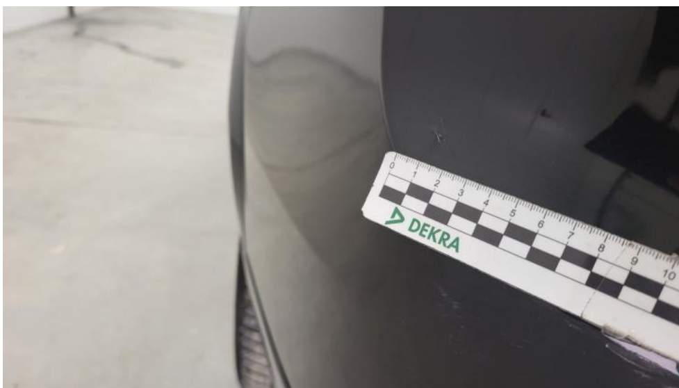
Photo 56. Zderzak tylny() - Wgniecenie/odkształcenie 3
