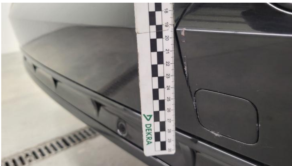
Photo 52. Zderzak tylny - Rysa/odprysk 1
