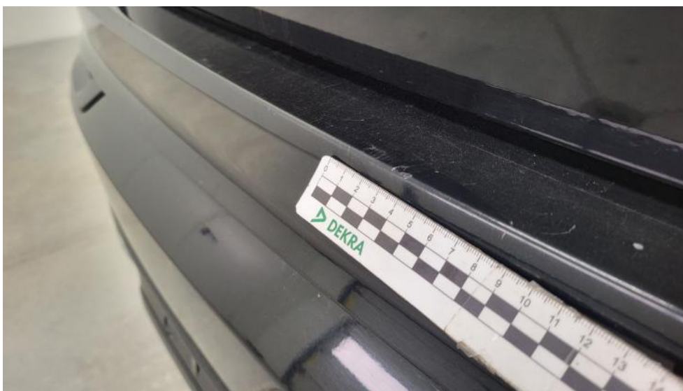
Photo 55. Zderzak tylny - Wgniecenie/odkształcenie 2
