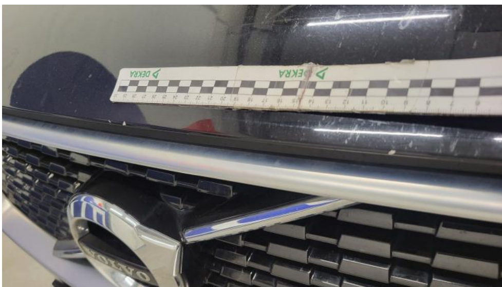
Photo 44. Pokrywa komory silnika - Rysa/odprysk 1
