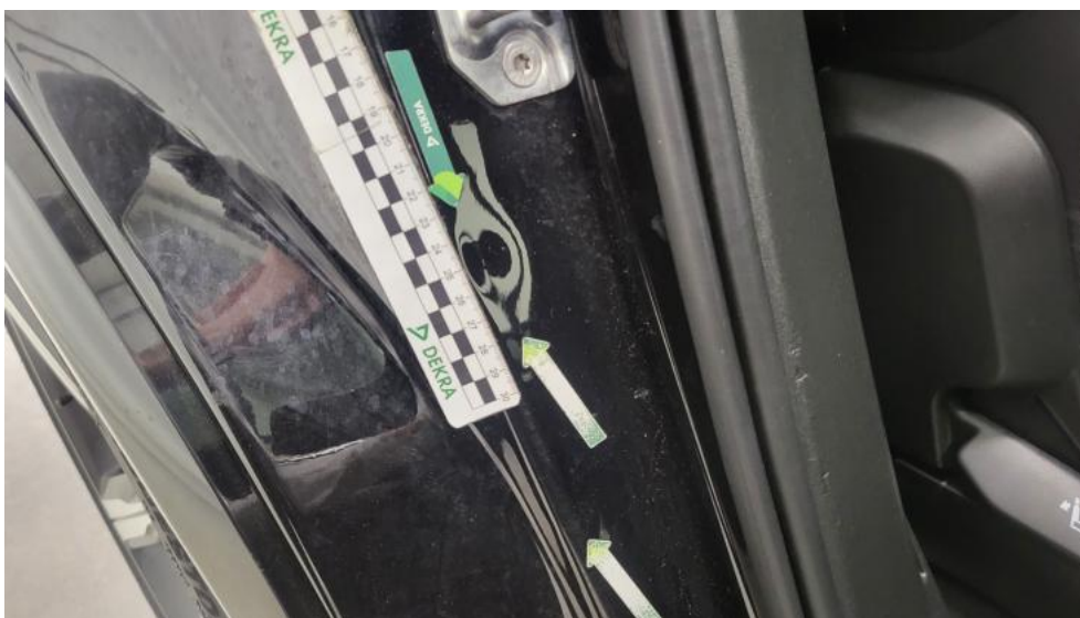
Photo 51. Błotnik tylny P / Ściana boczna P - Wgniecenie/odkształcenie 1
