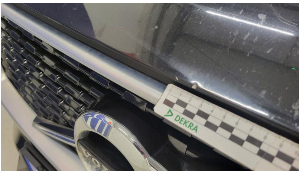
Photo 45. Pokrywa komory silnika - Wgniecenie/odkształcenie 1
