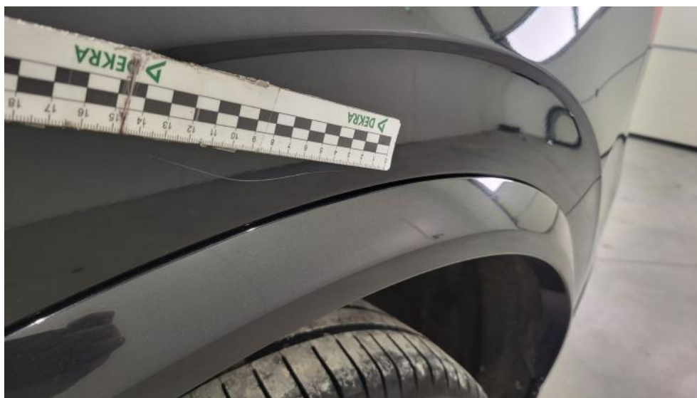
Photo 59. Błotnik tylny L / Ściana boczna L - Rysa/odprysk 1
