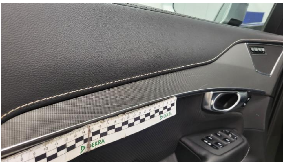
Photo 70. Tapicerka drzwi przednich L - Rysa/odprysk 1
