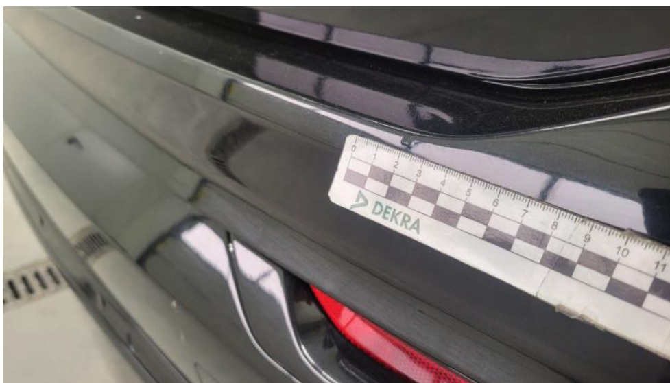
Photo 54. Zderzak tylny - Wgniecenie/odkształcenie 1
