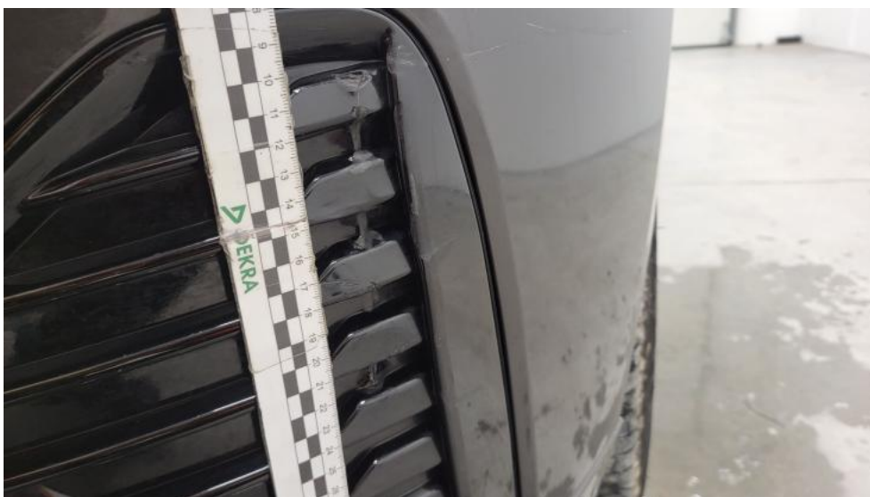
Fot. 38. Kratka/zaślepka halogenu L - Rysa/odprysk 1
