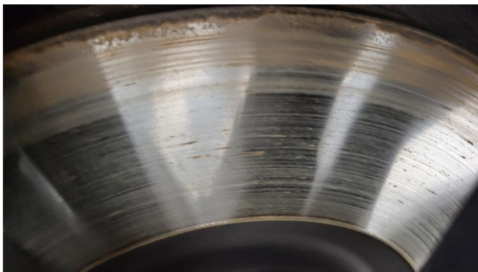
Fot. 17. Tarcza hamulcowa przednia lewa
