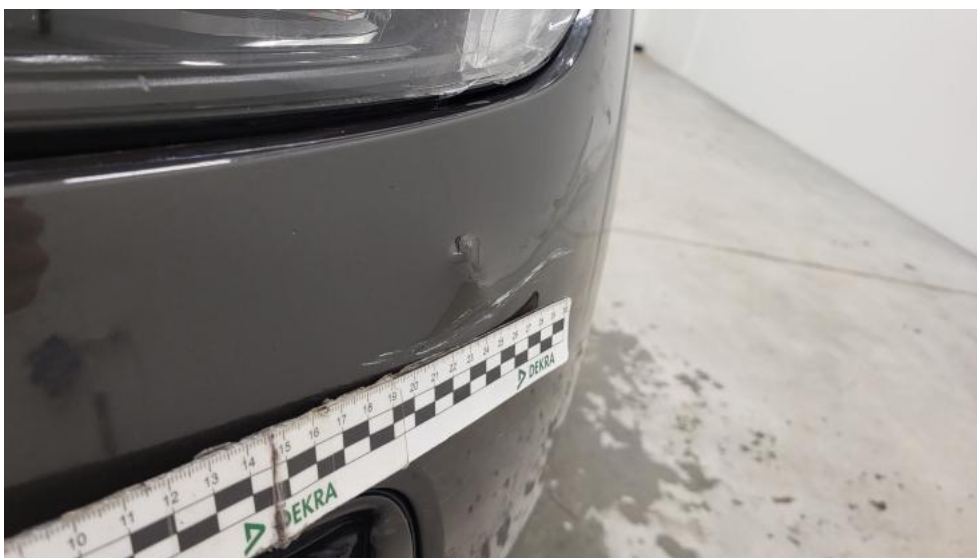
Fot. 44. Zderzak - Wgniecenie/odkształcenie 1
