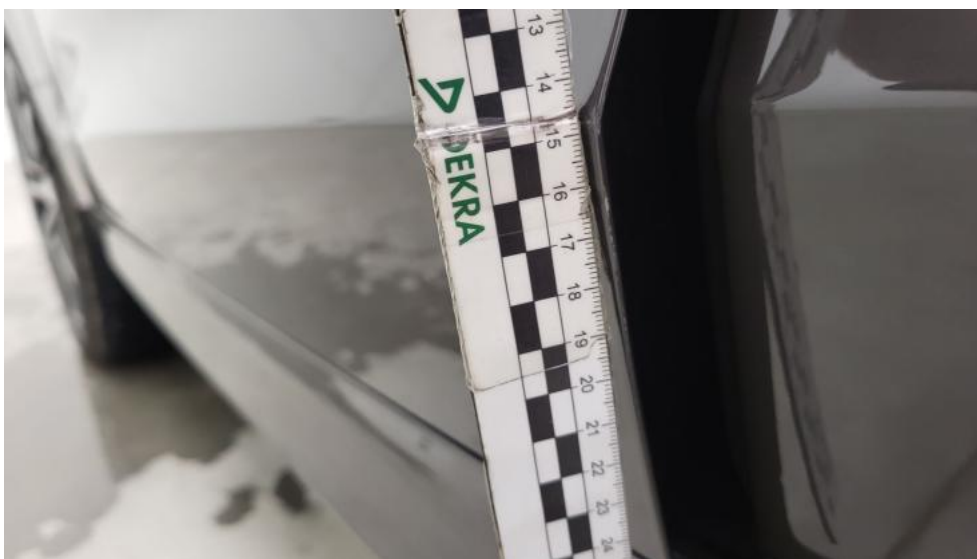
Fot. 51. Drzwi przed L - Rysa/odprysk 1
