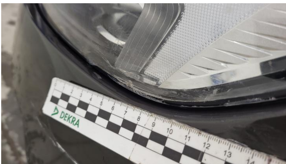
Fot. 54. Reflektor L - Rysa/odprysk 1
