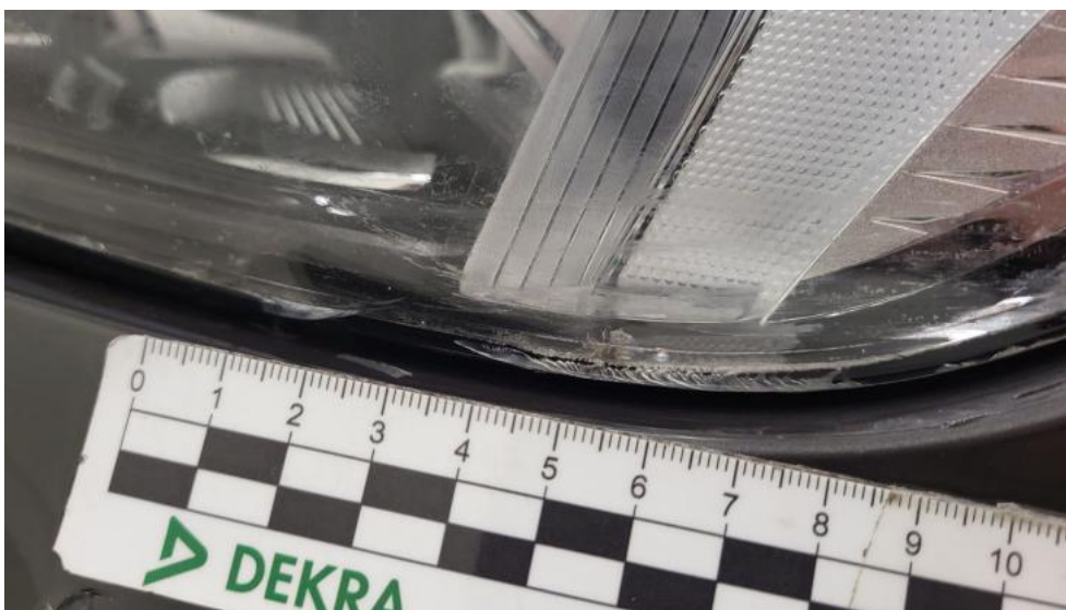
Fot. 55. Reflektor L - Pęknięcie/rozerwanie 1
