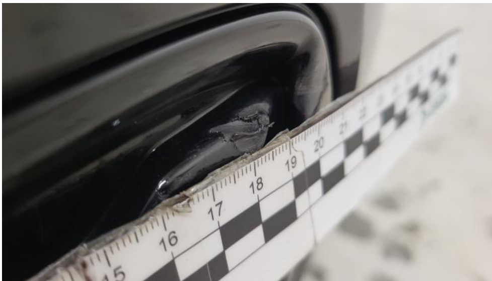
Fot. 41. Kratka/zaślepka halogenu L - Pęknięcie/rozerwanie 2
