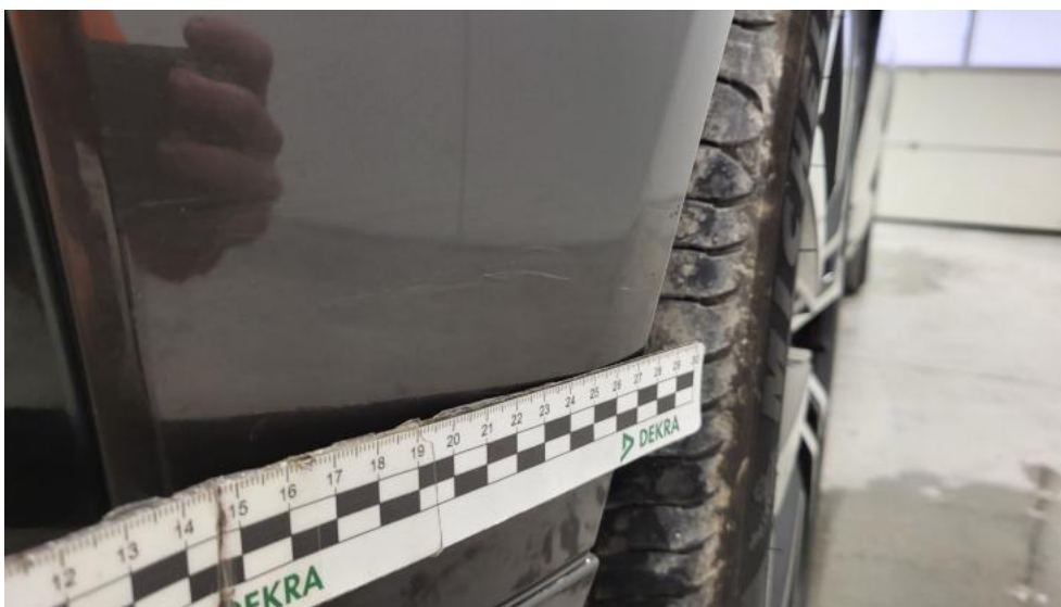
Fot. 43. Zderzak - Rysa/odprysk 2
