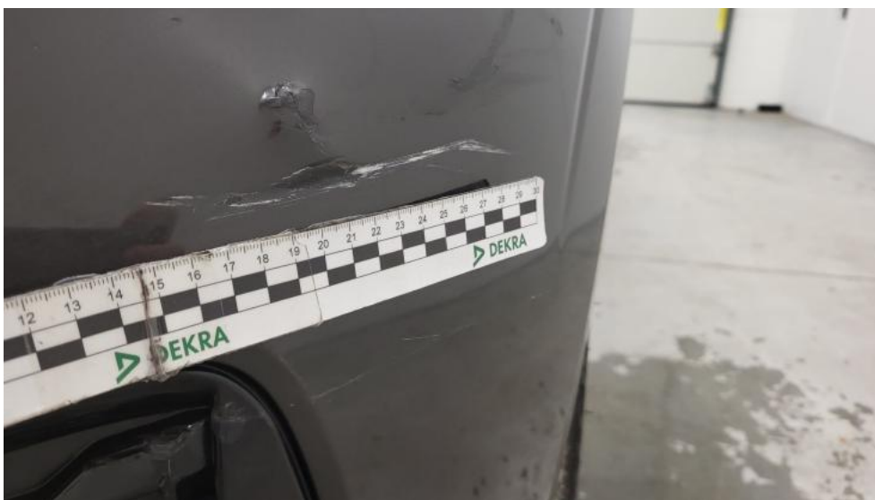
Fot. 42. Zderzak - Rysa/odprysk 1
