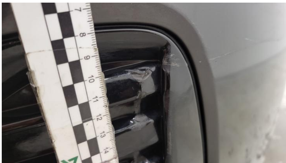
Fot. 39. Kratka/zaślepka halogenu L - Wgniecenie/odkształcenie 1
