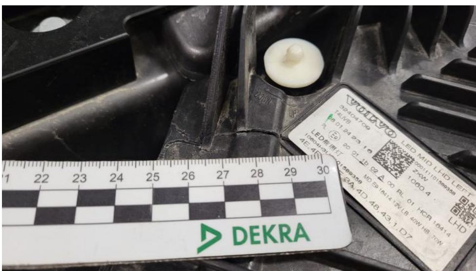
Fot. 56. Reflektor L - Pęknięcie/rozerwanie 2
