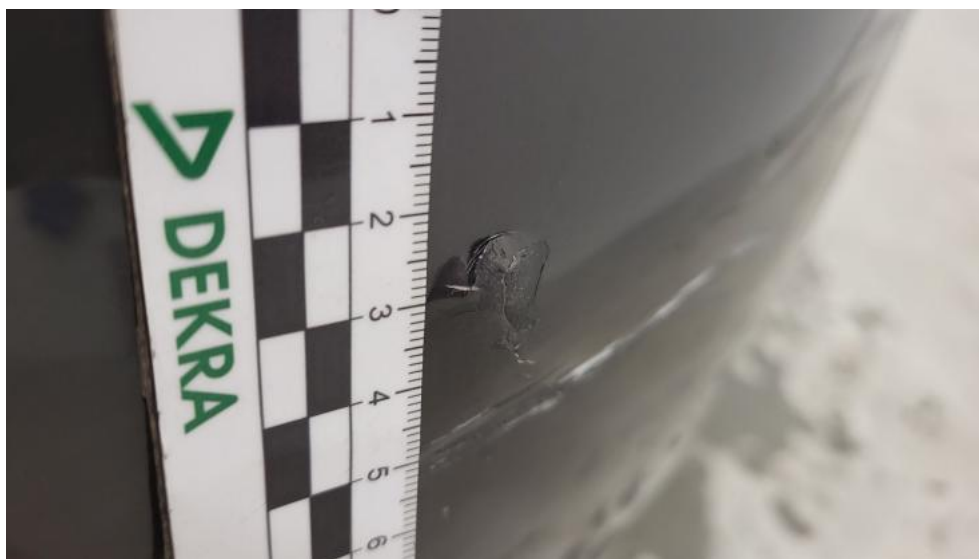
Fot. 45. Zderzak - Pęknięcie/rozerwanie 1
