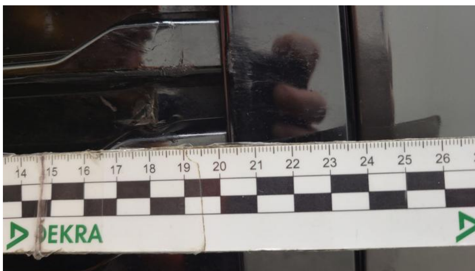
Fot. 40. Kratka/zaślepka halogenu L - Pęknięcie/rozerwanie 1
