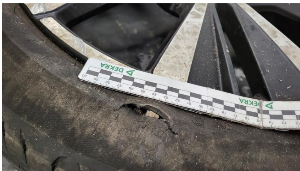
Fot. 48. Opona przednia P - Pęknięcie/rozerwanie 1
