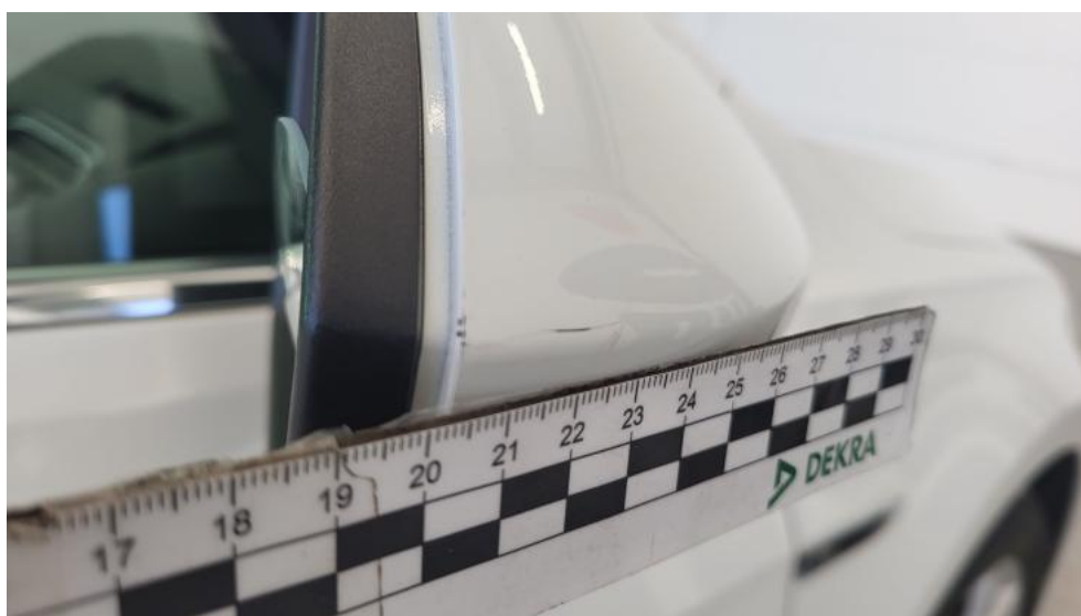
Photo 62. Lusterko zew P - Rysa/odprysk 1
