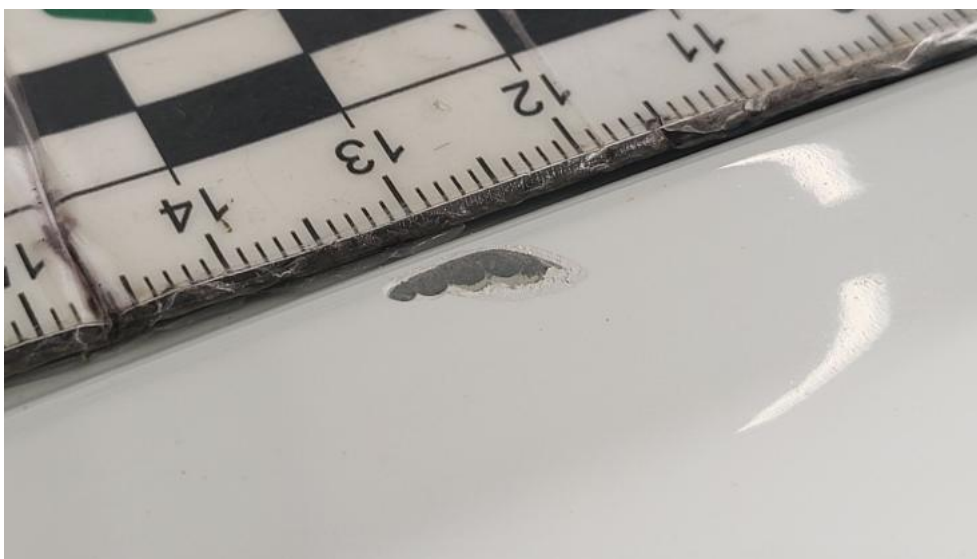
Photo 87. Stupek przedni L - Rysa/odprysk 2
