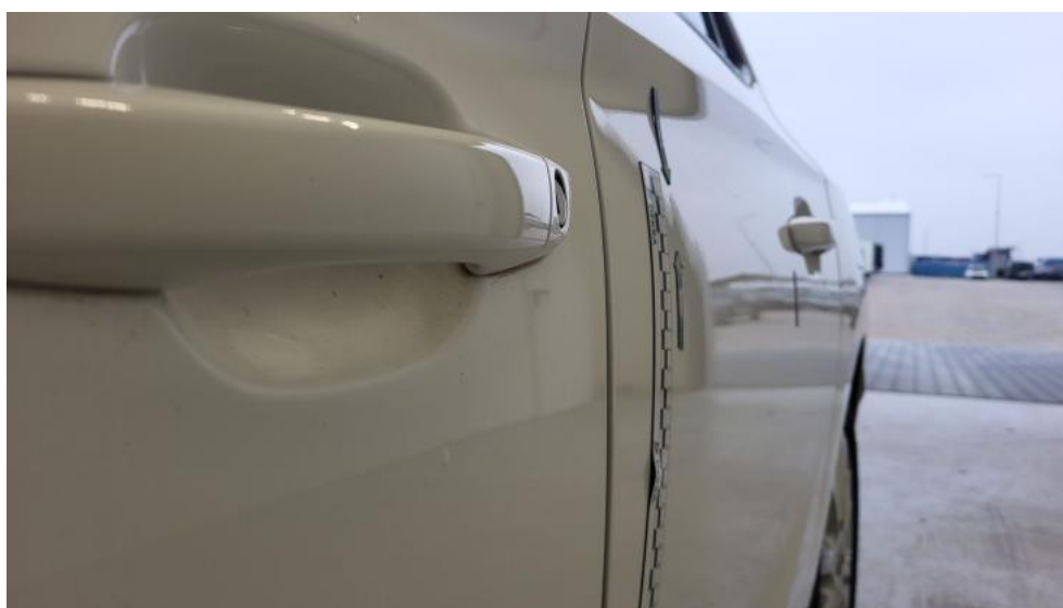
Fot. 56. Drzwi tylne L - Wgniecenie/odkształcenie 1
