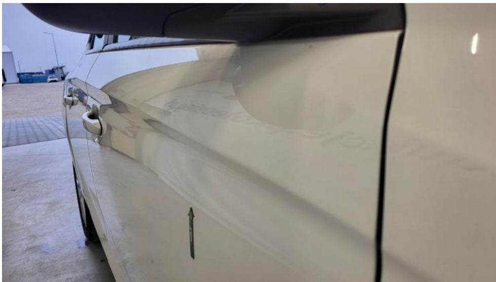
Fot. 49. Drzwi przednie P - Wgniecenie/odkształcenie 1
