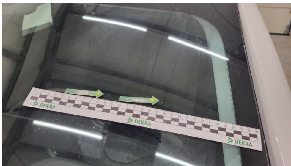
Fot. 42. Szyba czołowa - Rysa/odprysk 1
