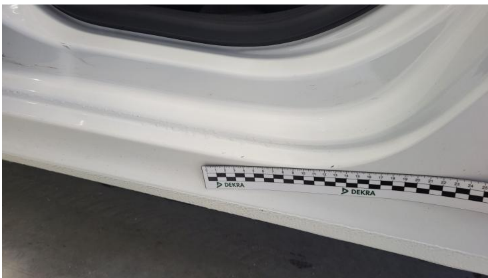
Fot. 58. Próg L - Rysa/odprysk 1
