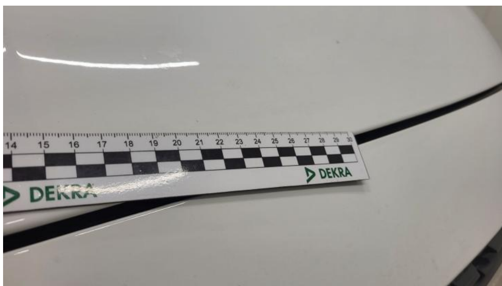
Fot. 40. Pokrywa komory silnika - Rysa/odprysk 2
