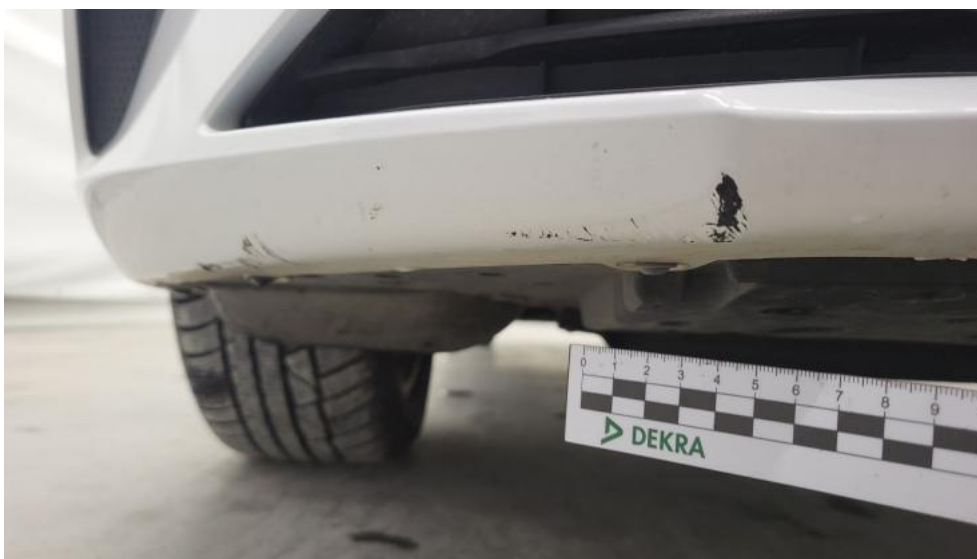
Fot. 47. Zderzak - Rysa/odprysk 2
