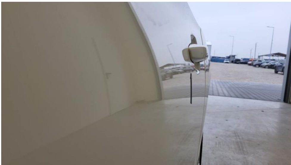
Fot. 57. Drzwi tylne L - Wgniecenie/odkształcenie 2
