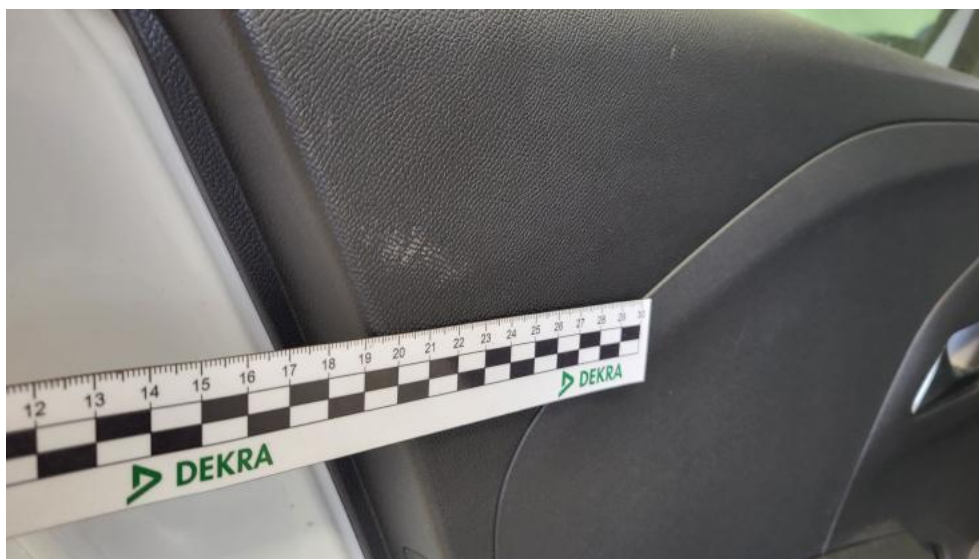
Fot. 65. Tapicerka drzwi tylnych L - Rysa/odprysk 1
