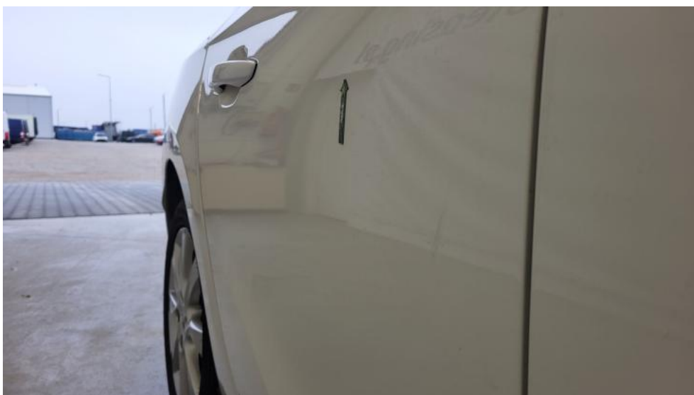
Fot. 50. Drzwi tylne P - Wgniecenie/odkształcenie 1
