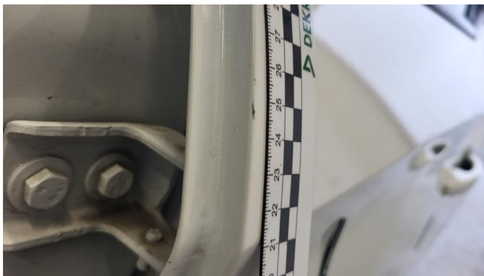
Fot. 55. Drzwi tylne L - Rysa/odprysk 1
