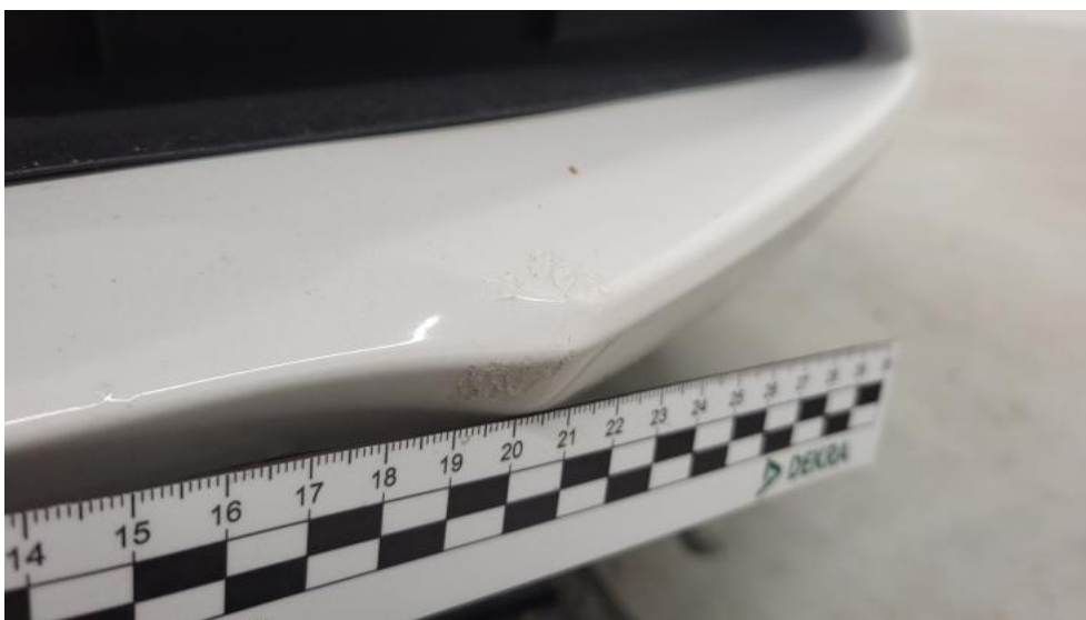
Fot. 46. Zderzak - Rysa/odprysk 1
