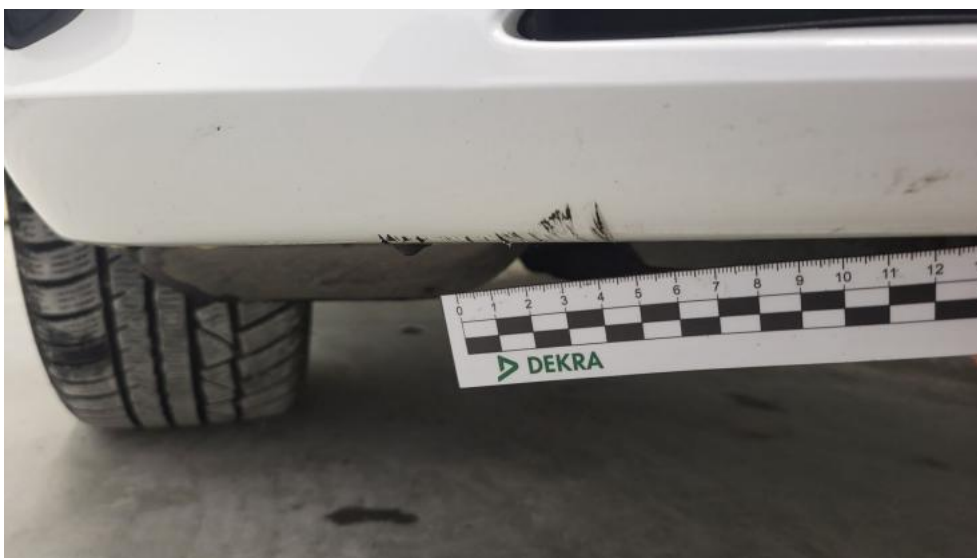
Fot. 48. Zderzak() - Rysa/odprysk 3
