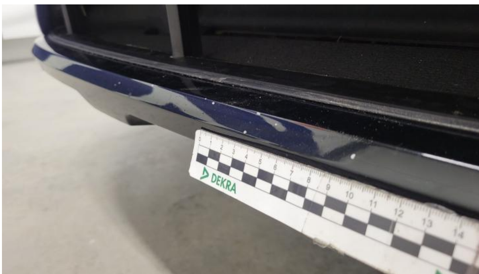
Fot. 57. Spoiler zderzaka przedniego - Rysa/odprysk 2
