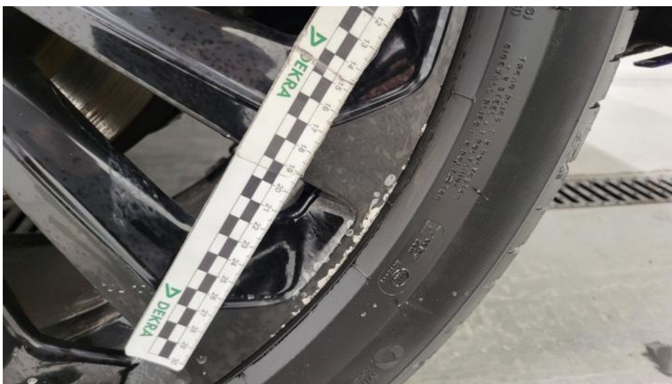
Fot. 67. Felga aluminiowa tylna L - Rysa/odprysk 1
