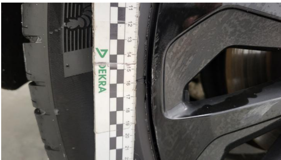
Fot. 66. Felga aluminiowa tylna P - Rysa/odprysk 1
