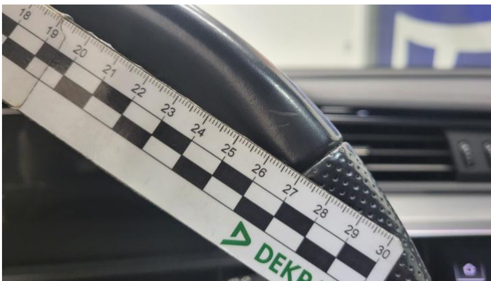
Fot. 69. Koło kierownicy - Rysa/odprysk 1
