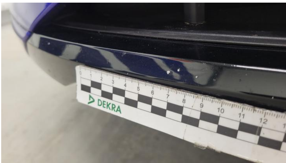
Fot. 58. Spoiler zderzaka przedniego() - Rysa/odprysk 3
