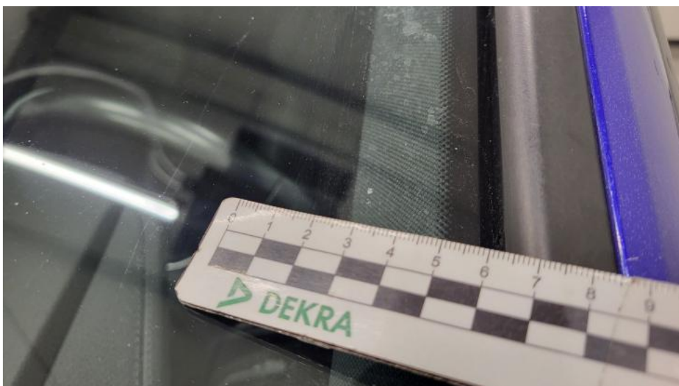
Fot. 60. Szyba czołowa - Rysa/odprysk 2
