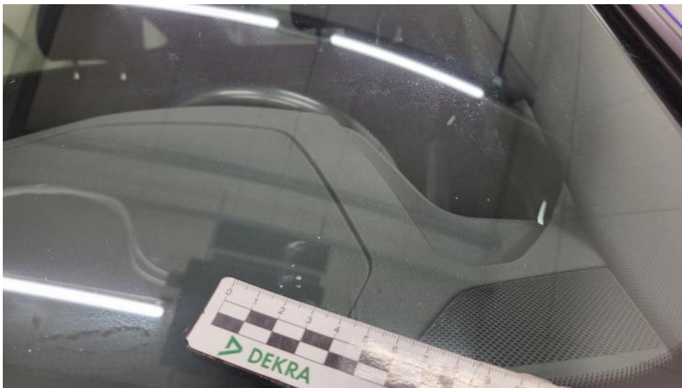
Fot. 59. Szyba czołowa - Rysa/odprysk 1
