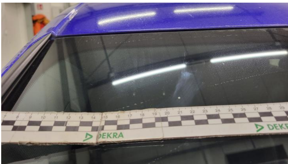
Fot. 61. Szyba czołowa() - Rysa/odprysk 3
