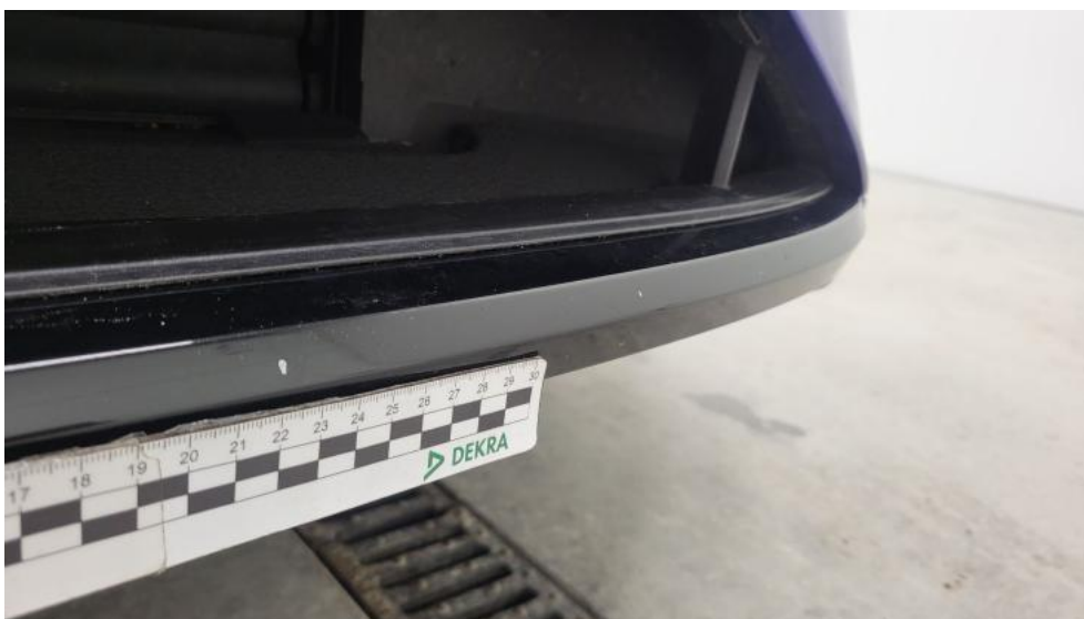
Fot. 56. Spoiler zderzaka przedniego - Rysa/odprysk 1
