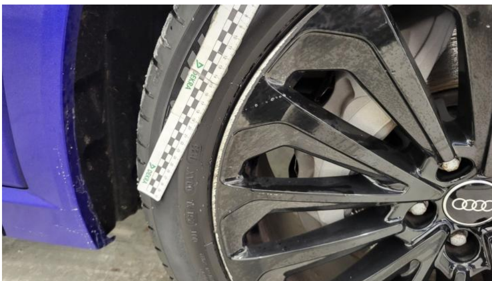
Fot. 62. Felga aluminiowa przednia P - Rysa/odprysk 1
