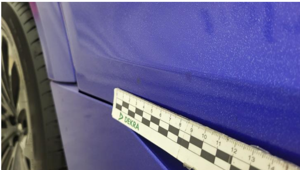
Fot. 63. Drzwi tylne P - Wgniecenie/odkształcenie 1
