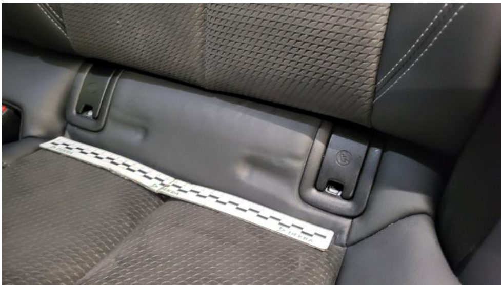
Fot. 71. Kanapa tyl. - Wgniecenie/odkształcenie 1
