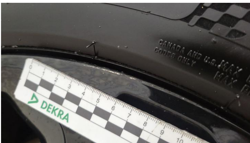
Fot. 68. Felga Aluminiowa przednia L - Rysa/odprysk 1
