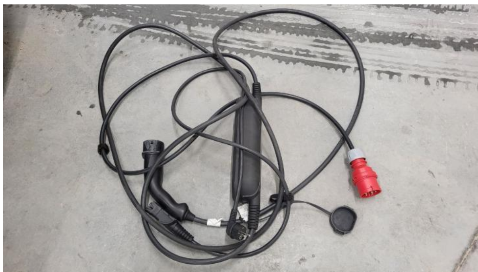
Fot. 36. Przewód ładowania baterii trakcyjnej
