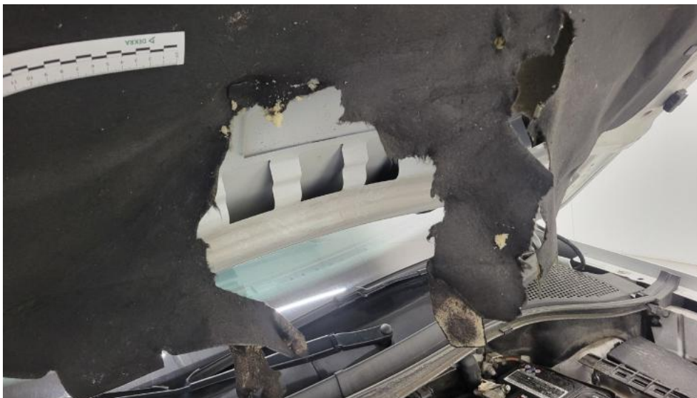
Fot. 49. Wykładzina pokrywy komory silnika - Pęknięcie/rozerwanie 1
