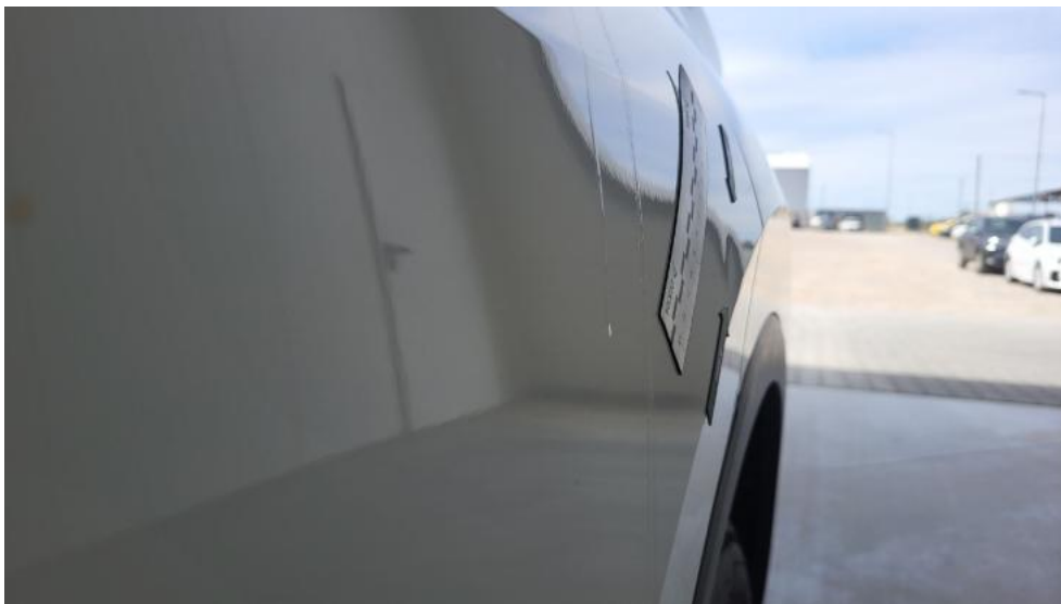
Fot. 73. Drzwi tylne L - Wgniecenie/odkształcenie 1
