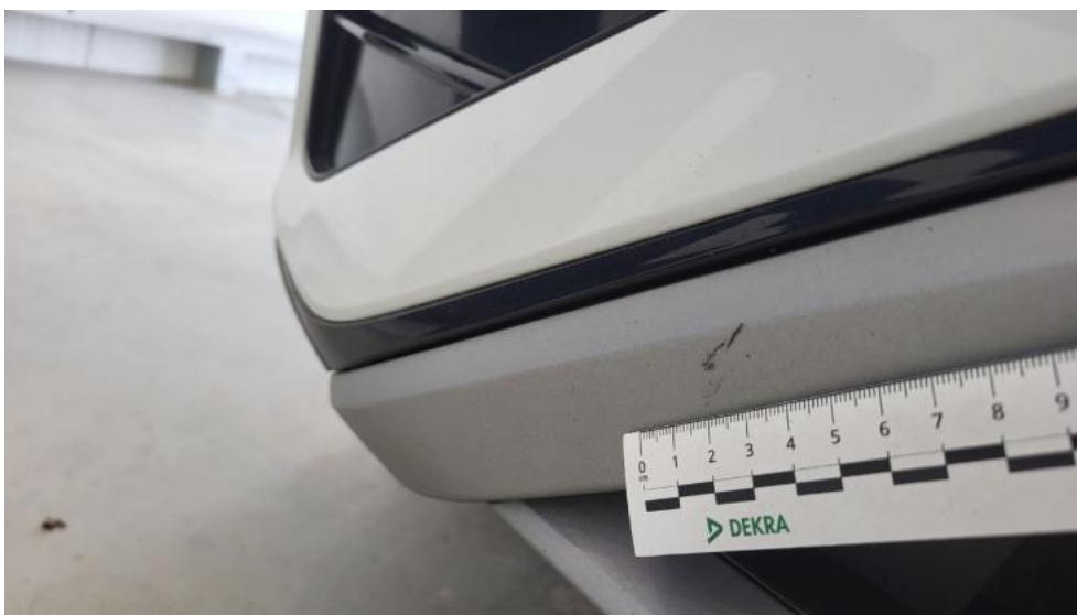
Fot. 52. Zderzak przedni cz dolna - Rysa/odprysk 1
