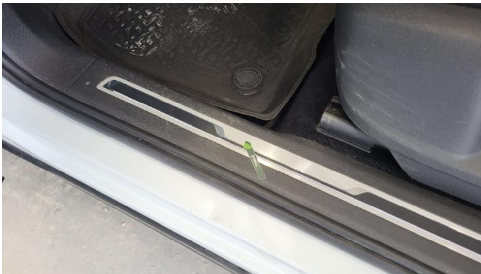
Fot. 85. Listwy progowe lew. - Wgniecenie/odkształcenie 1
