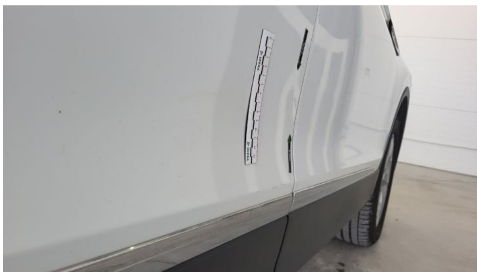
Fot. 56. Drzwi tylne P - Wgniecenie/odkształcenie 1
