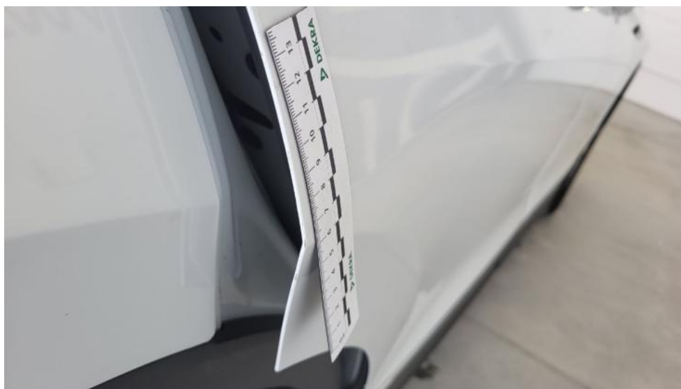
Fot. 55. Drzwi tylne P - Rysa/odprysk 1
