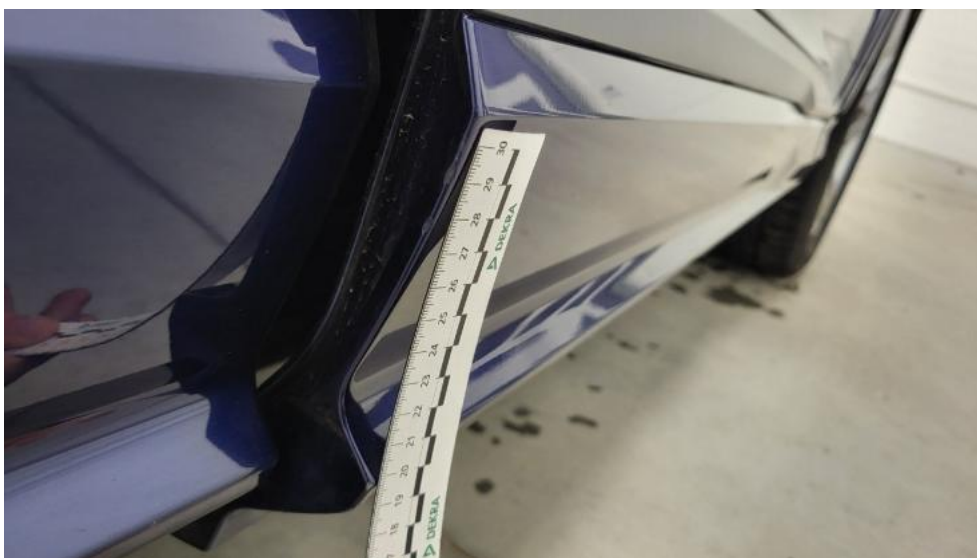
Fot. 70. Listwa drzwi przednich P - Rysa/odprysk 1
