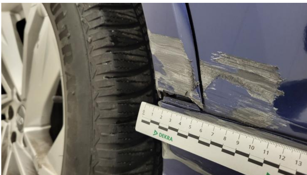
Fot. 79. Listwa krawędzi błotnika tył L - Pęknięcie/rozerwanie 1
