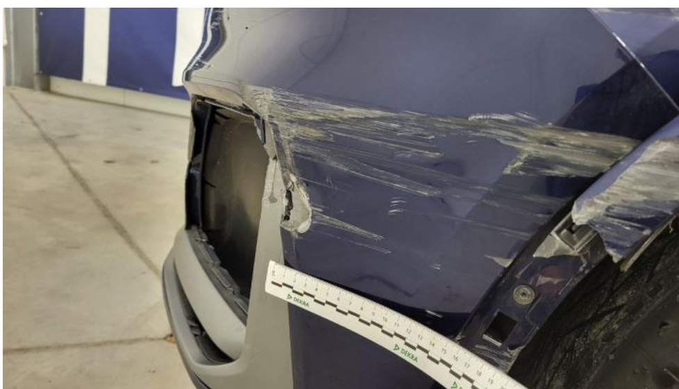
Fot. 64. Zderzak - Pęknięcie/rozerwanie 1
