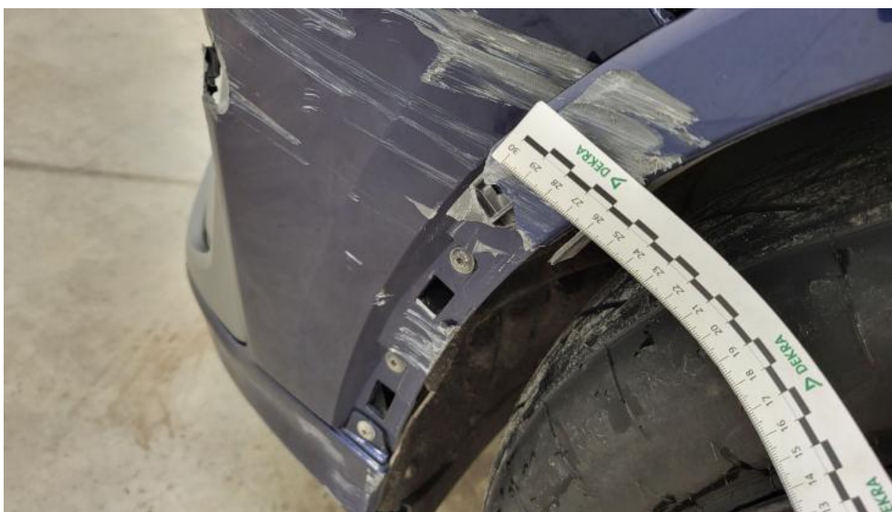
Fot. 87. Listwa błotnika przedniego L - Pęknięcie/rozerwanie 1
