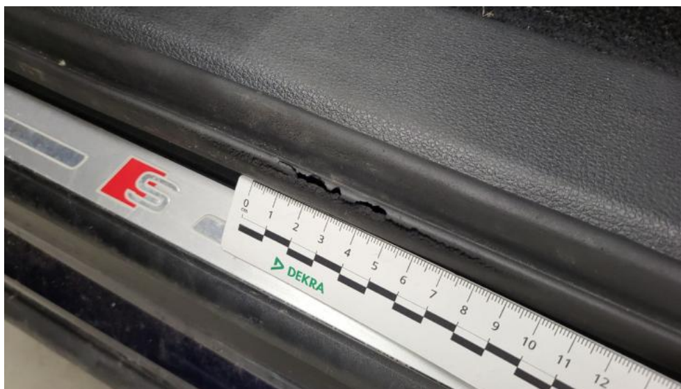
Fot. 91. Uszczelka drzwi przednich L - Pęknięcie/rozerwanie 1
