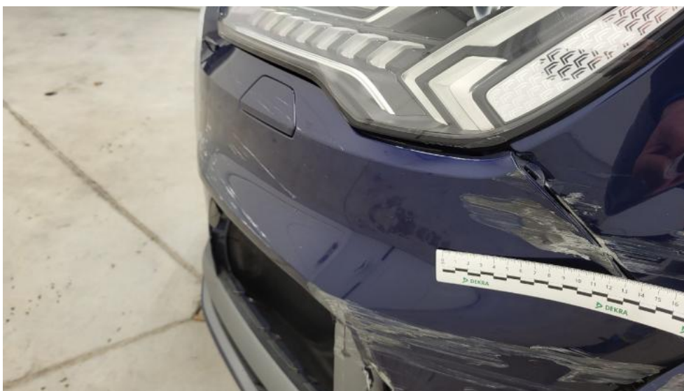
Fot. 63. Zderzak - Rysa/odprysk 2
