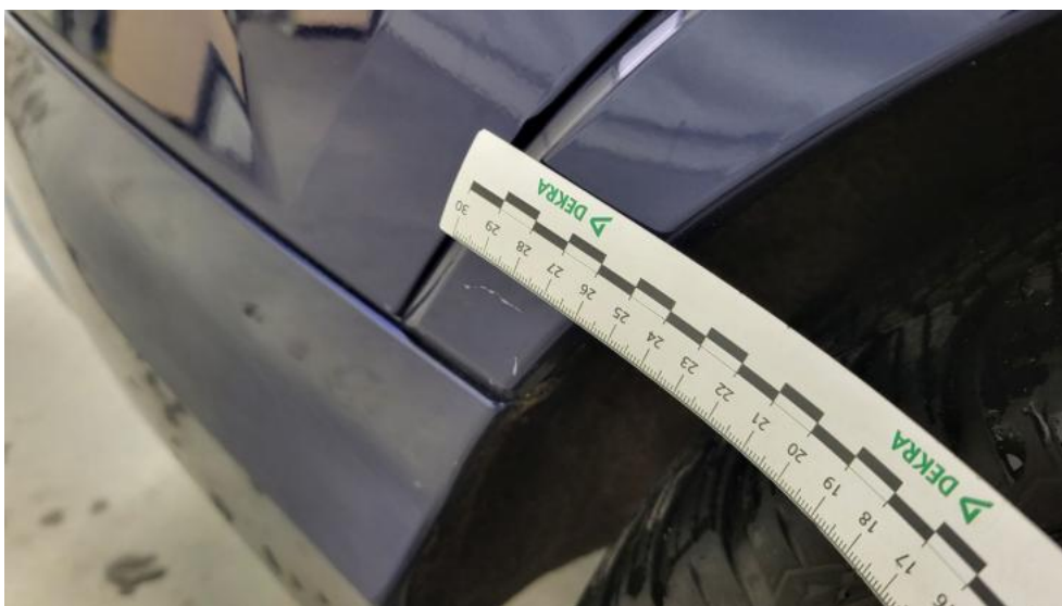
Fot. 74. Listwa krawędzi błotnika tyl P - Rysa/odprysk 1
