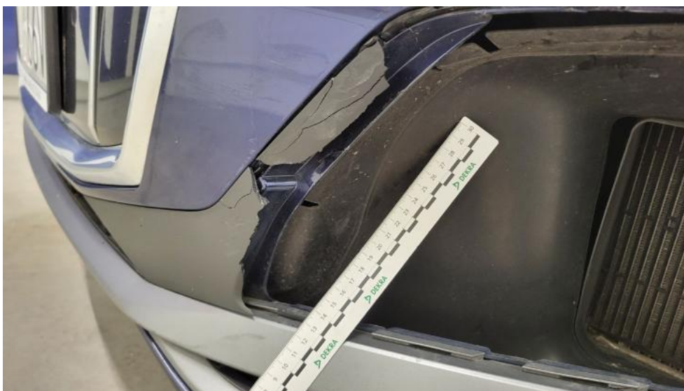
Fot. 59. Listwa śr zderzaka przedniego - Pęknięcie/rozerwanie 1
