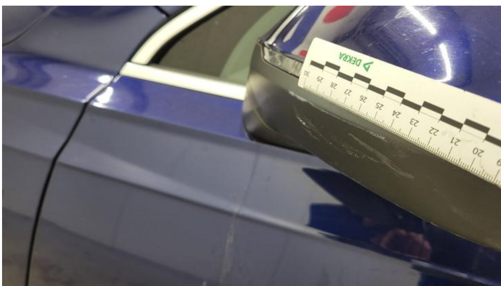
Fot. 84. Lusterko zew L - Rysa/odprysk 1
