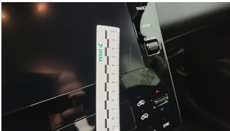
Fot. 59. Konsola środkowa - Rysa/odprysk 1
