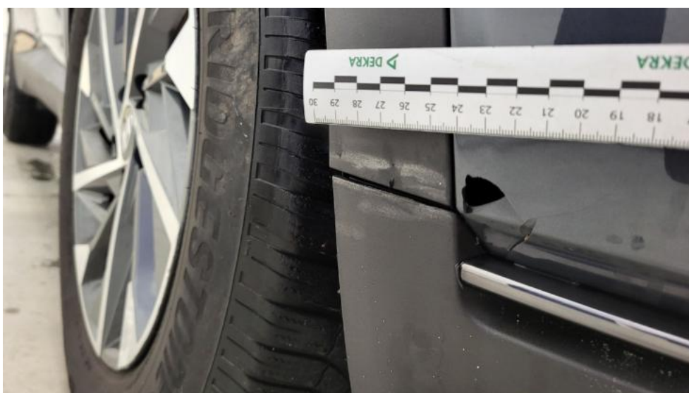
Fot. 44. Listwa błotnika przedniego P - Rysa/odprysk 1
