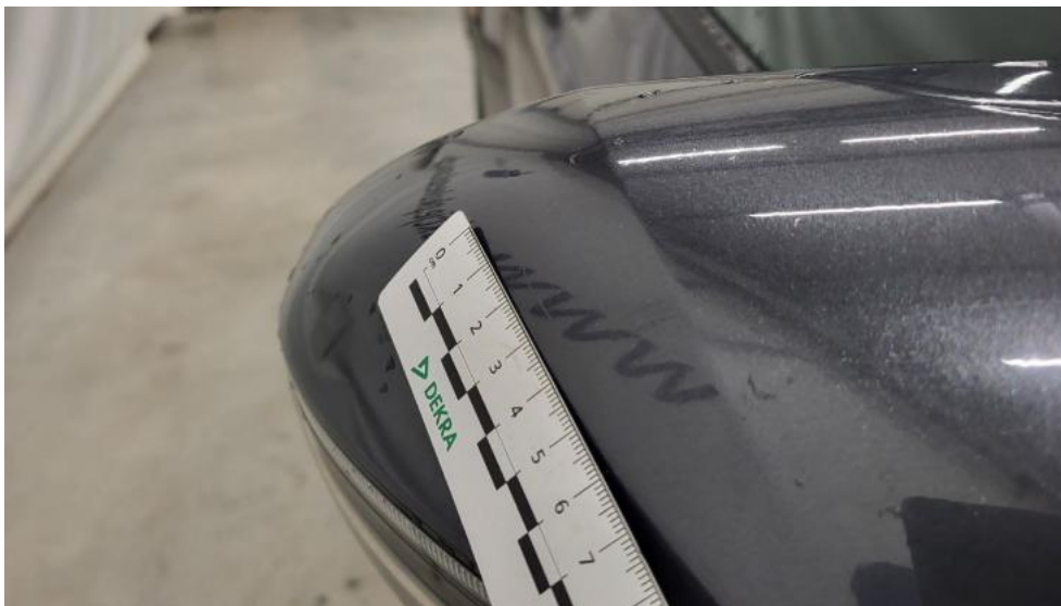
Fot. 47. Lusterko zew P - Rysa/odprysk 1
