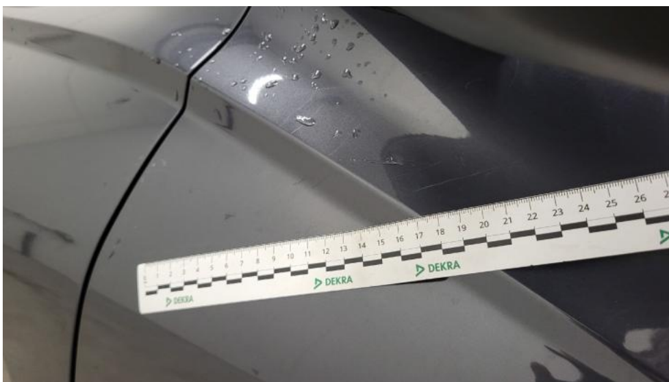
Fot. 52. Drzwi przed L - Rysa/odprysk 2
