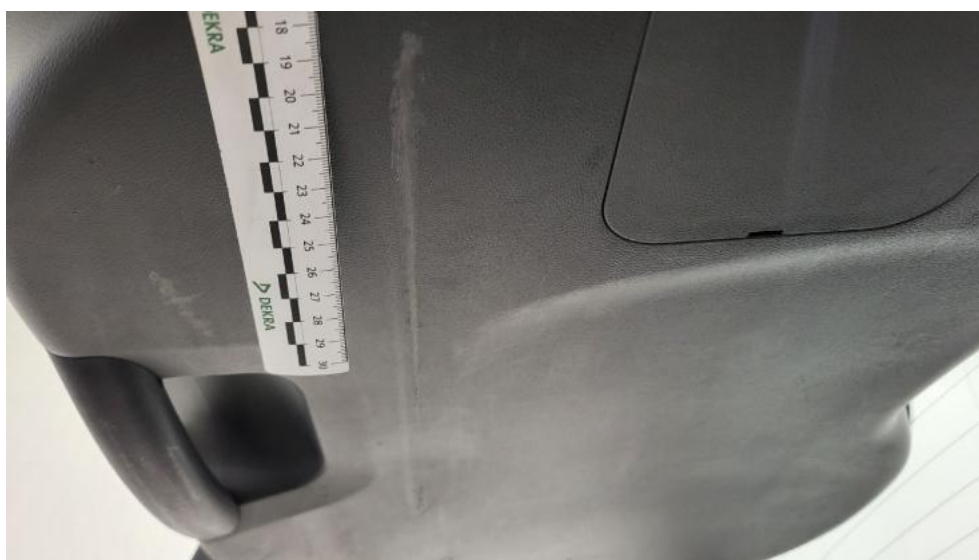
Fot. 64. Wykładzina pokrywy tylnej - Rysa/odprysk 1
