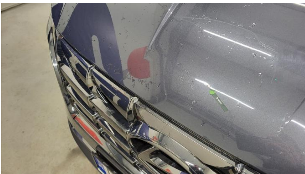
Fot. 39. Pokrywa komory silnika - Wgniecenie/odkształcenie 1
