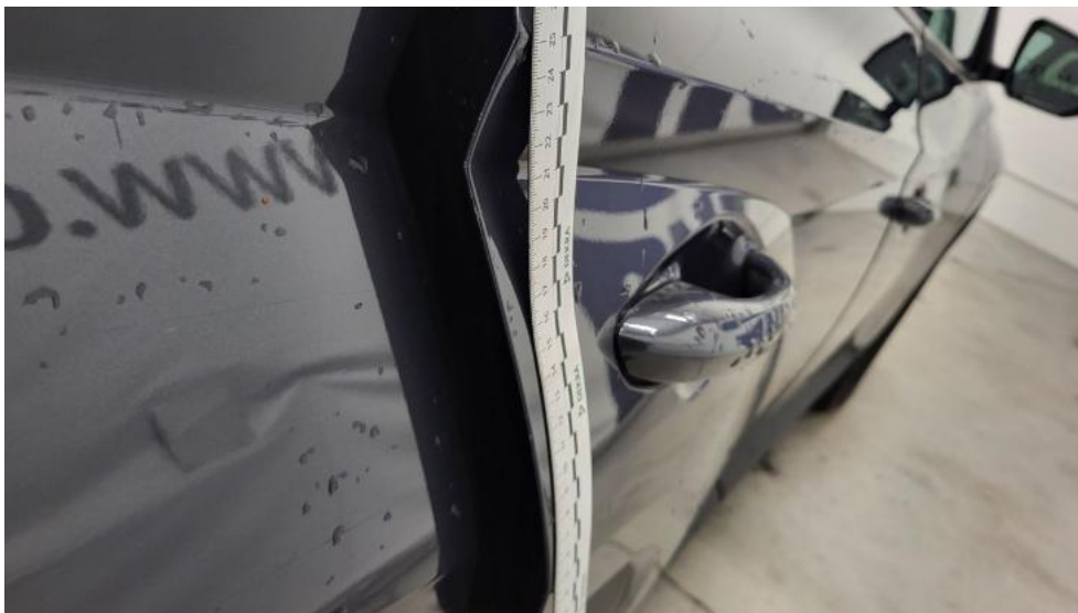
Fot. 45. Drzwi tylne P - Rysa/odprysk 1
