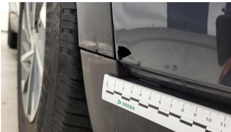
Fot. 43. Zderzak - Pęknięcie/rozerwanie 1
