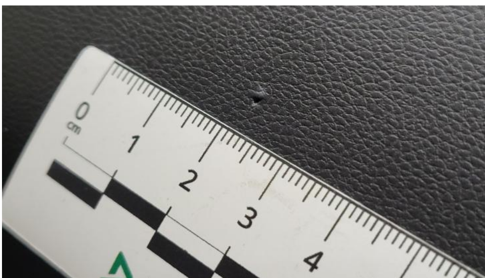
Fot. 58. Deska rozdzielcza - Pęknięcie/rozerwanie 1
