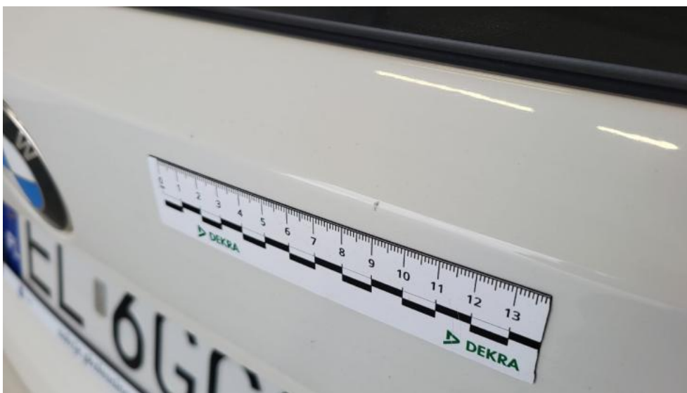
Fot. 49. Pokrywy bagażnika - Rysa/odprysk 1
