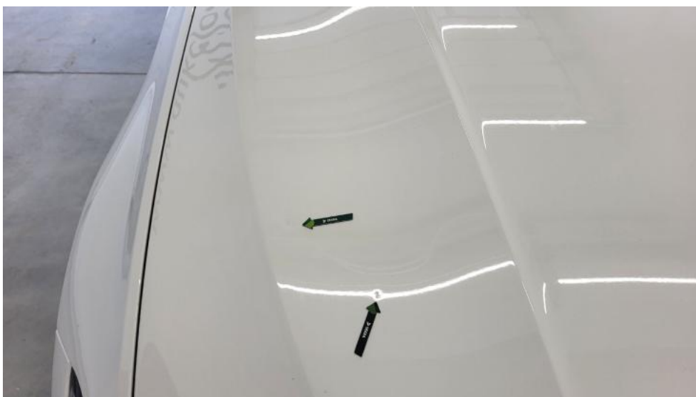
Fot. 38. Pokrywa komory silnika - Wgniecenie/odkształcenie 1
