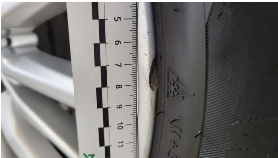
Fot. 41. Felga aluminiowa przednia P - Rysa/odprysk 1
