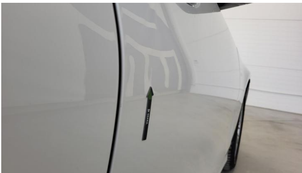
Fot. 43. Drzwi przednie P - Wgniecenie/odkształcenie 1
