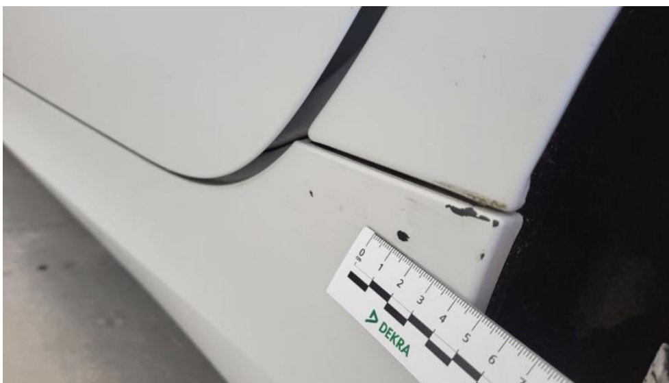
Fot. 57. Próg L - Rysa/odprysk 1
