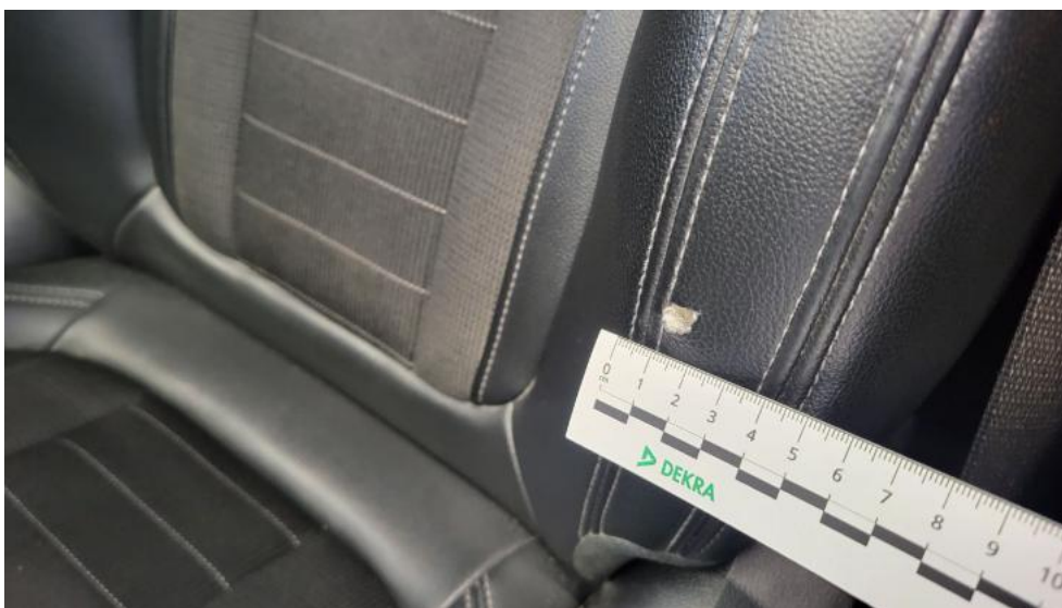
Fot. 59. Fotel prz. lew. - Pęknięcie/rozerwanie 1
