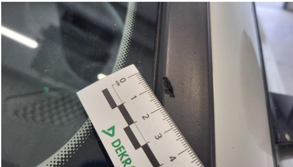
Fot. 39. Uszczelka/listwa szyby czołowej - Rysa/odprysk 1
