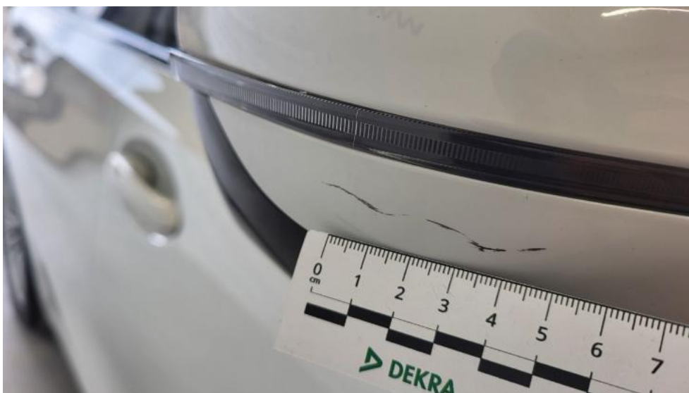
Fot. 46. Lusterko zew P - Rysa/odprysk 1
