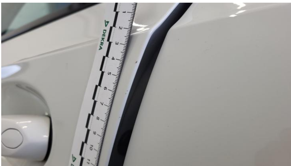
Fot. 53. Drzwi przed L - Rysa/odprysk 1
