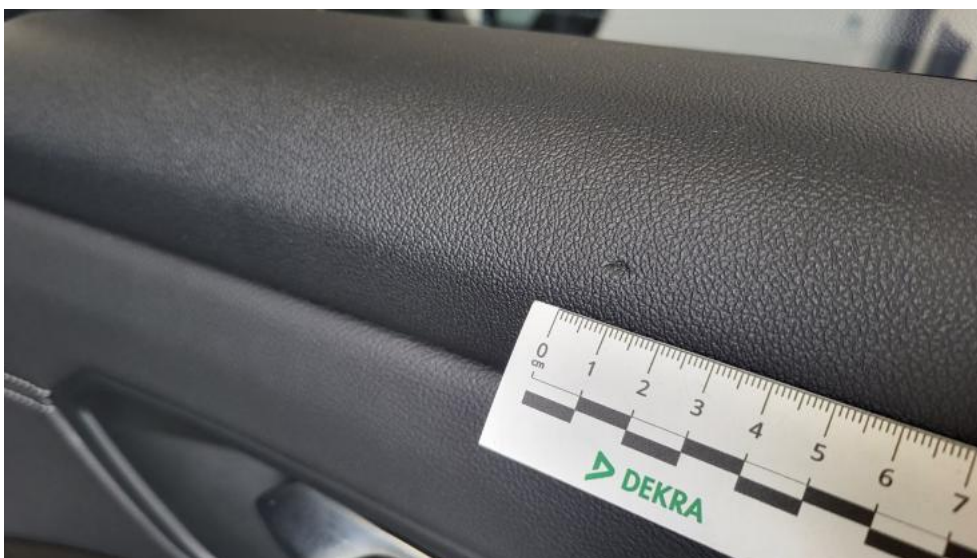
Fot. 64. Tapicerka drzwi tylnych P - Wgniecenie/odkształcenie 1
