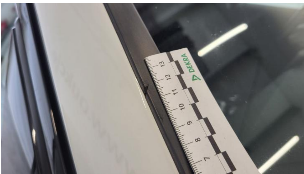
Fot. 40. Uszczelka/listwa szyby czołowej - Rysa/odprysk 2
