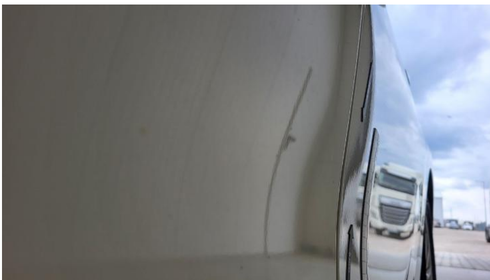
Fot. 56. Drzwi tylne L - Wgniecenie/odkształcenie 1
