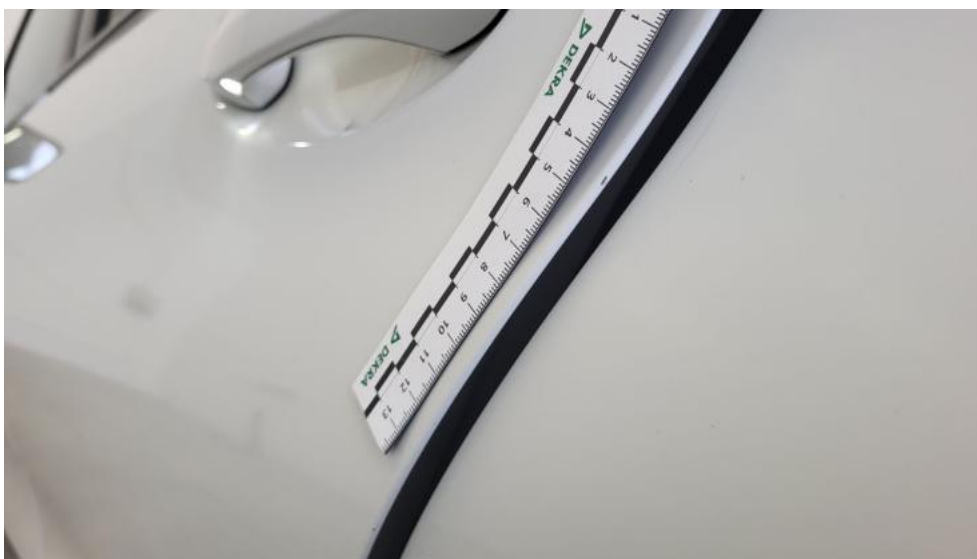
Fot. 55. Drzwi tylne L - Rysa/odprysk 1
