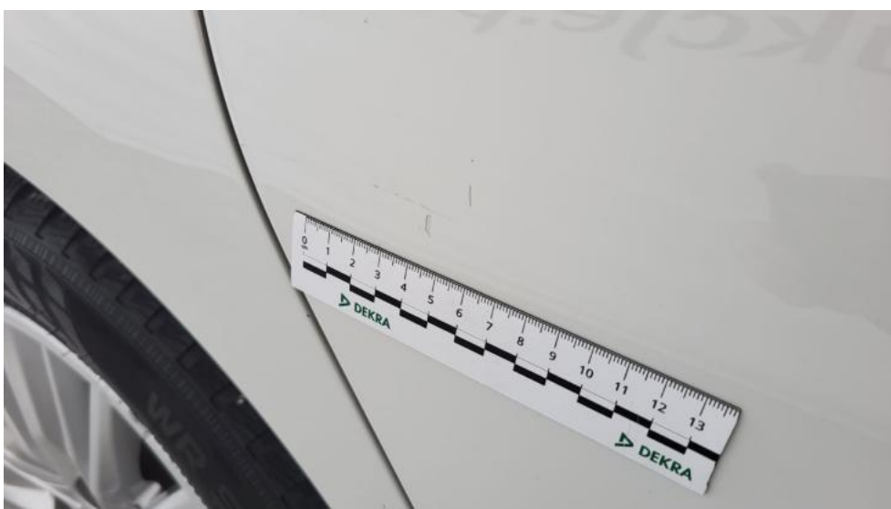
Fot. 44. Drzwi tylne P - Rysa/odprysk 1
