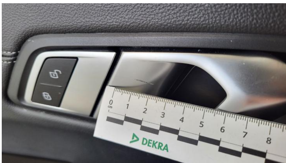
Fot. 66. Uchwyt drzwi prze L - Rysa/odprysk 1
