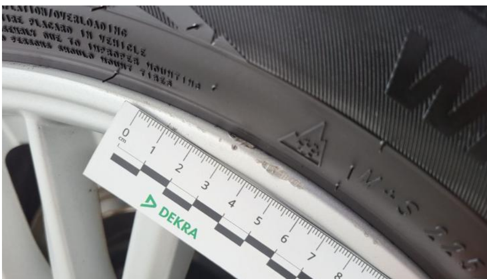
Fot. 48. Felga aluminiowa tylna P - Rysa/odprysk 1
