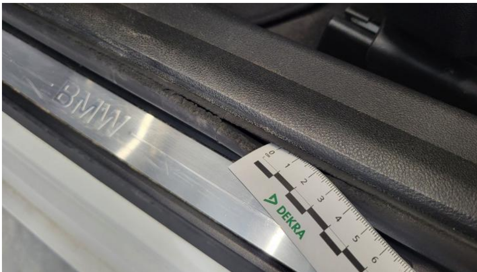
Fot. 67. Uszczelka drzwi przednich L - Pęknięcie/rozerwanie 1
