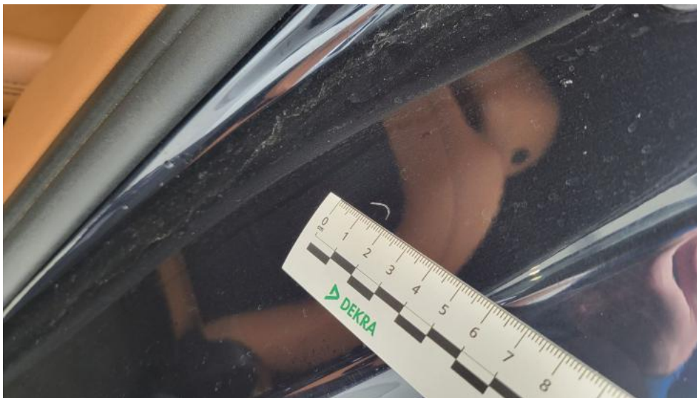
Fot. 53. Błotnik tylny L / Ściana boczna L - Rysa/odprysk 1
