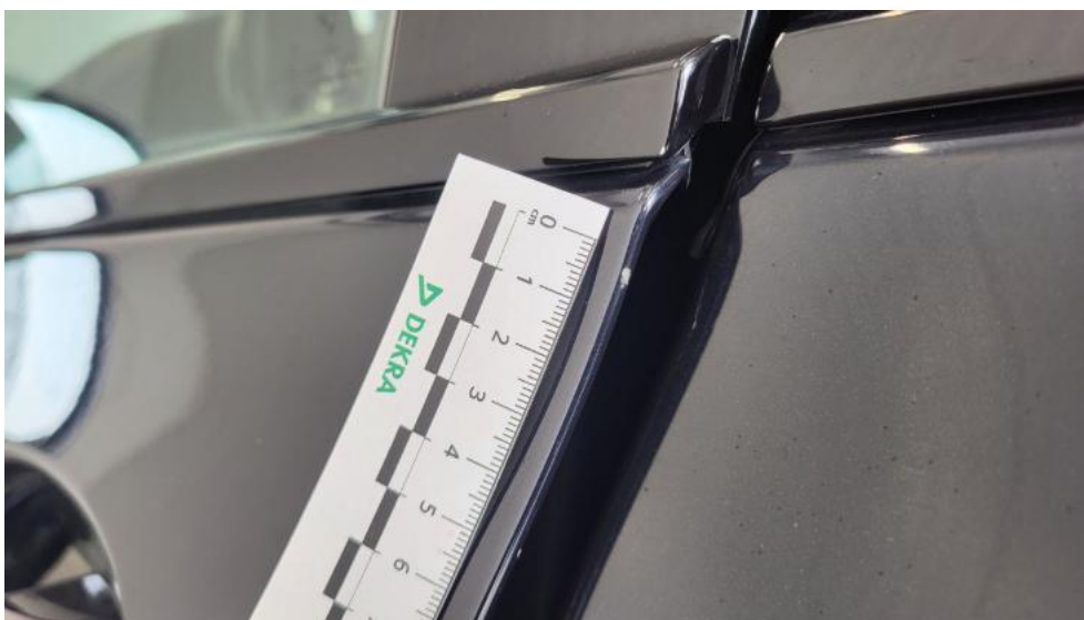
Fot. 55. Drzwi przed L - Rysa/odprysk 1
