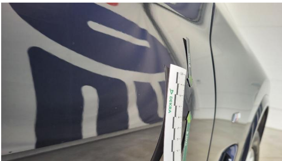
Fot. 45. Drzwi przednie P - Wgniecenie/odkształcenie 1
