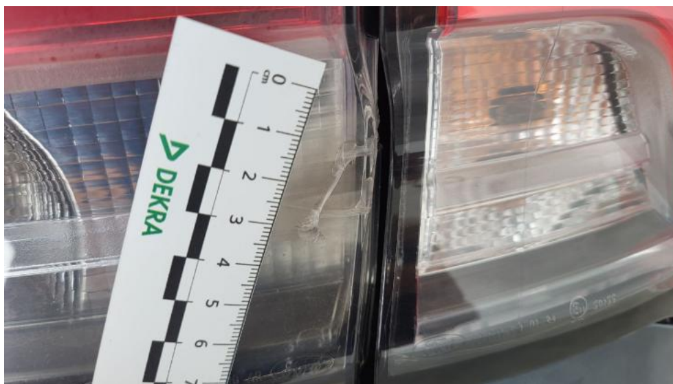
Photo 41. Lampa tylna wew P - Pęknięcie/rozerwanie 1
