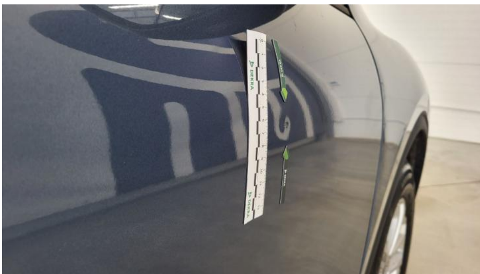
Photo 39. Drzwi przednie P - Wgniecenie/odkształcenie 1
