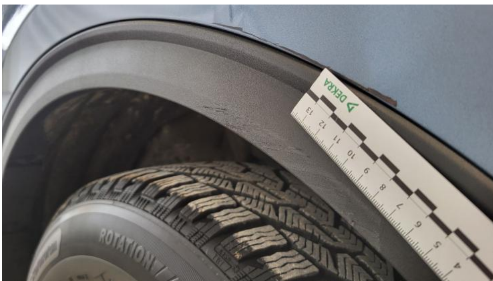
Photo 38. Listwa krawędzi błotnika prz P - Rysa/odprysk 1
