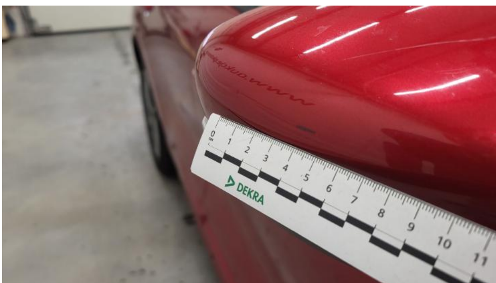
Fot. 42. Lusterko zew P - Rysa/odprysk 1
