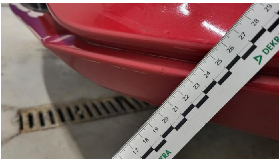
Fot. 40. Zderzak - Rysa/odprysk 1
