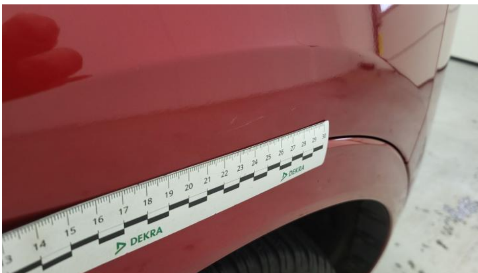
Fot. 46. Błotnik tylny L / Ściana boczna L - Rysa/odprysk 1
