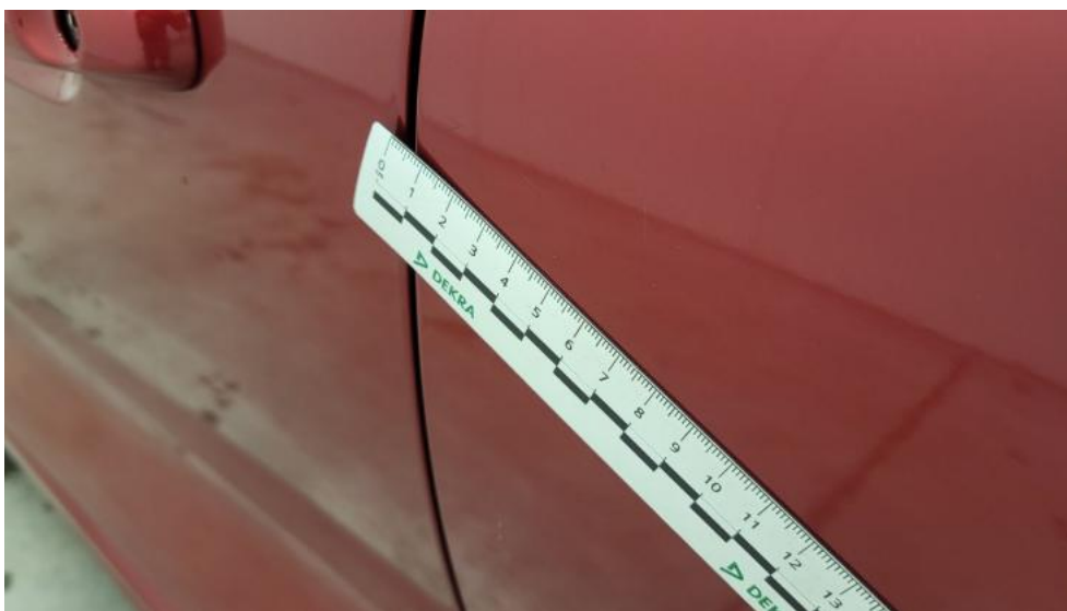
Fot. 49. Drzwi tylne L - Rysa/odprysk 1
