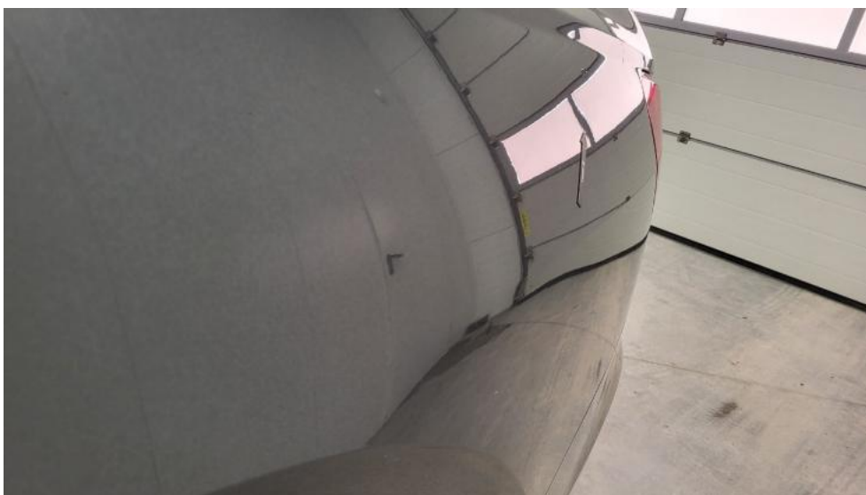
Photo 56. Błotnik tylny L / Ściana boczna L - Wgniecenie/odkształcenie 1
