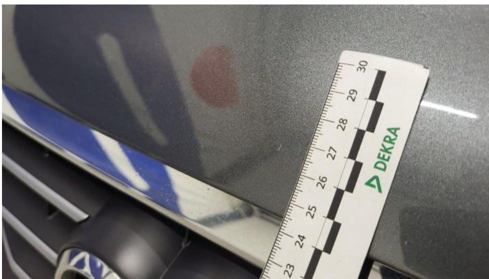
Photo 46. Pokrywa komory silnika - Rysa/odprysk 1
