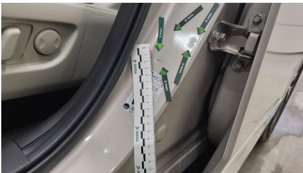
Fot. 57. Stupek środkowy L - Wgniecenie/odkształcenie 1
