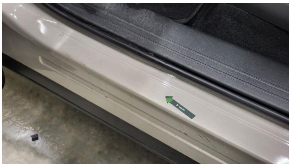
Fot. 56. Próg L - Wgniecenie/odkształcenie 1
