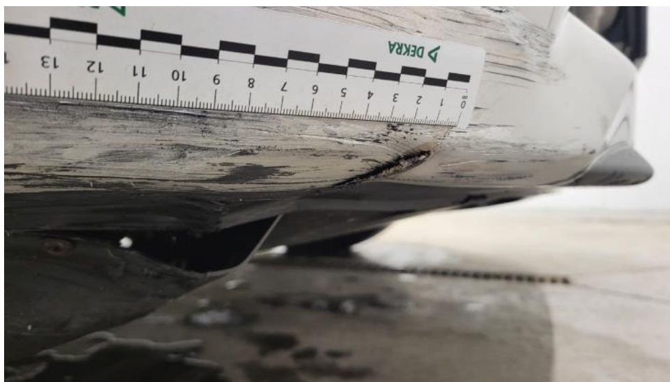
Fot. 44. Zderzak - Pęknięcie/rozerwanie 1
