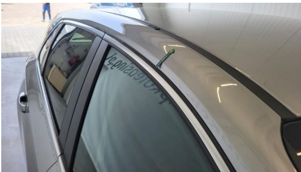
Fot. 48. Słupek przedni P - Wgniecenie/odkształcenie 1
