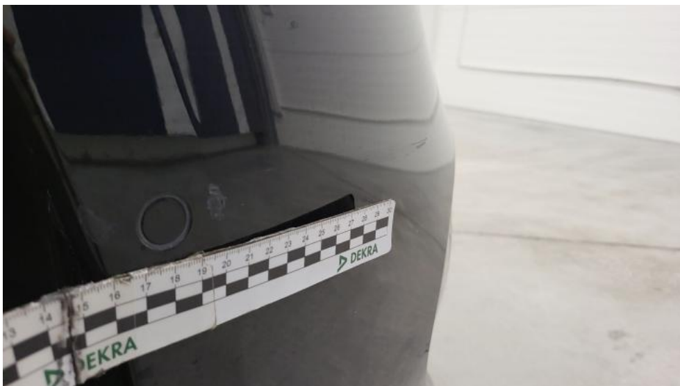
Fot. 48. Zderzak - Rysa/odprysk 1
