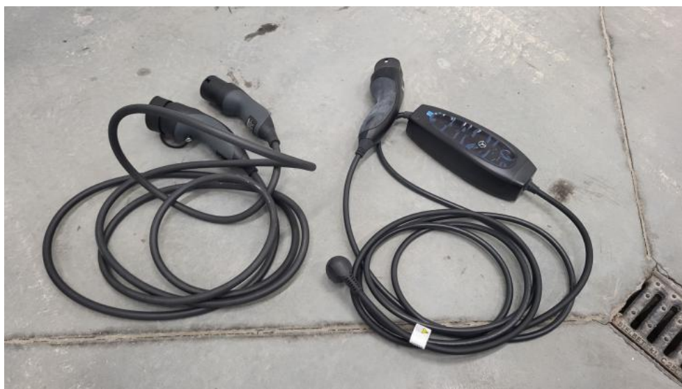
Fot. 34. Przewód ładowania baterii trakcyjnej
