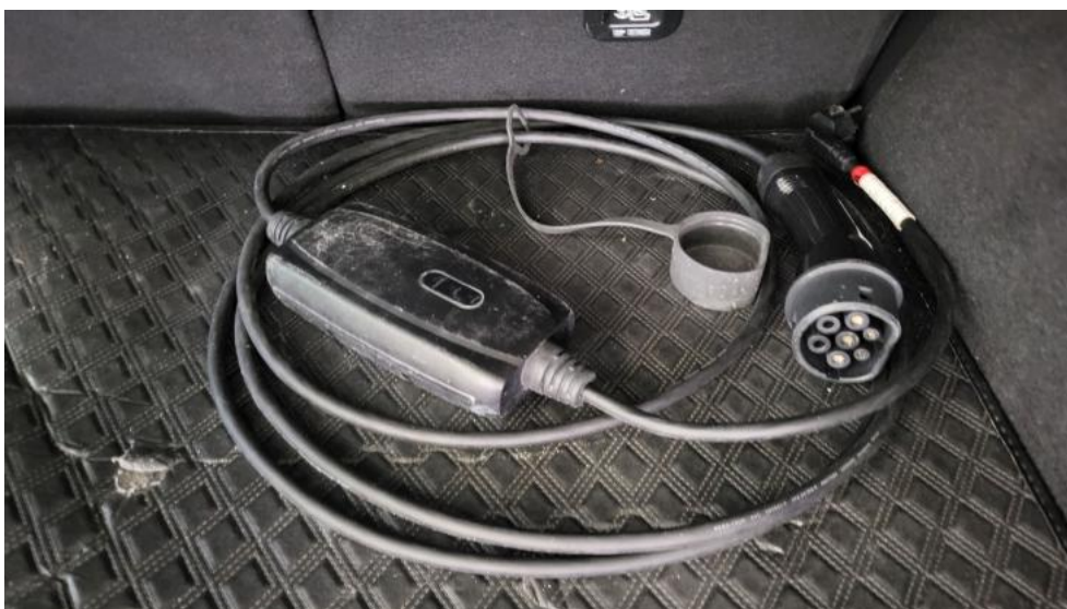
Photo 32. Przewód ładowania baterii trakcyjnej
