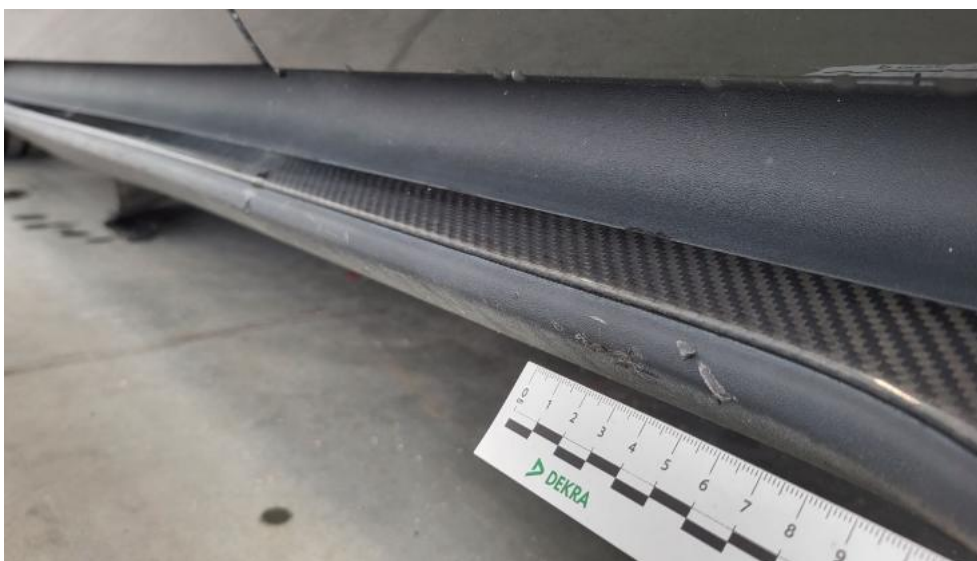
Fot. 89. Próg L - Rysa/odprysk 1
