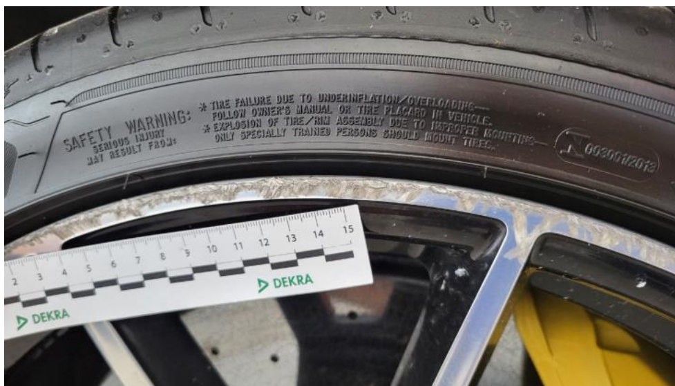
Fot. 70. Felga aluminiowa przednia P - Rysa/odprysk 1
