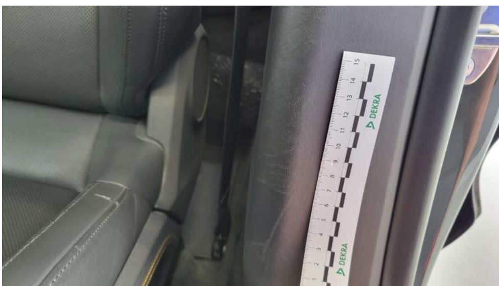
Fot. 98. Wykładzina(y) słupka środkowego L - Rysa/odprysk 1
